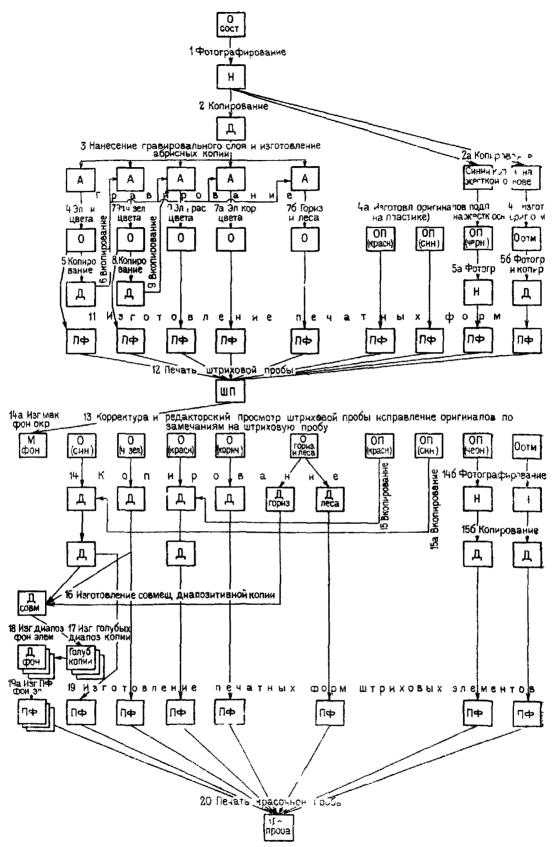
Условные обозначения О-оригинал, А-абрис, Н-негатив, Д-диапозитив, М-макет, ПФ-гечатная форма, ШП-штриховая проба, ОП-оригинал годписеи Оотм-оригинал отмывки рельефа
