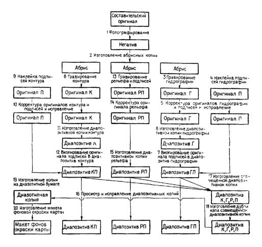
Условные обозначения А-абрис, К-контур, Г-гидрография, П-подписи, Р-рельеф
