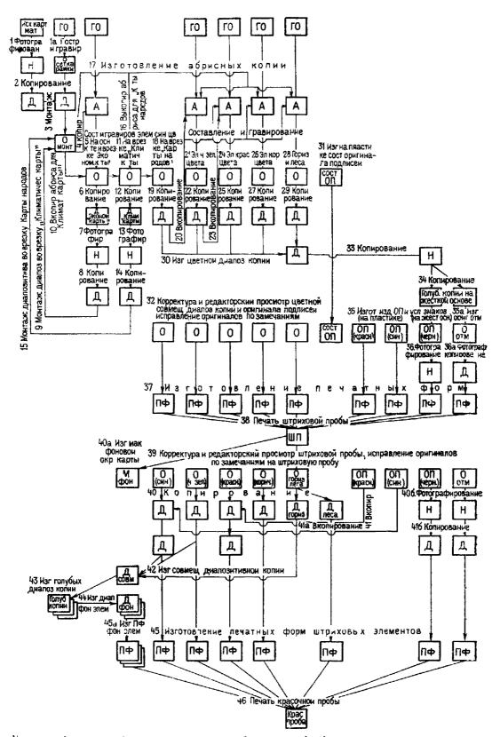
Условные обозначения ГО гравировальная основа О-оригинал, А-абрис Н-негатив, Д-диапозитив, М макет, ПФ-печатная форма, ШП-штриховая проба, ОП-оригинал подлисей, О отм-оригинал отмывки рельефа
