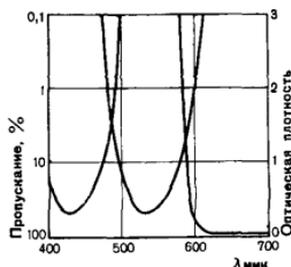
5.3.7. Очки-светофильтры для контроля качества изготовления многоцветных оригиналов фоновых и штриховых элементов космофотокарт. Их спектральная характеристика должна соответствовать спектральной характеристике цветоделительных светофильтров.
