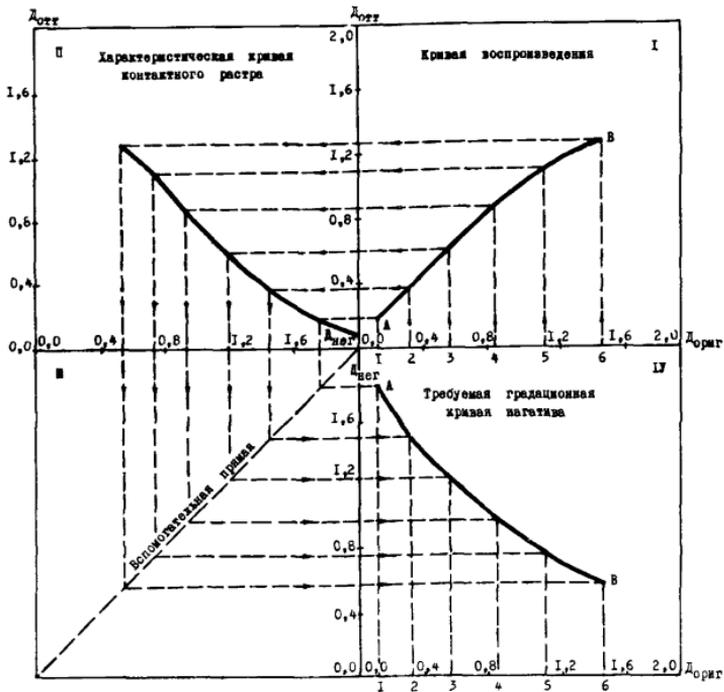
Рис. I. Определение требуемой градационной кривой полутонного негатива
