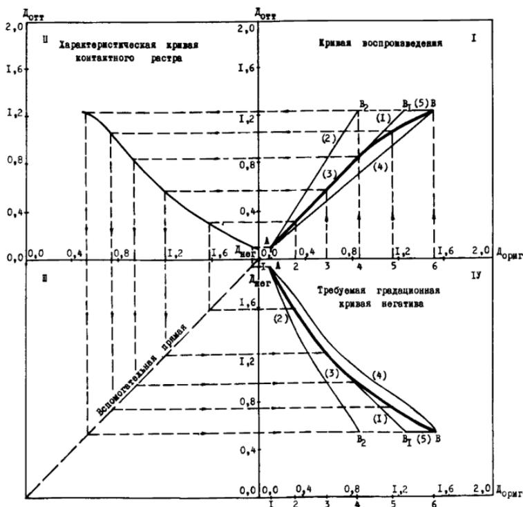
Рис.5. Определение требуемой градационной кривой цветоделенных полутоновых негативов
