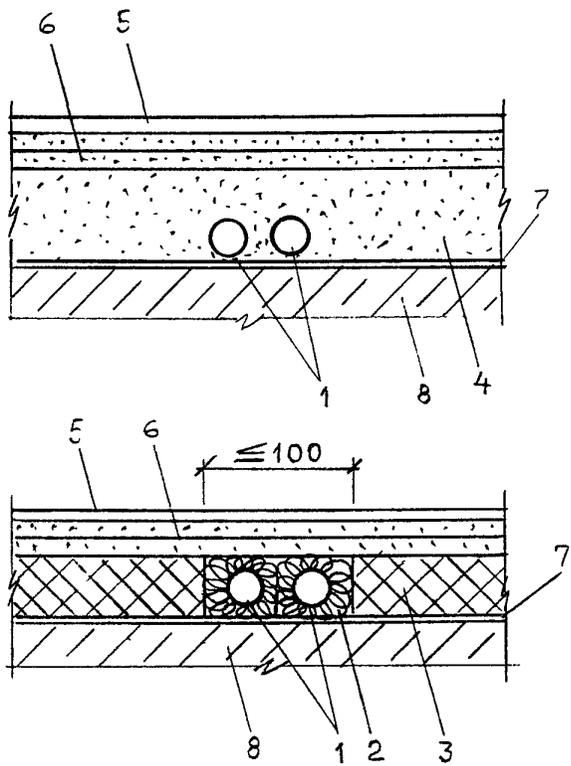
1 — труба; 2 — минеральная вата; 3 — плиты пенополистирольные; 4 — засыпка из керамзитового песка;
