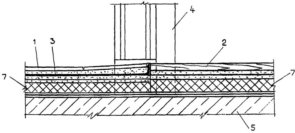
1 — пол из керамической плитки, 2 — пол из штучного паркета; 3 — гидроизоляция; 4 — дверная коробка, 5 — несущая плита перекрытия; 6 — сборная стяжка; 7 — подстилающий слой.
