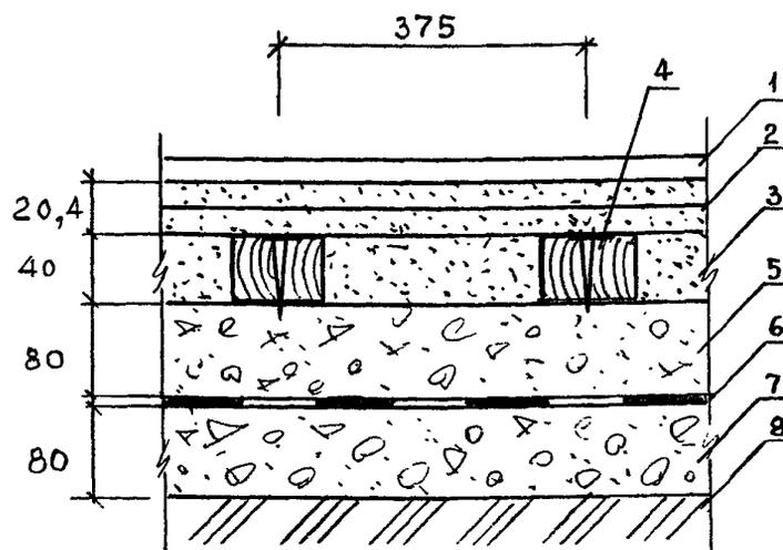
1 — покрытие пола; 2 — сборная стяжка из готовых элементов пола; 3 — засыпка из керамзитового гравия; 4 — лаги самонивелирующиеся; 5 — подстилающий слой из бетона М 150 с затертой поверхностью; 6 — два слоя гидростеклоизола; 7 — бетон М 150; 8 — щебень (гравий) крупностью 40-60 мм, втрамбованный в грунт основания.
