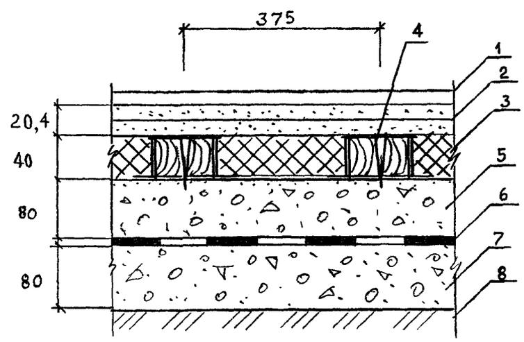
1 — покрытие пола; 2 — сборная стяжка из готовых элементов пола; 3 — плиты пенополистирольные; 4 — лаги самонивелирующиеся; 5 — подстилающий слой из бетона М 150 с затертой поверхностью; 6 — два слоя гидростеклоизола; 7 — бетон М 150; 8 — щебень (гравий) крупностью 40-60 мм, втрамбованный в грунт основания.
