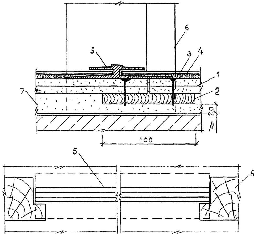
1 — сборная стяжка; 2 — опора из древесностружечной плиты под прямой стык из ГВЛ в дверном проеме; 3 — шуруп 45 мм для ГВЛ; 4 — покрытие пола из рулонных материалов; 5 — порожек поливинилхлоридный; 6 — дверная коробка; 7 — подстилающий слой.
