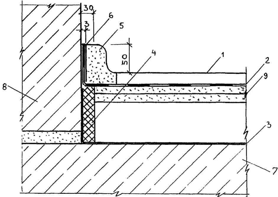
1 — пол из керамических плиток; 2 — гидроизоляция; 3 — пленка полиэтиленовая;
