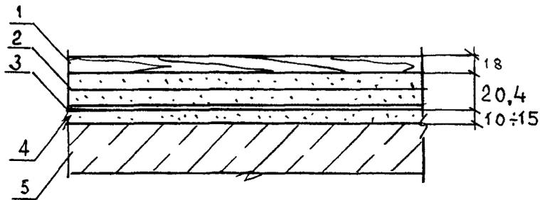
1 — покрытие пола; 2 — сборная стяжка из готовых элементов пола; 3 — пленка полиэтиленовая;
