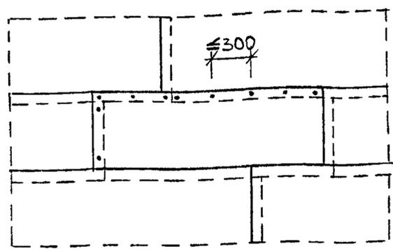
СХЕМА СОЕДИНЕНИЯ ЭЛЕМЕНТОВ ПОЛА
