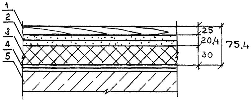
1 — покрытие из паркетных досок; 2 — сборная стяжка из готовых элементов пола; 3 — плиты пенополистирольные; 4 — пленка полиэтиленовая; 5 — пустотная железобетонная панель перекрытия
