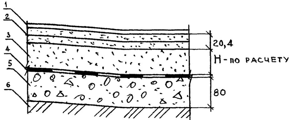
1 — покрытие пола; 2 — сборная стяжка из готовых элементов пола; 3 — засыпка из керамзитового песка; 4 — два слоя гидростеклоизола; 5 — подстилающий слой из бетона М 150 с затертой поверхностью; 6 — щебень (гравий) крупностью 40-60 мм, втрамбованный в грунт основания.
