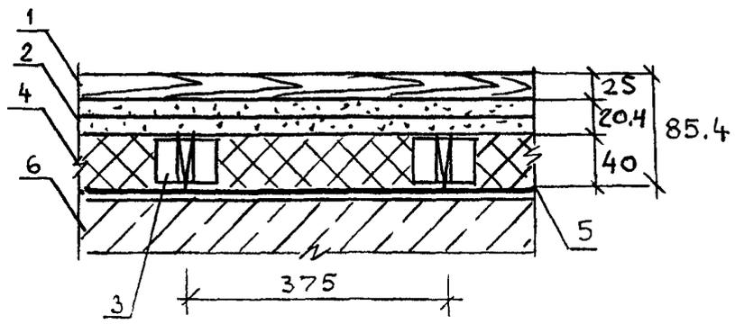
1 — покрытие пола из паркетных досок; 2 — сборная стяжка; 3 — лага самонивелирующая; 4 — плиты пенополистирольные; 5 — битуминозный рулонный материал; 6 — плита перекрытия безпустотная
