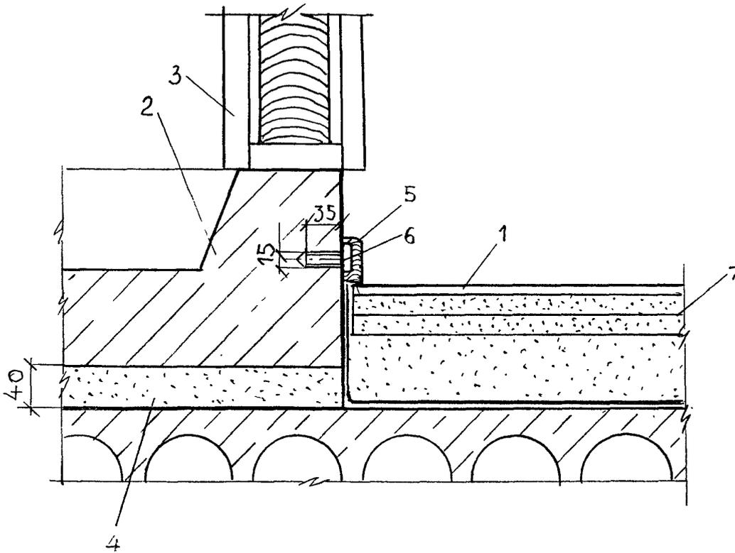
1 — покрытие пола; 2 — поддон сантех кабины; 3 — дверной блок; 4 — подсыпка из песка; 5 — плинтус тип 1;
