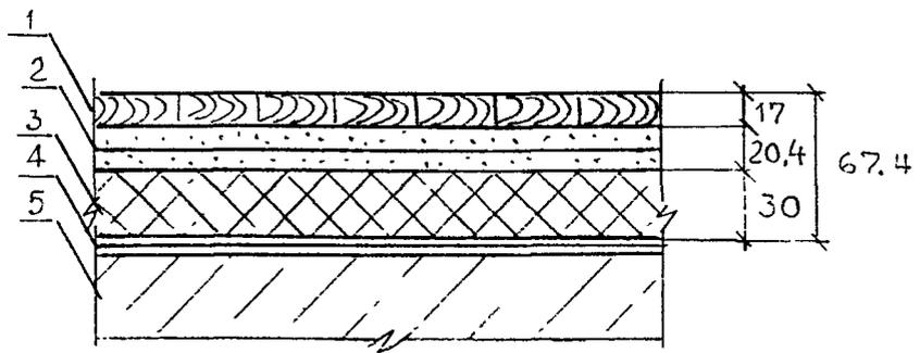
1 — покрытие пола из штучного паркета; 2 — сборная стяжка из готовых элементов пола; 3 — плиты пенополистирольные ПСБ-С; 4 — пленка полиэтиленовая; 5 — безпустотная панель перекрытия
