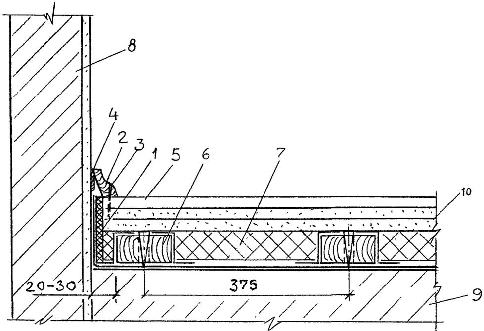
1 — кромочная лента; 2 — плинтус типа 3; 3 — гвоздь (шуруп); 4 — звукоизолирующая прокладка;
