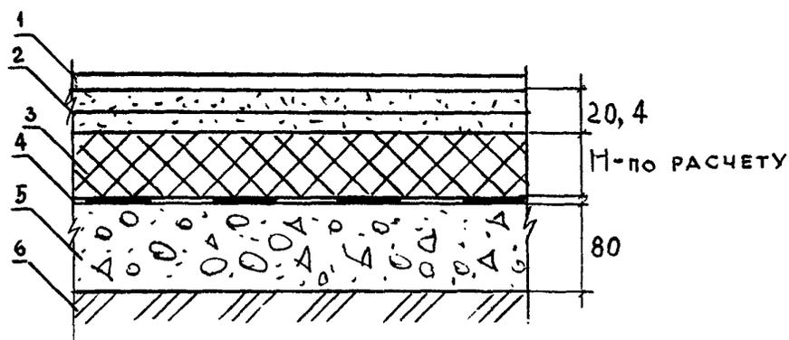
1 — покрытие пола; 2 — сборная стяжка из готовых элементов пола; 3 — плиты пенополистирольные; 4 — два слоя гидростеклоизола; 5 — подстилающий слой из бетона М 150 с затертой поверхностью; 6 — щебень (гравий) крупностью 40-60 мм, втрамбованный в грунт основания.
