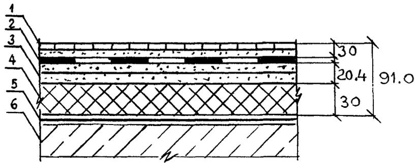
1 — покрытие из керамической плитки на цементно-песчаном растворе; 2 — гидроизоляция из битуминозных материалов; 3 — сборная стяжка      4 — плиты пенополистирольные; 5 — полиэтиленовая пленка; 6 — безпустотная железобетонная плита перекрытия
