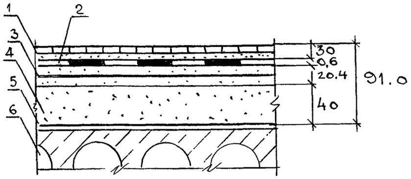
1 — покрытие из керамической плитки 150 x 150 x 13 на цементно-песчаном растворе М 150, 2 — гидроизоляционный слой, 3 — сборная стяжка из готовых элементов пола, 4 — подсыпка из керамзитового песка; 5 — пленка полиэтиленовая; 6 — многопустотная железобетонная плита перекрытия.
