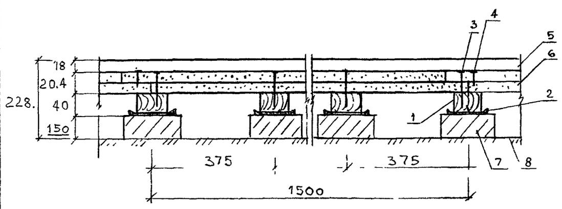
1 — лага 80 x 40 мм; 2 — слой гидростеклоизола; 3 — гвоздь К4 x 100; 4 — шуруп для ГВЛ; 5 — покрытие пола; 6 — элемент пола; 7 — бетонный (кирпичный) столбик 250 x 250 x 150 через 800 мм; 8 — щебень (гравий) фракцией 40-60 мм втрамбовать в грунт основания.
