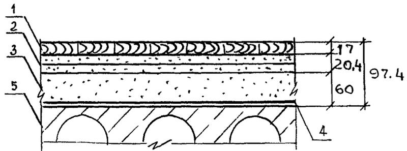
1 — покрытие из штучного паркета на холодной водостойкой мастике; 2 — сборная стяжка из готовых элементов пола; 3 — подстилающий слой из керамзитового песка; 4 — полиэтиленовая пленка; 5 — многоячеечная железобетонная плита перекрытия
