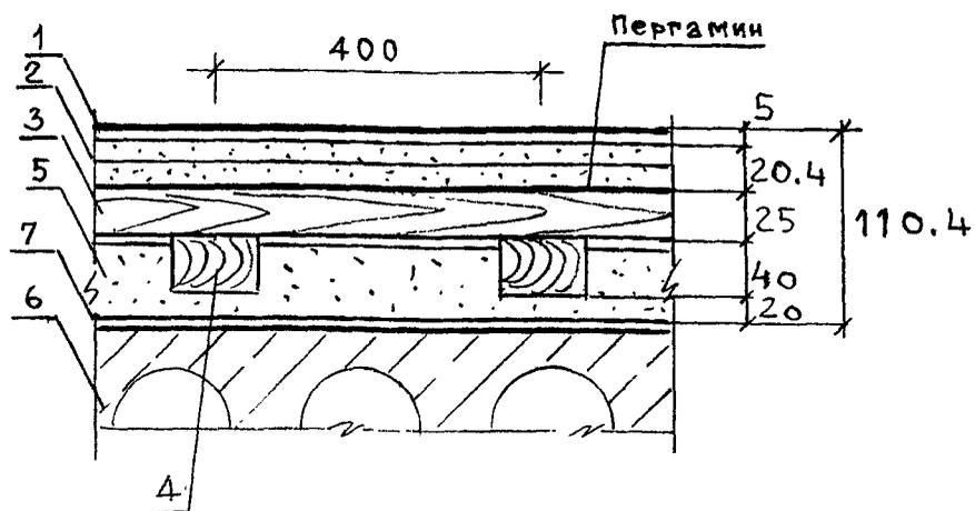
1 — покрытие из линолеума на тканевой основе на холодной водостойкой мастике; 2 — сборная стяжка из готовых элементов пола; 3 — сплошной дощатый настил из обрезных досок 80 х 25 мм; 4 — лаги 80 х 40 мм; 5 — керамзитовый песок; 6 — многопустотная панель перекрытия; 7 — пленка полиэтиленовая
