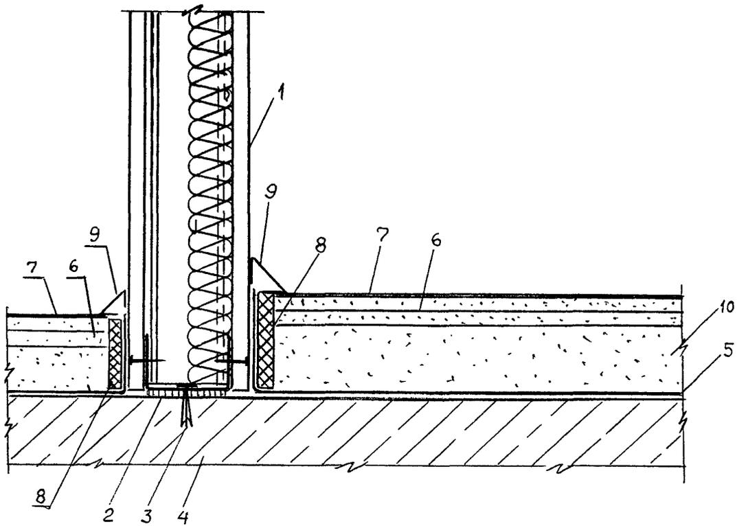
1 — перегородка; 2 — уплотнитель; 3 — дюбельный гвоздь; 4 — несущая плита перекрытия; 5 — пленка полиэтиленовая; 6 — сборная стяжка; 7 — покрытие пола; 8 — кромочная лента; 9 — плинтус пластиковый; 10 — подстилающий слой.
