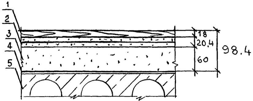
1 — покрытие пола из паркетных досок; 2 — сборная стяжка; 3 — засыпка из керамзитового песка;
