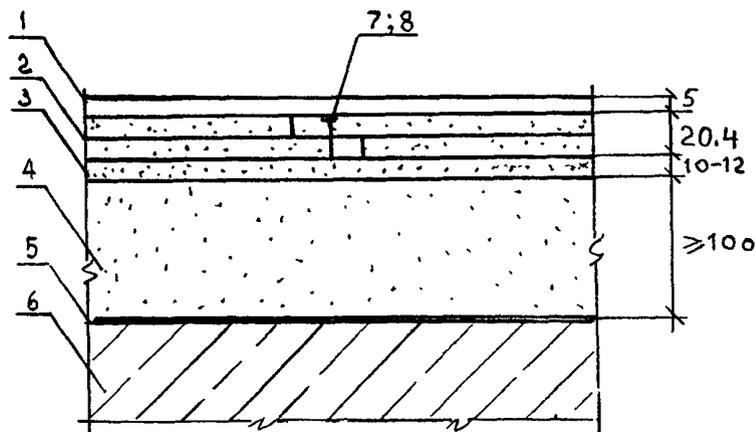
1 — покрытие пола; 2 — сборная стяжка из готовых элементов пола; 3 — крупноформатный гипсоволокнистый лист; 4 — засыпка из керамзитового песка; 5 — полиэтиленовая пленка; 6 — безпустотная железобетонная плита перекрытия; 7 и 8 — клей и шуруп для ГВЛ
