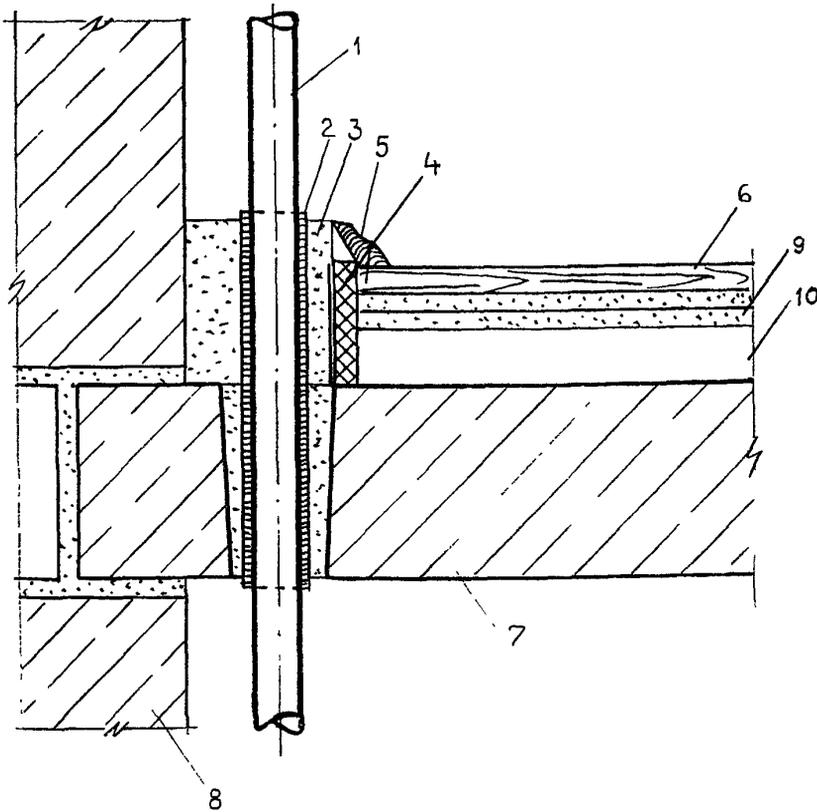
1 — пропускаемая труба; 2 — гильза из асбестового картона; 3 — безусадочный раствор; 4 — кромочная лента; 5 — плинтус тип 3; 6 — покрытие пола; 7 — несущая плита перекрытия; 8 — стена; 9 — сборная стяжка; 10 — подстилающий слой.
