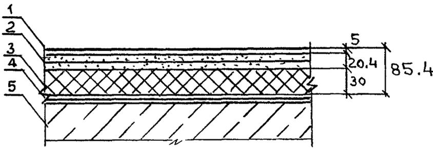
1 — покрытие из линолеума ПВХ на тканевой основе на холодной водостойкой мастике; 2 — сборная стяжка из готовых элементов пола; 3 — плиты пенополистирольные; 4 — пленка полиэтиленовая; 5 — безпустотная панель перекрытия
