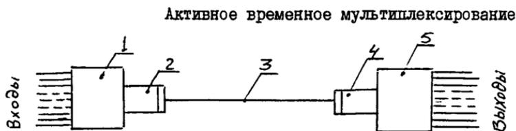
I - мультиплексор; 2 - излучатель; 3 - оптический световод (волокно); 4 - фотоприемник; 5 - демультимплексор.
