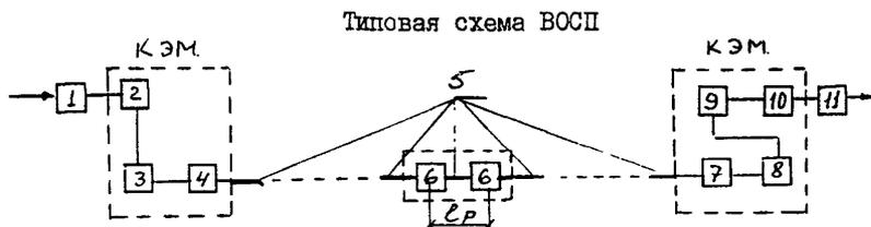
I - преобразователь кода (кодер); 2 - модулятор; 3 - оптический источник излучения; 4 - передающее согласующее оптическое устройство; 5 - оптический кабель (ИМ, ВС); 6 - линейный регенератор (при больших протяженных линиях); 7 - приемное согласующее оптическое устройство; 8 - фотодетектор; 9 - усилитель; 10 - демодулятор; 11 - преобразователь кода (декодер); КЭМ - квантово-электронный модуль.
