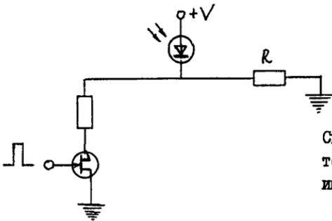
Схема с полевым транзистором, применяемая для импульсной модуляции
