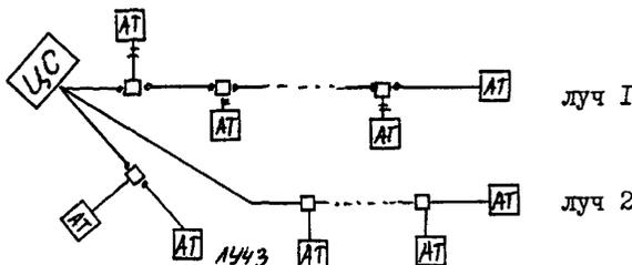
$Q_{тр}$  будет определена для каждого луча с добавлением потерь на "звезду" на основе выражения  $(10) \propto \text{звезды} = 3$  дБ.
