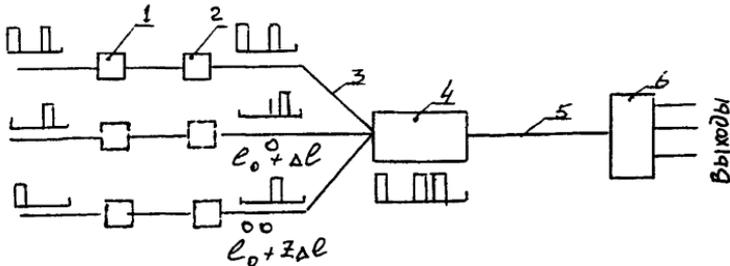
1 - схема управления (электронный блок); 2 - излучатель;
