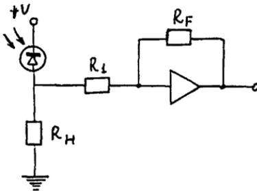
Для усиления падения напряжения на резисторе  $R_H$  применяют операционный усилитель
