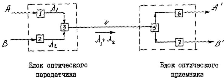
1, 2 - оптические передатчики; 3 - волоконно-оптический разветвитель; 4 - ОК (волоконный световод); 5 - оптический демultipлексор; 6, 7 - оптические приемники.
