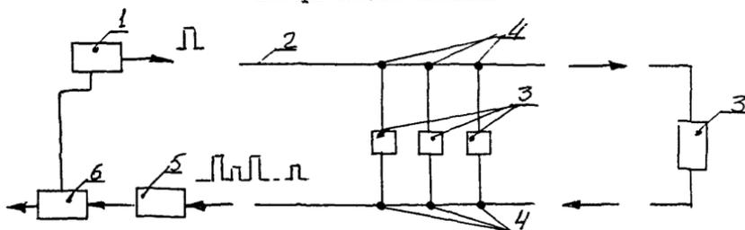
1 - излучатель; 2 - волоконный световод; 3 - оптические датчики; 4 - оптический смеситель; 5 - фотоприемник; 6 - демультиплексор.
