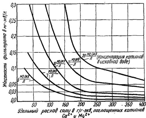
Рис. 6. График для определения жесткости воды, умягченной натрий-катионированием
