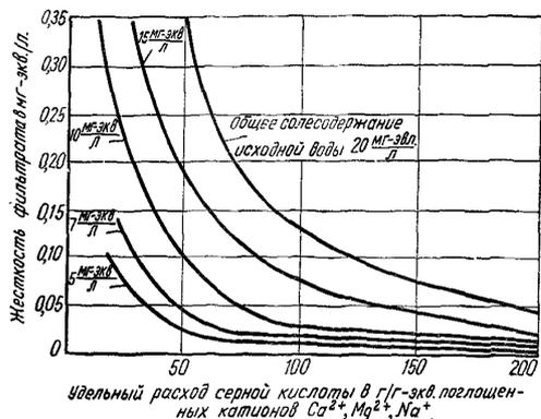
Рис. 7. График для определения жесткости воды, умягченной водород-катионированием
