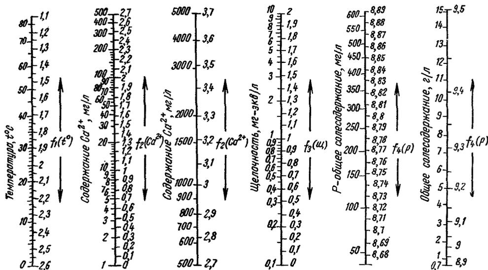
Рис. 1. График для определения рН равновесного насыщения воды карбонатом кальция
