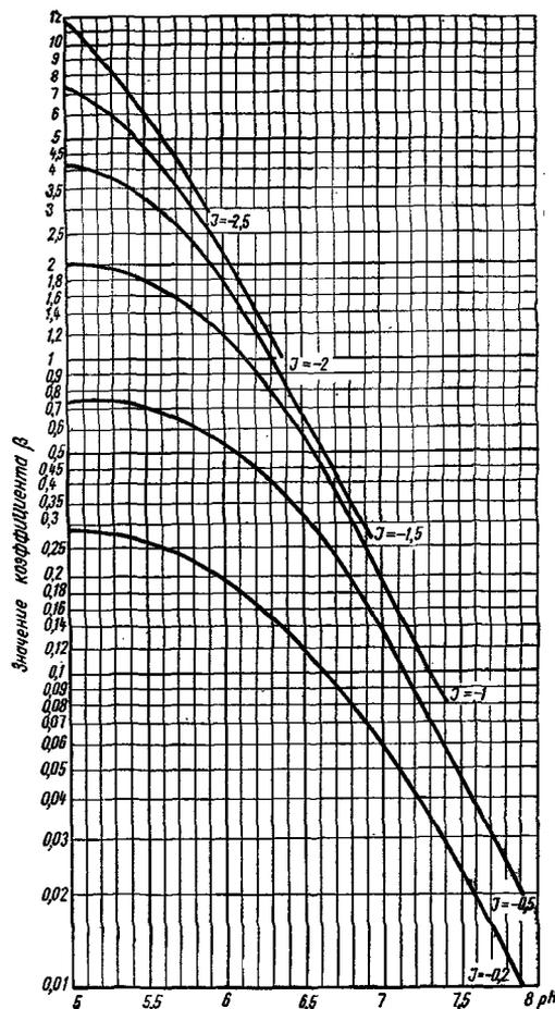
Рис. 4. График для определения коэффициента  $\beta$  при расчете дозы щелочи при  $pH_0 < pH_s < 8,4$
