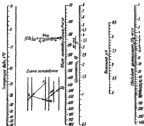
Рис. 2. Номограмма для определения рН или концентрации свободной углекислоты в природной воде
