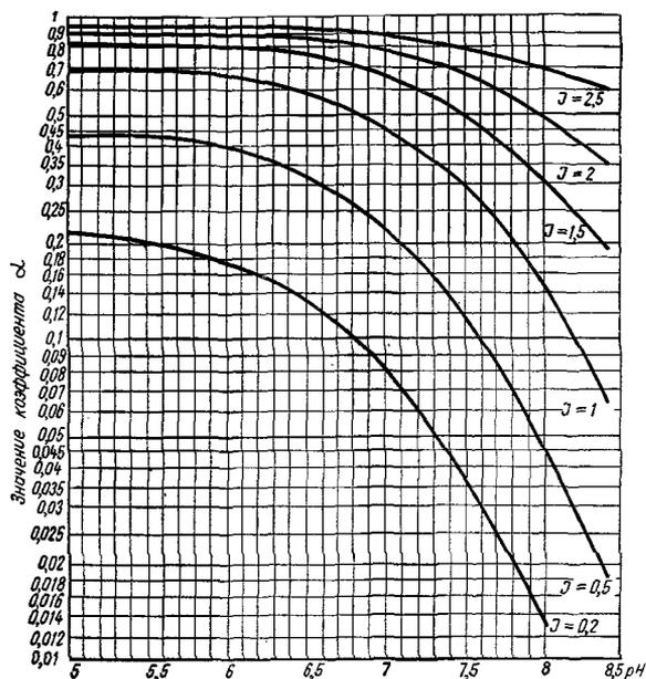
Рис. 3. График для определения вспомогательного коэффициента  $a$  при расчете дозы кислоты
