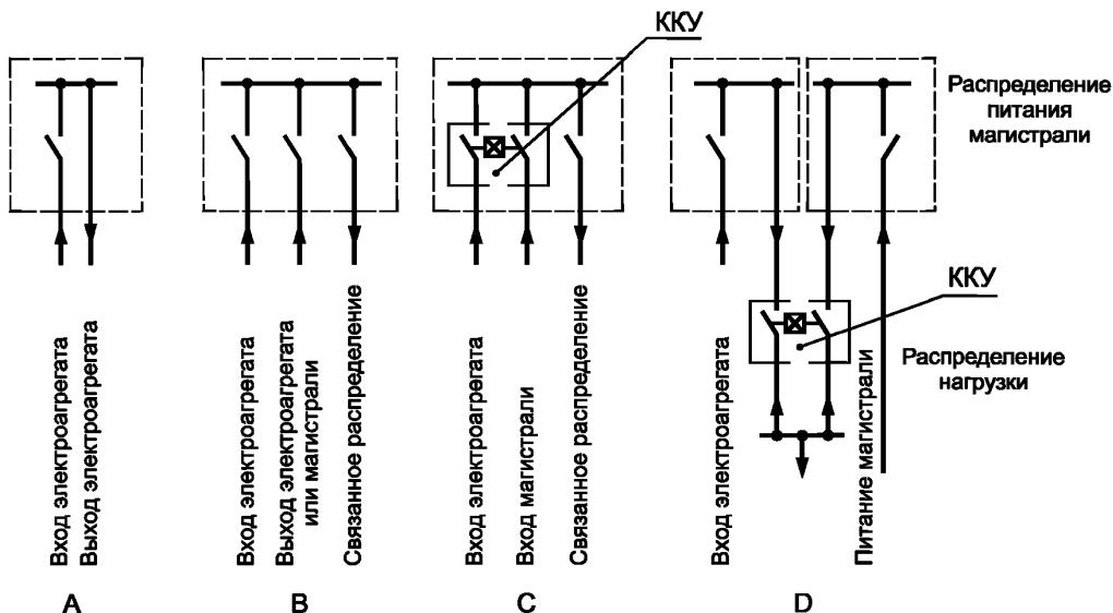
А — коммутационное устройство одиночного электроагрегата;
