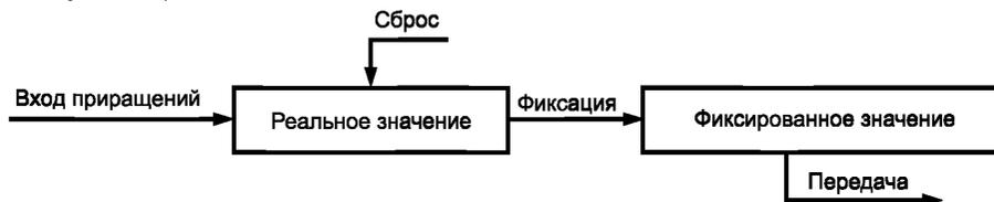
Рисунок 92 — Общая модель счетчика
