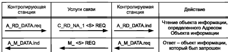
Рисунок 109 — Последовательная процедура — процедура чтения
