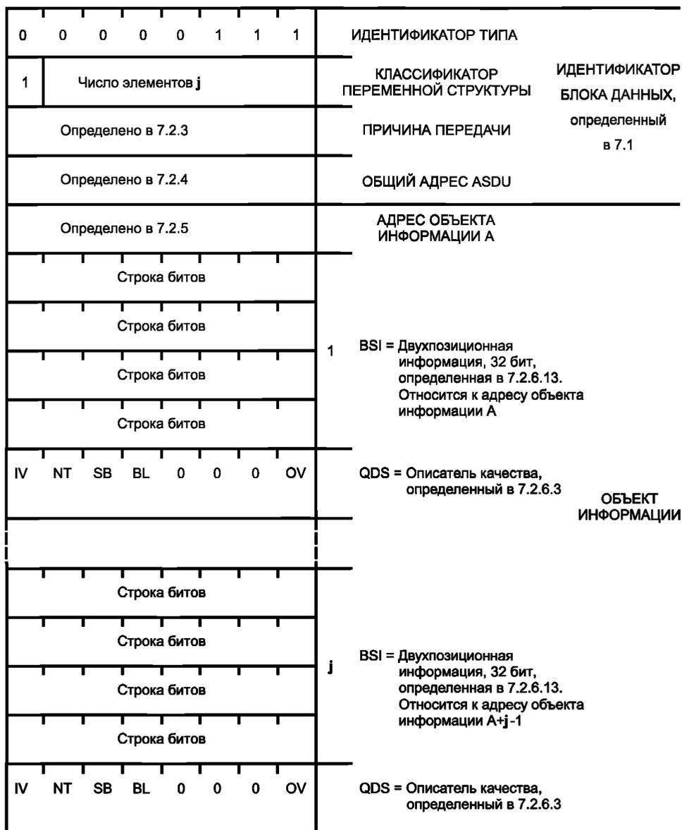
Рисунок 32 — ASDU: M\_BO\_NA\_1 Последовательность строк из 32 бит
