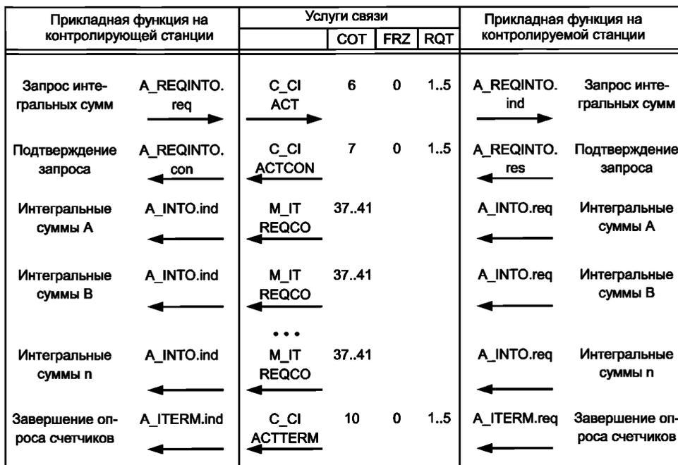
Рисунок 94 — Последовательная процедура опроса интегральных сумм (Режим В)
