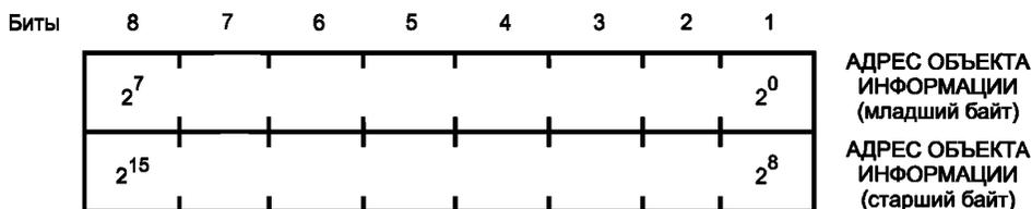
Рисунок 20 — АДРЕС ОБЪЕКТА ИНФОРМАЦИИ (два байта)
