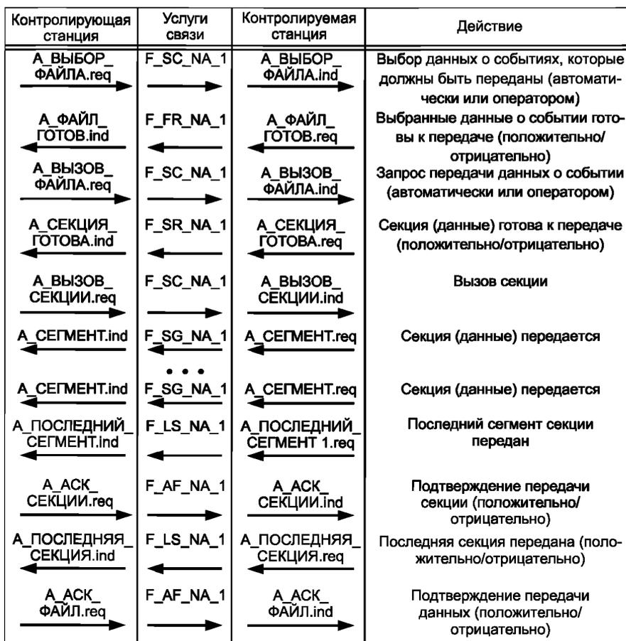
Рисунок 106 — Последовательная процедура передачи последовательности событий
