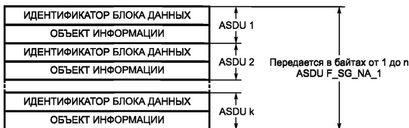
Рисунок 105 — Запись последовательности событий в секции файла данных
