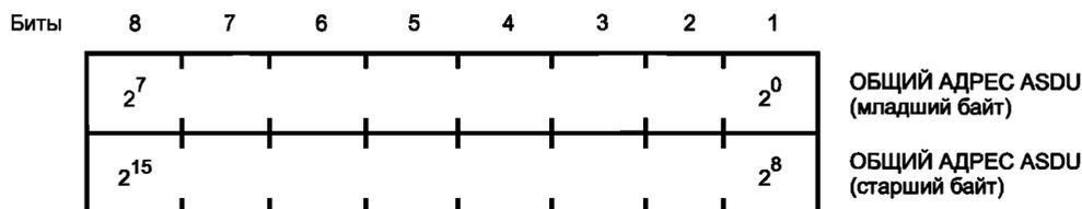
Рисунок 18 — ОБЩИЙ АДРЕС ASDU (два байта)
