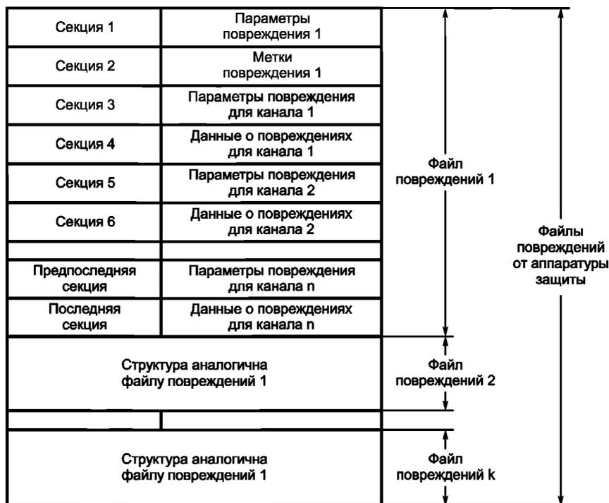
Рисунок 100 — Структура данных о повреждениях от аппаратуры защиты
