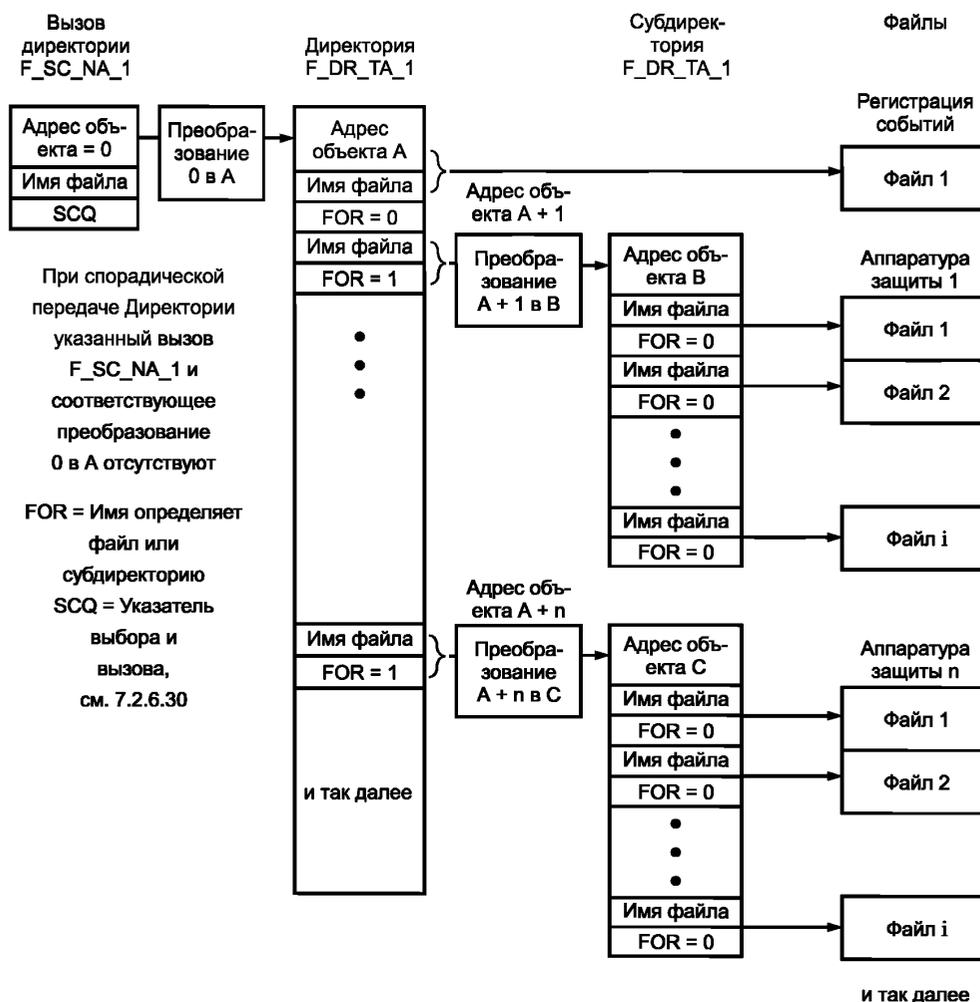
Рисунок 97 — Адресация файлов (пример)
