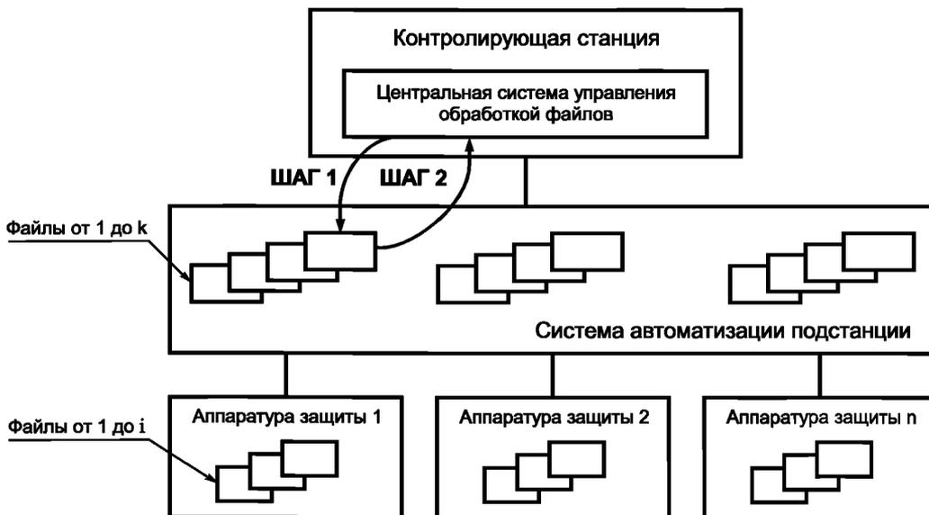
Рисунок 99 — Запрос от системы автоматизации подстанции
