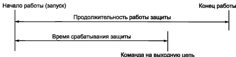
Команда на выходные цепи формируется устройством релейной защиты, когда защита решает отключить выключатель. Команды на выходные цепи поступают в виде кратковременно действующих сигналов.
