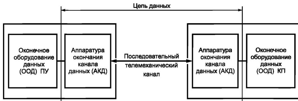
Рисунок 2 — Интерфейсы и соединения между ПУ и КП
