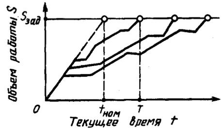
Рисунок 6 — Возможные реализации случайного процесса накопления объема выполненной работы (переработанных данных)
