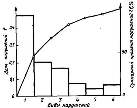
Обозначения: 1 — появление случайных ошибок; 2 — несвоевременное выполнение операций сбора и переработки данных; 3 — использование устаревших сведений; 4 — несанкционированный доступ к данным; 5 — намеренное искажение данных; 6 — прочие нарушения
