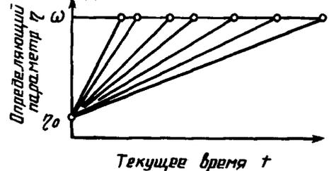
Рисунок 7 — Возможные реализации полуслучайного процесса разрегулирования
