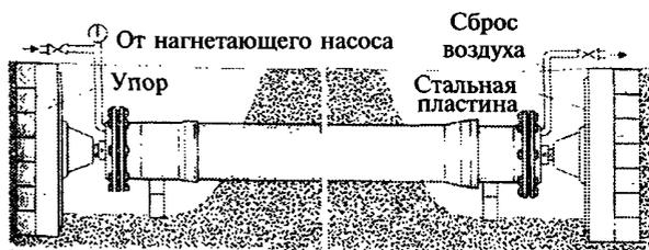
Рисунок 5.11 — Подготовка трубопровода к гидроиспытанию
