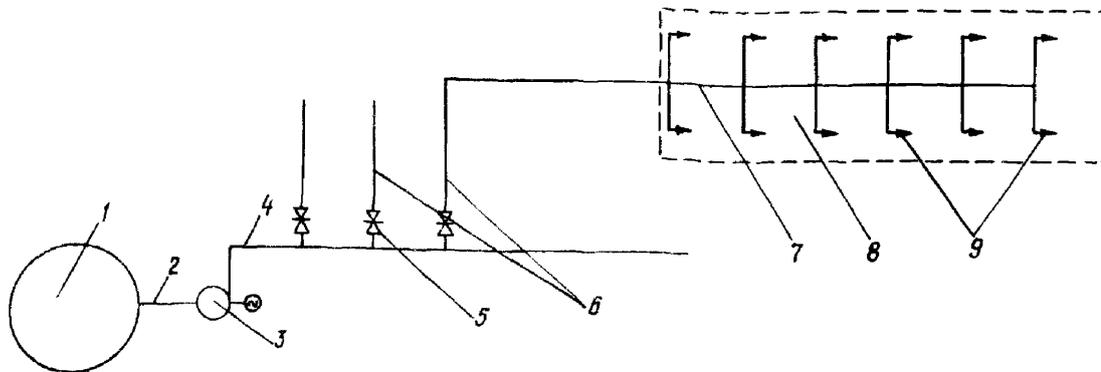
Принципиальная схема установки водяного пожаротушения:
