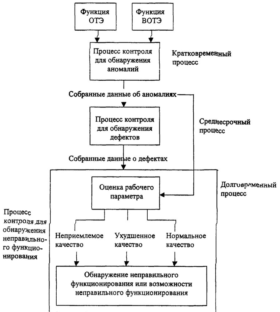
Рисунок 5 - Процесс контроля в объекте технической эксплуатации
