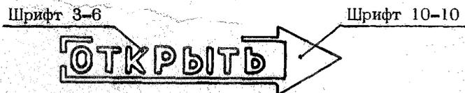
18. Если надпись состоит из букв (цифр или знаков), различных по высоте, то каждый размер шрифта и его условный код должны быть проставлены в чертежах на отдельных полках линий-выносок, а ссылка на настоящий стандарт приведена в технических требованиях чертежа.
