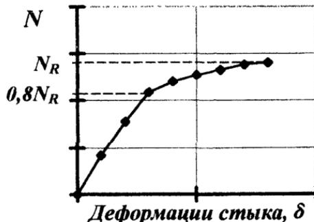
Рис. 13. Диаграмма сжатия вертикального стыка колонн
