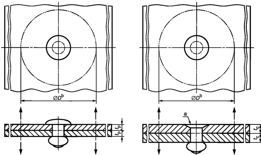
$a$  — угол потая равен номинальному углу потайной головки заклепки с допуском  $-2^\circ$ ;  $b$  — круговая плоская поверхность вокруг оси образца с минимальным диаметром 25 мм
