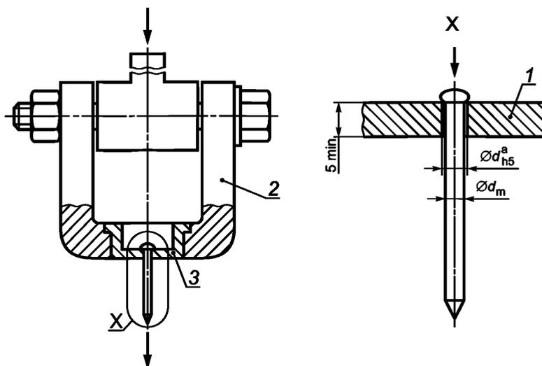
1 — испытательная пластина; 2 — испытательное приспособление, соответствующее рисунку 5 (только одна часть);
