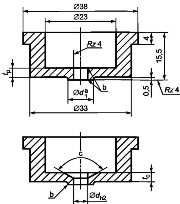
*a* —  $d_1 = 2d$  (*d* — номинальный диаметр заклепки); *b* — на кромках отверстий не должно быть заусенцев; *c* — угол потая равен номинальному углу потайной головки заклепки с допуском  $-2^\circ$
