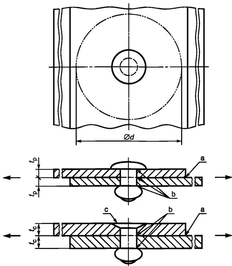
*a* — *Rz4*; *b* — на кромках отверстий не должно быть заусенцев; *c* — угол потая равен номинальному углу головки заклепки с допуском  $-2^\circ$ ; *d* — круговая плоская поверхность вокруг оси образца с минимальным диаметром 25 мм
