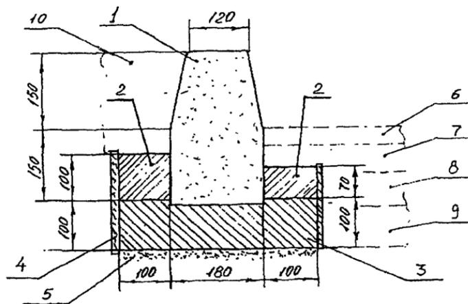
Рис. 2. Схема установки бортового камня
