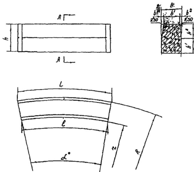
Рис. 1. Общий вид криволинейных бортовых камней.
