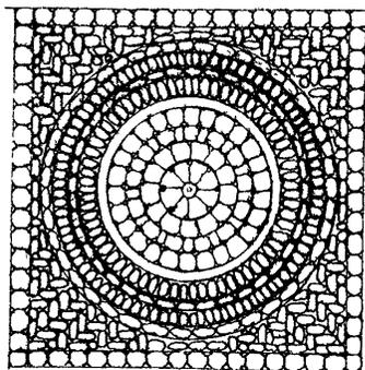
Фрагмент покрытия из мелкогазмерных плит
