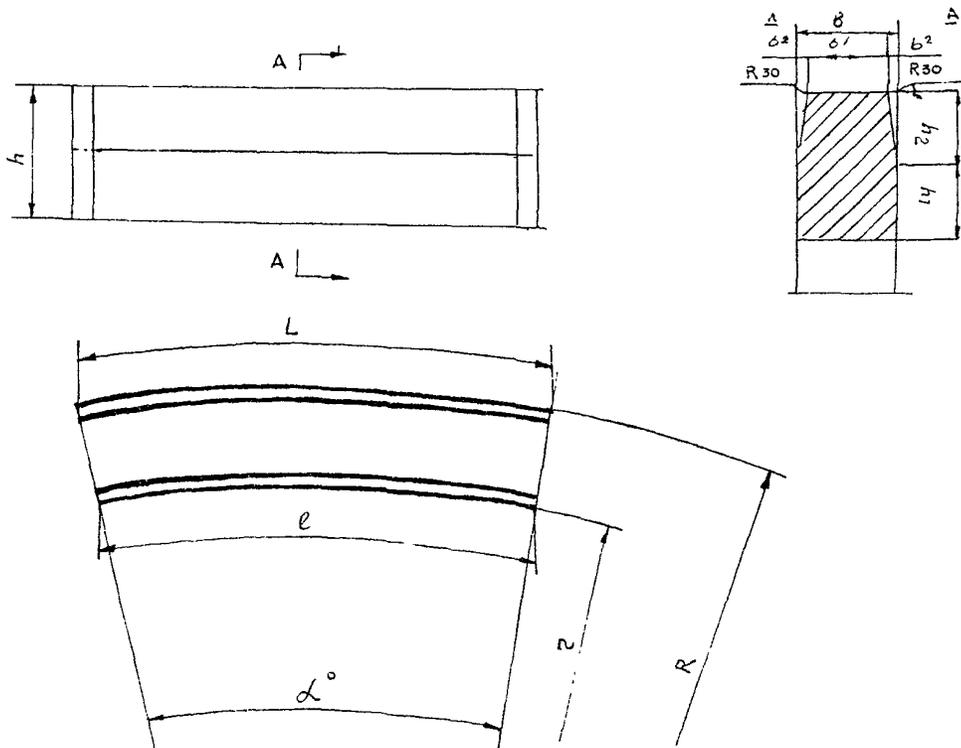
Рис 2 Общий вид криволинейных бортовых камней
