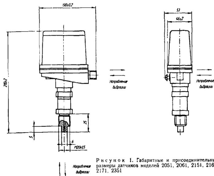
Рисунок 1. Габаритные и присоединительные размеры датчиков моделей 2051, 2061, 2151, 2161, 2171, 2351
