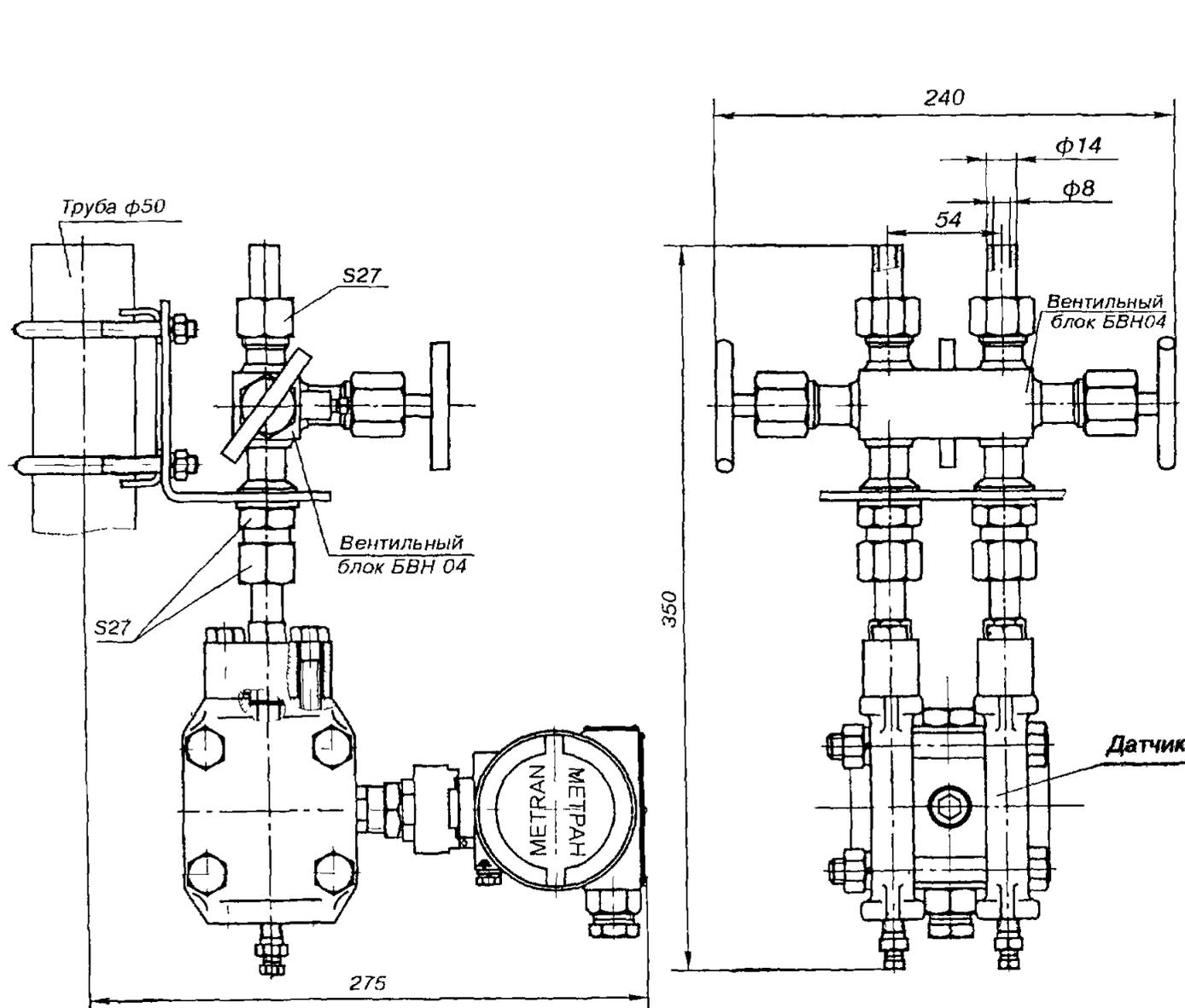
Рис.6. Метран-49-ДД мод.9420, 9430, 9440 с вентильным блоком BVN 04.
