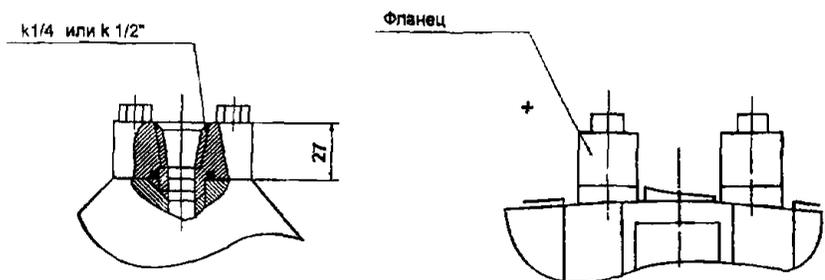
Рис.8. Преобразователь с установленными ниппелями под накидные гайки М20х1,5, остальное см.б
