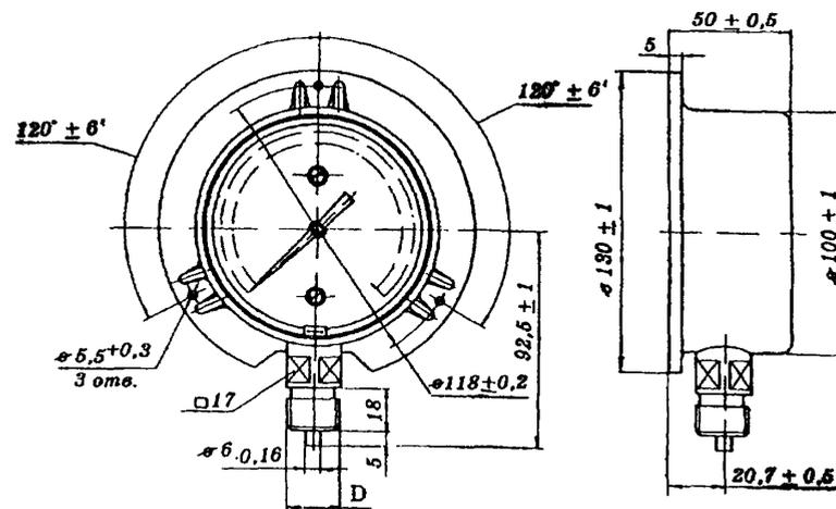
Габаритные и присоединительные размеры манометра с бортом
