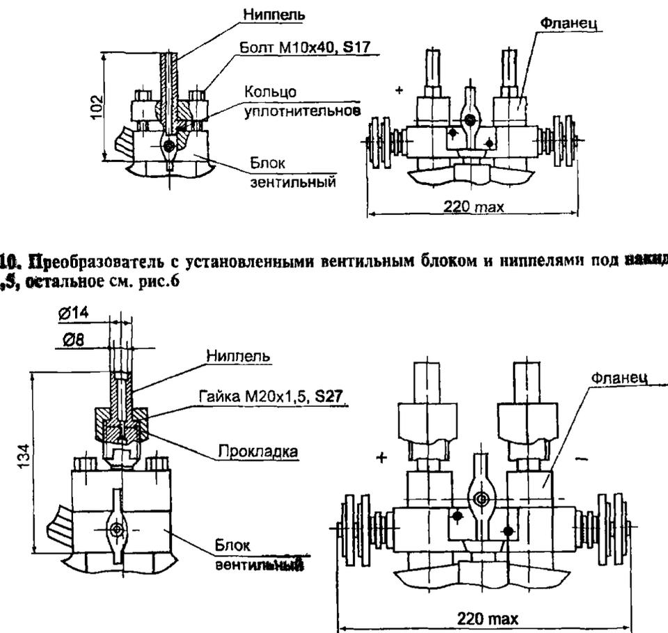
Рис.11. Преобразователь с установленными вентиляльным блоком и фланцами, остальное см. рис.б
