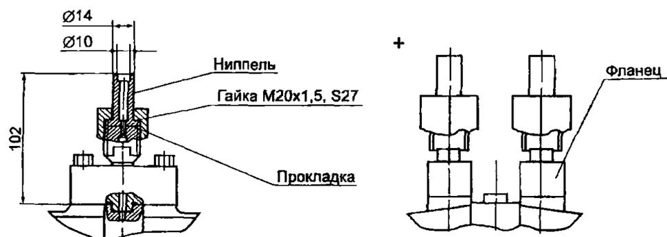
Рис.10. Преобразователь с установленными вентиляльным блоком и ниппелями под накидные гайки М20х1,5, остальное см. рис.б
