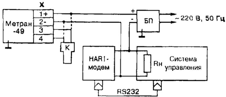
Многоточечный режим для датчиков МП2, МП3 (не более 15 датчиков)
