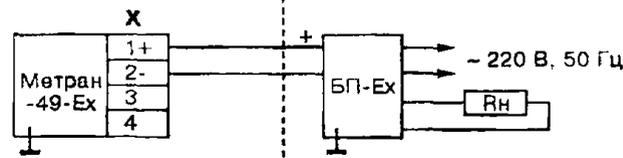
Вариант для датчиков МП2, МП3 с барьером искрозащиты, без гальванической развязки сигнальных цепей и цепей питания
