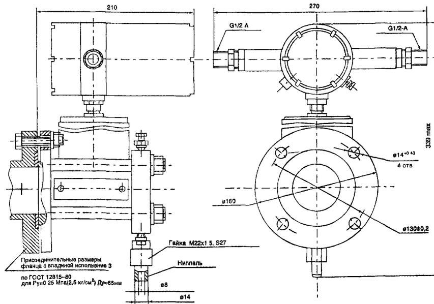
**Рис.2 Габаритные, установочные и присоединительные размеры преобразователя Сапфир-22К-ДА-1**
