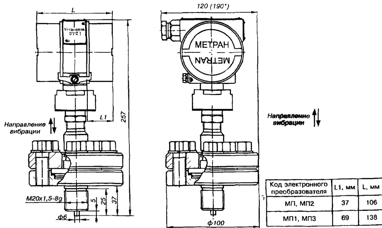
Размер для исполнения "взрывонепроницаемая оболочка" (Вн), см рис А, вариант А для датчиков Метран-49-Вн.
