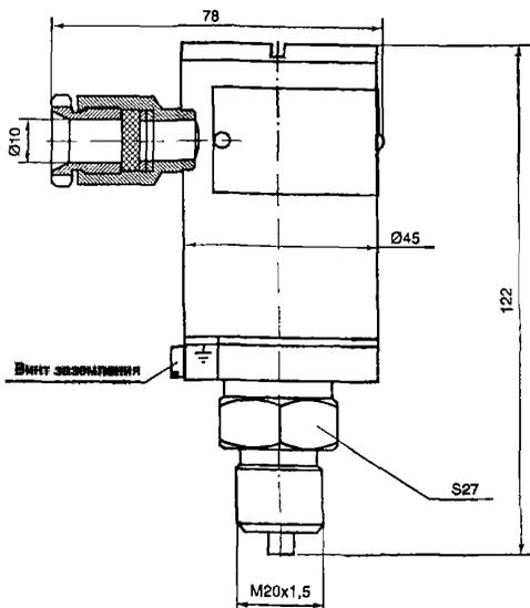
Преобразователь невзрывозащищенный и с видом взрывозащиты «искробезопасная электрическая цепь «ia» с разъемом Сапфир-22Р-ДИ, Сапфир-22РДИ-Ех.
