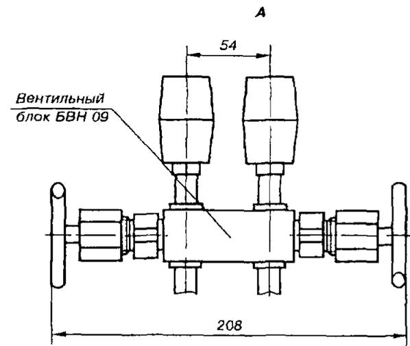
Рис.7. Метран-49-ДД мод.9420, 9430, 9440 с вентильным блоком BVN 09.
