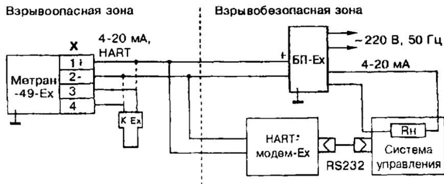
Вариант для датчиков МП2, МП3 с HART-модемом
