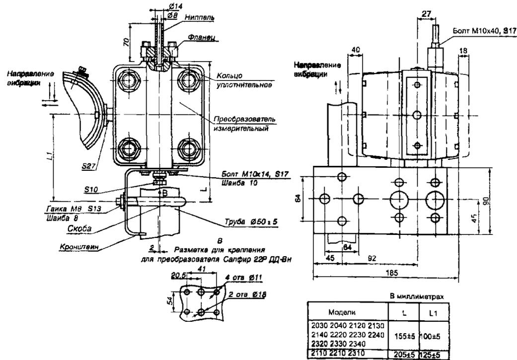
Рис.2. Преобразователь с установленным ниппелем под накидную гайку М20х1,5, остальное см. рис.1
