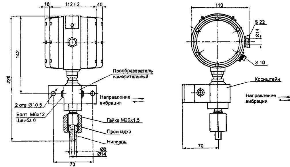
Рис.4. Установочные и присоединительные размеры преобразователей Сафир-22Р модели 2050, 2150, 2160, 2170, 2350
