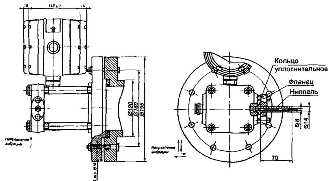
Рис.13. Преобразователь с установленными ниппелями под накладки гайки M20x1,5, остальное см. рис.12
