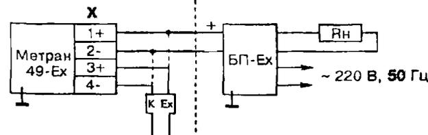
Вариант для датчиков МП2, МП3 с искрозащищенным блоком питания и HART-модемом
