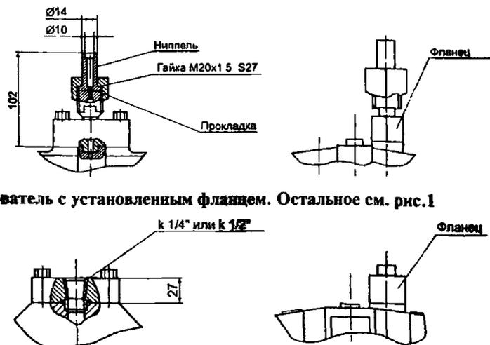
Рис.3. Преобразователь с установленным фланцем. Остальное см. рис.1
