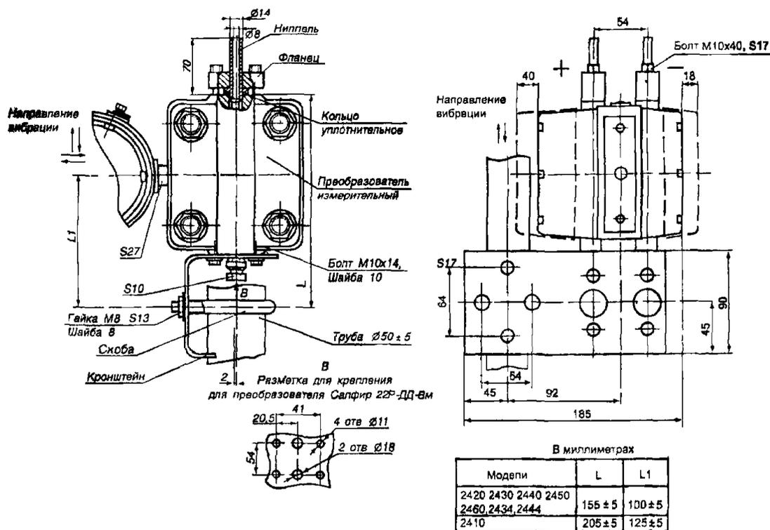
Рис.7. Преобразователь с установленными фланцами, остальное см. рис.б
