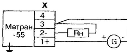
Для датчиков с выходным сигналом 4-20 мА
