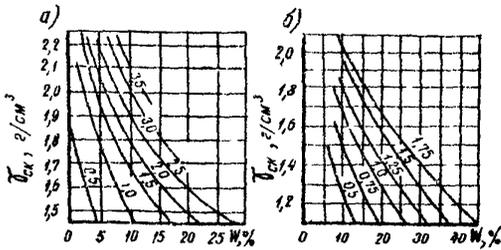
Рис.5. Графики для определения коэффициентов теплопроводности мерзлых грунтов:
