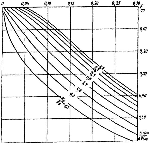
Рис.4. Номограмма для расчета средней осенней влажности грунта земляного полотна ( $W_{cp}^0$ ) с учетом толщины активной зоны ( $H_a$ ) при  $\Gamma_{OH} = 0,25$
