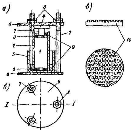
Рис.7. Прибор для испытания образцов грунта на водонасыщение при температуре, близкой к 0°C:
