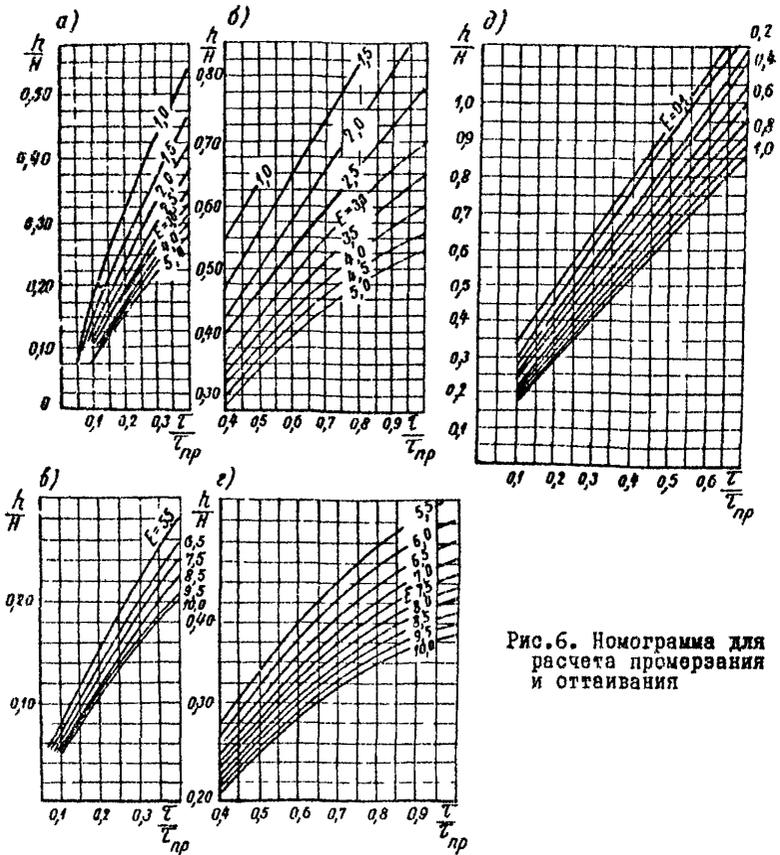
Рис.6. Номограмма для расчета промерзания и оттаивания
