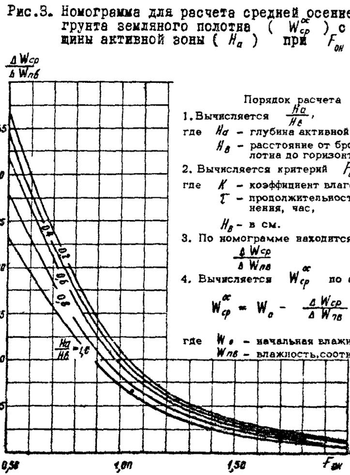
Рис.3. Номограмма для расчета средней осенней влажности грунта земельного полотна ( $W_{ср}^{\alpha}$ ) с учетом толщины активной зоны ( $H_a$ ) при  $F_{он} \approx 0,25$
