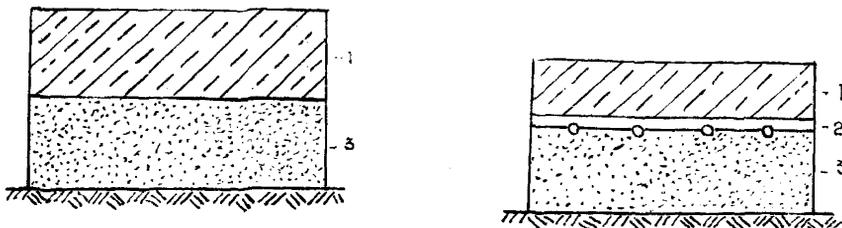
**Рис.6.** Конструкции садово-парковых дорожек, с использованием стабилизированного местного грунта:
