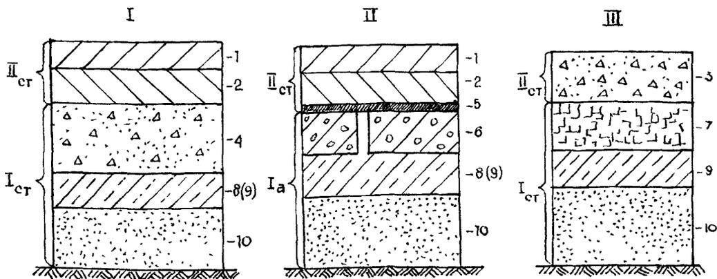
**Рис. 1.** Принципиальная схема конструкций магистральных районных (I) и жилых (II, III) улиц, устраиваемых при двухстадийном строительстве дорог:
