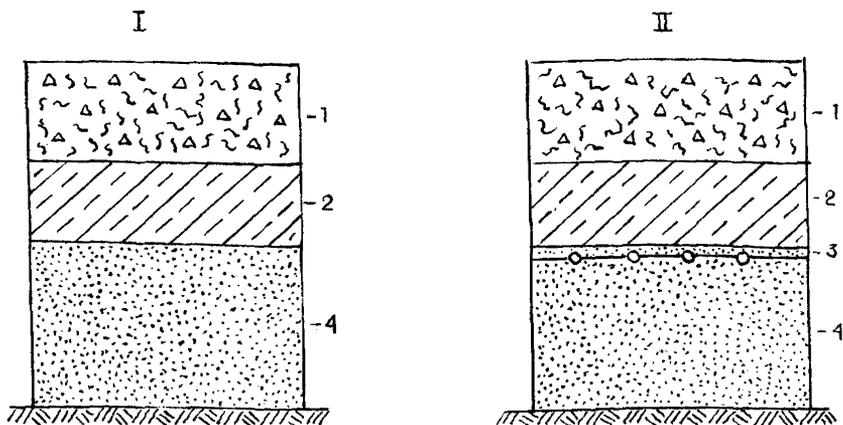
**Рис.3.** Принципиальная схема конструкций улиц и дорог местного значения, в т.ч. для благоустройства элитных жилых комплексов, благоустройства объектов соцкультбыта, находящихся в сложных грунтово-гидрогеологических условиях (I), а также при продольных уклонах 40 и более промилей и в местах разрывов (II):
