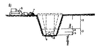
Рис. 6.2. Схема организации работ по засыпке траншей:
