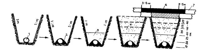
1 Укладка труб и проверка стыковых соединений Проведение испытаний трубопроводов Акт на проведение обратной засыпки
