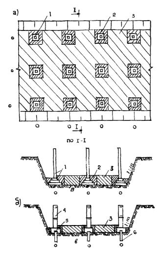
Рис. 7.1. Схема засыпки грунта под полы в подвале здания:
