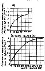
Тарировочные 2. графики для определения плотности зависимости числа ударов от степени грунта методом зондирования плотности грунтов в пределах их оптимальной влажности:
