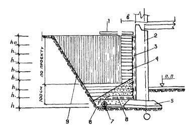
Рис. 8.1. Схема обратной засыпки пазухи котлована:
