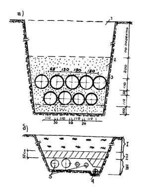
Рис. 6.3. Схема обратной засыпки траншей:
