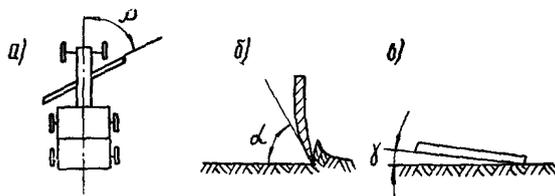
Рис. 3. Углы установки отвала автогрейдера в рабочее положение:
