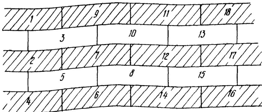
Рис. 3. Шахматно-гребенчатая схема разрезания грунта (цифрами указана последовательность разрезания)
