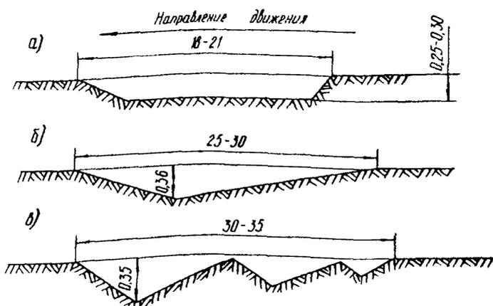
Рис. 2. Схемы разрезания грунта (размеры указаны в метрах):
