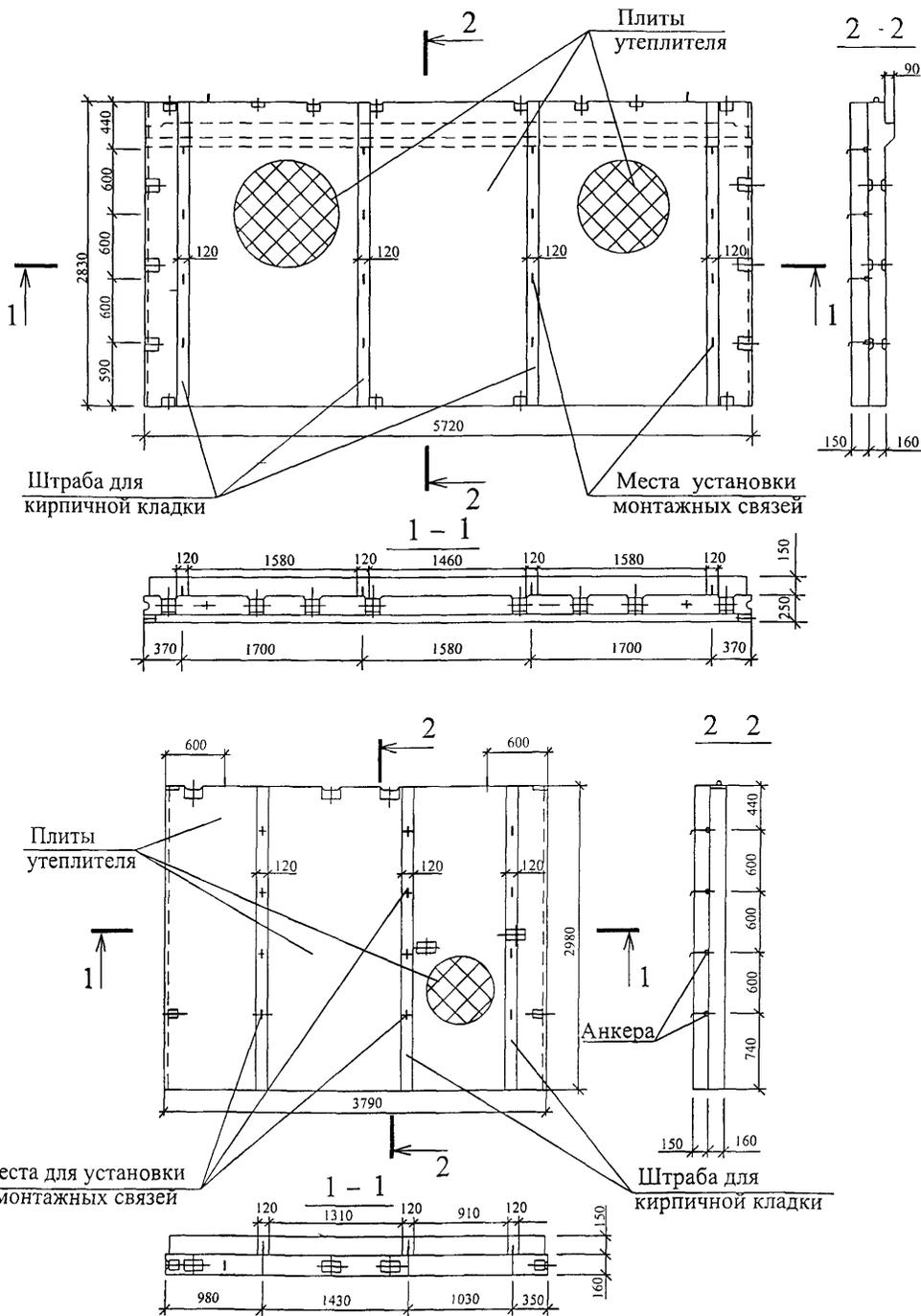
Рисунок 4 - Примеры раскладки теплоизоляционных пенополистирольных плит
