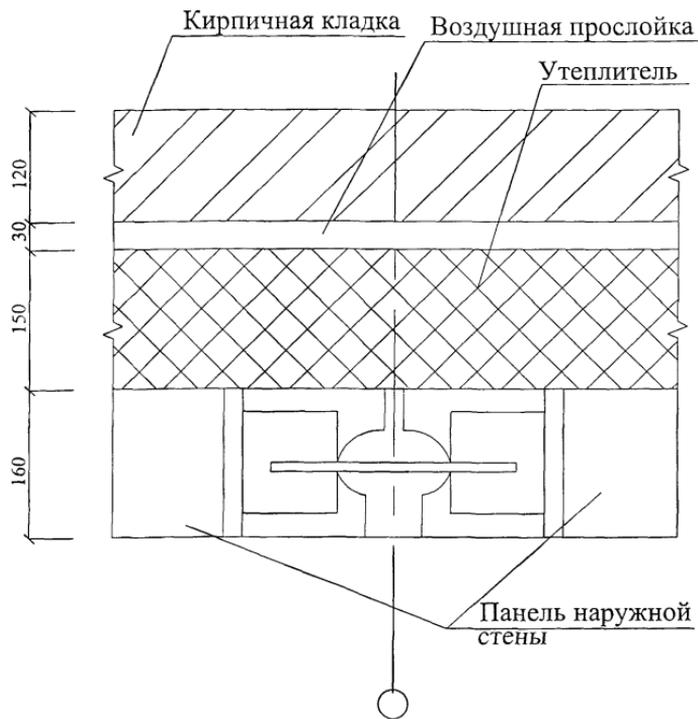
Рисунок 1 - Вариант конструктивного решения стенового ограждения жилого дома с прокладкой утеплителя и облицовкой кирпичом в простенках.
