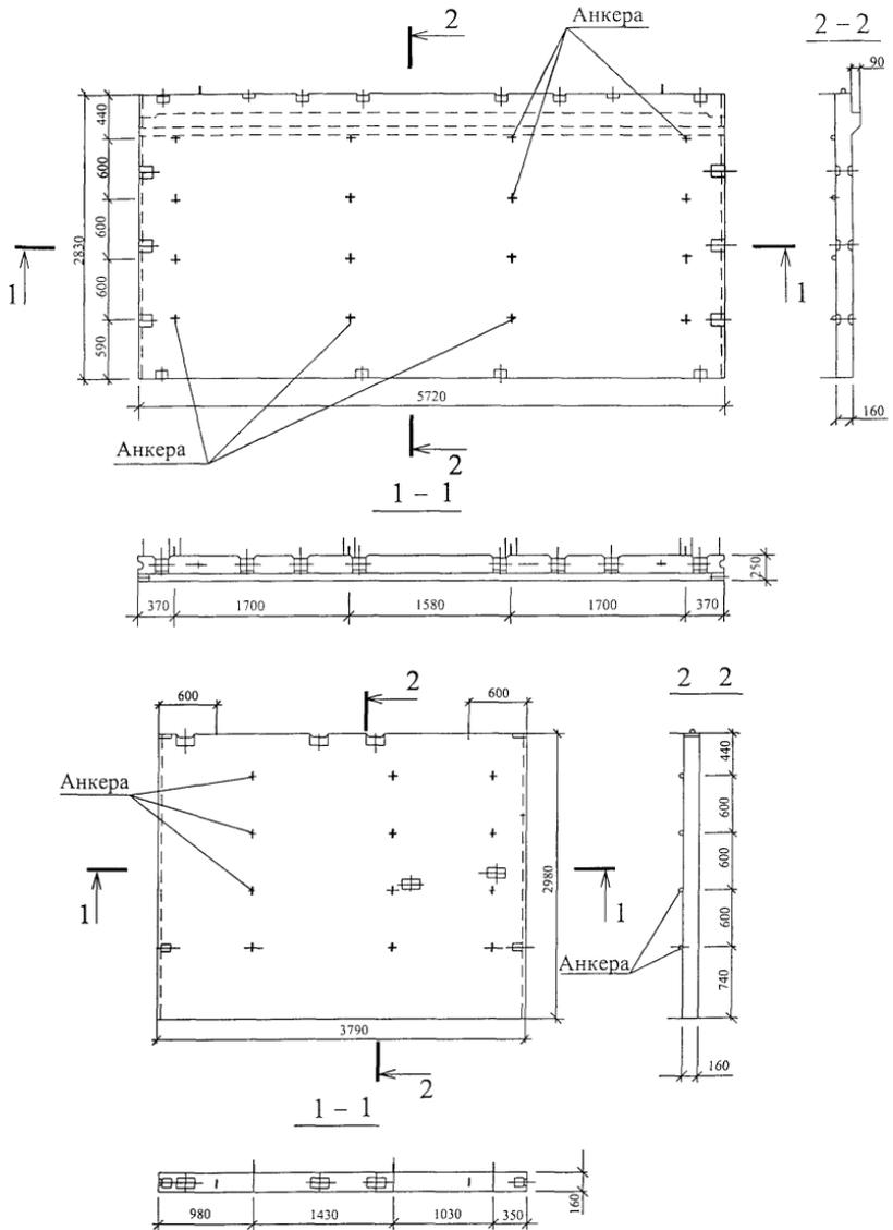
Рисунок 3 - Варианты расстановки анкеров в стеновых панелях
