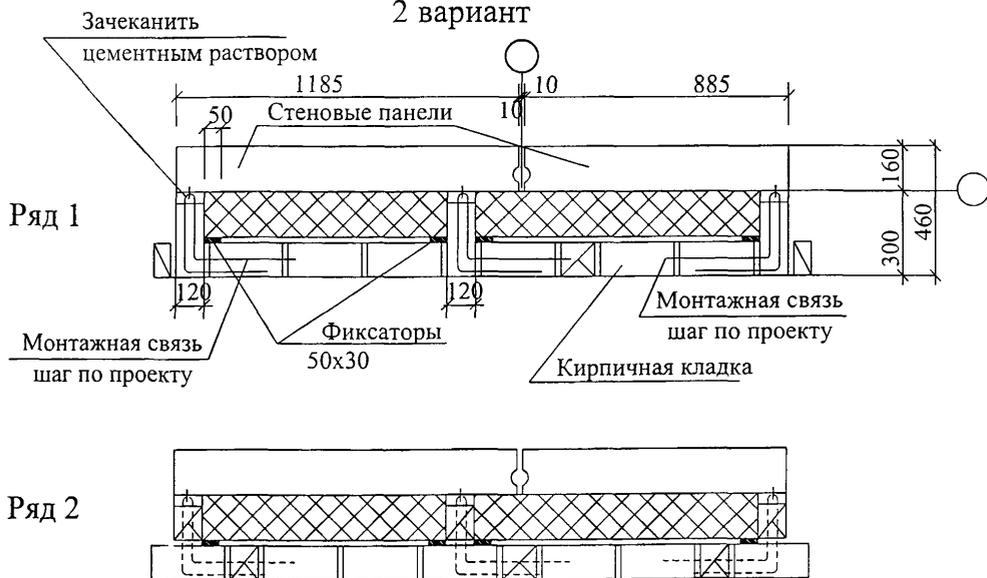
Рисунок 5 - Варианты кладочных планов простенков
