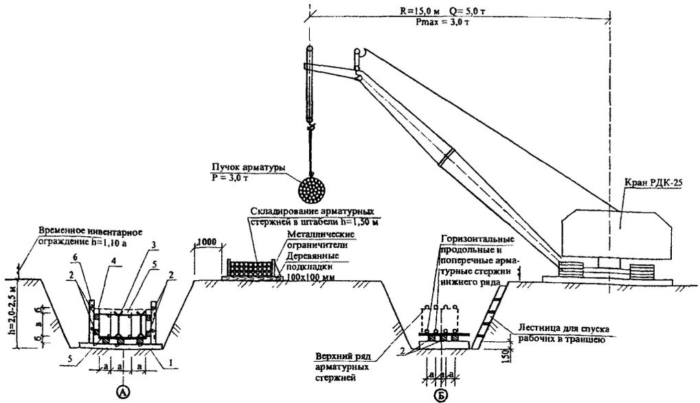
1 – бетонная подготовка; 2 – фиксаторы защитного слоя; 3 – приспособление для раскладки арматурных стержней; 4 – линия поверхности бетона; 5 – защитный слой бетона; 6 – щит опалубки.
