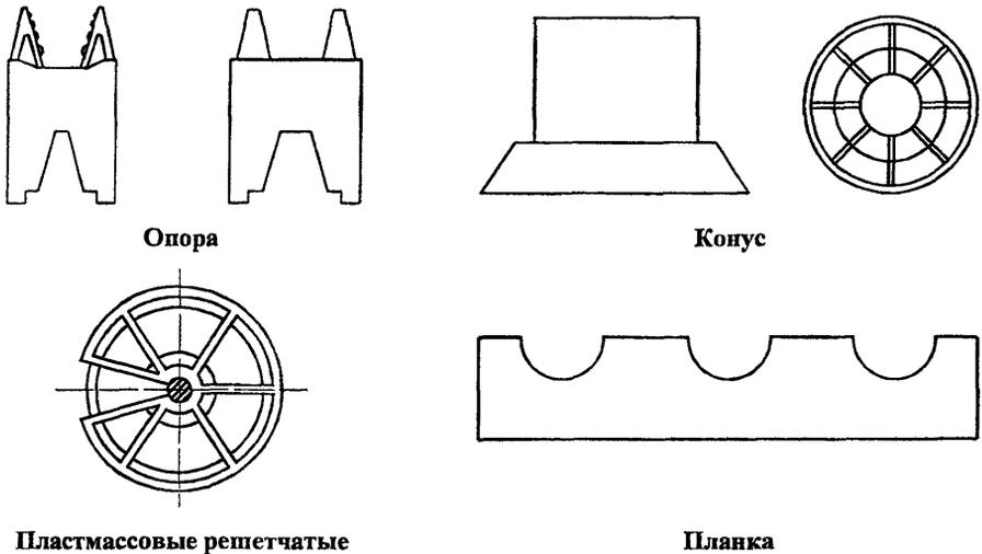
Рисунок 5 – Фиксаторы для обеспечения защитного слоя
