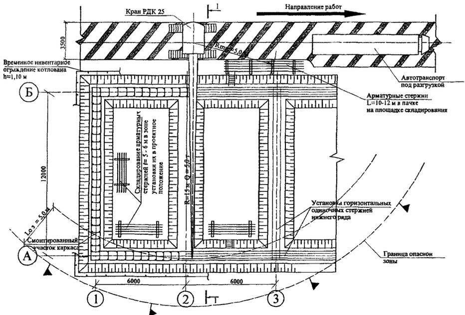
Рисунок 1 – Схема организации работ по установке арматурных стержней
