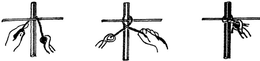
левой рукой проволоку вынимают из пучка и указательным пальцем загибают ее вокруг пересечения стержня, оба конца проволоки захватывают губками кусачек, проворачивая их на два оборота;
