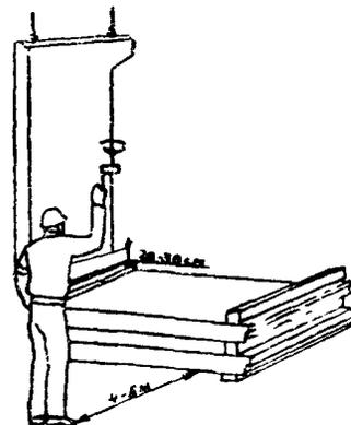
Такелажник поочередно заводит крюки стропа в монтажные петли стенки и, отойдя на 4-5 м, подает команду машинисту крана приподнять стенку на 20-30 см, а затем, убедившись в надежности строповки, подает сигнал поднять и переместить стенку к месту установки
