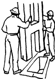
Монтажники  $M_3$  и  $M_4$  принимают колонну на высоте 30 см над стаканом фундамента. По сигналу монтажника  $M_2$  машинист крана плавно опускает колонну, а монтажники  $M_3$  и  $M_4$ , придерживая ее с двух сторон, направляют в стакан фундамента так, чтобы риски на колонне совместились с рисками на стакане. Монтажник  $M_1$  следит за установкой колонны
