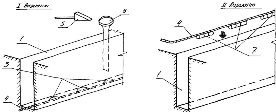
1 - зарядная щель; 2 - компенсирующие щели; 3 - сосредоточенные заряды сыпучих ВВ; 4 - нити детонирующего шнура; 5 - ручной мерник; 6 - воронка; 7 - патроны ВВ; 8 - забоечный материал
