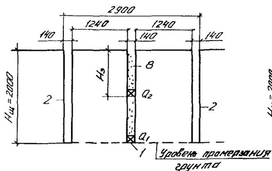
б) глубина траншеи 3,0 м, ширина 3,2 м, глубина промерзания грунта 2,0 м
