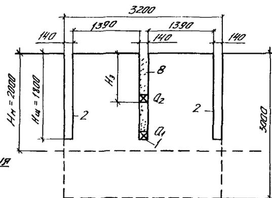
в) глубина траншеи 2,5 м, ширина 3,2 м, глубина промерзания грунта более 2,5 м или вечномёрзлый грунт
