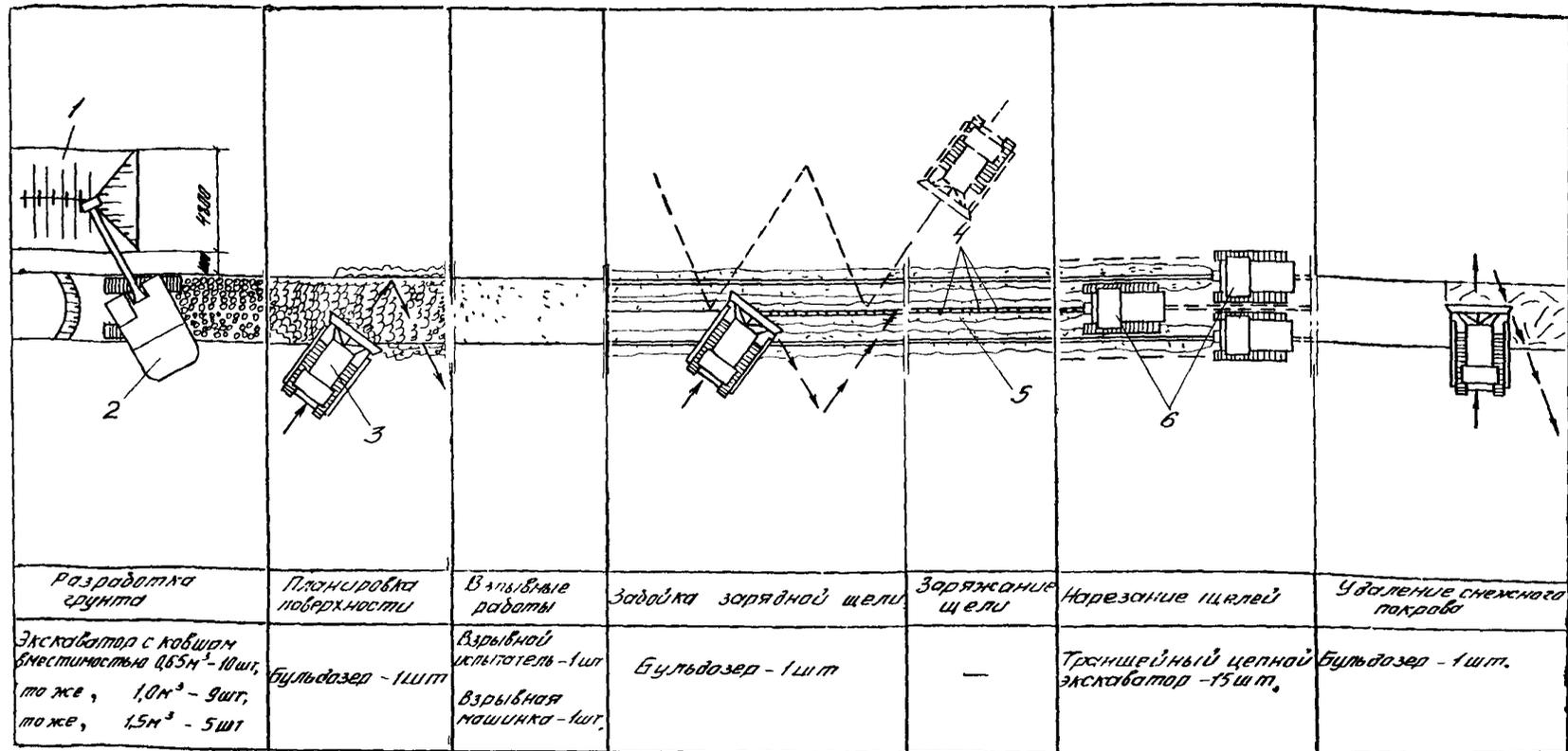
1 - отвал грунта; 2 - экскаватор; 3 - бульдозер; 4 - заряды ВВ;
