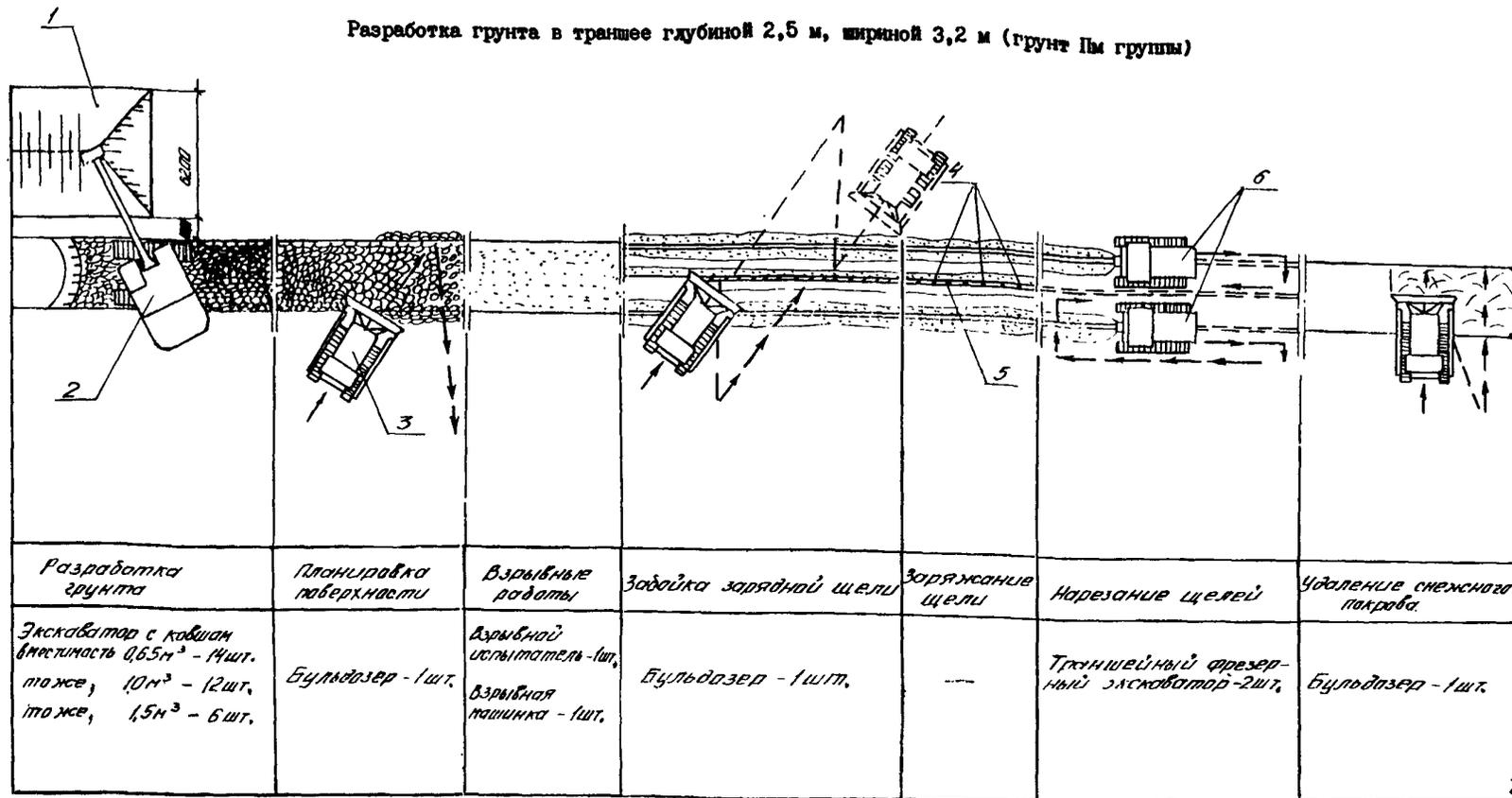
1 - отвал грунта; 2 - экскаватор; 3 - бульдозер; 4 - заряды ВВ;
