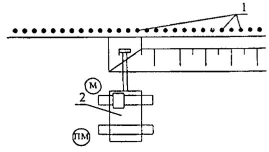
Схема организации рабочего места при разработке участков котла на экскаватором, оборудованным грейфером 1-установленные стальные трубы, 2-экскаватор ЭО-4121, М-машинист экскаватора, ПМ-помощник машиниста экскаватора
