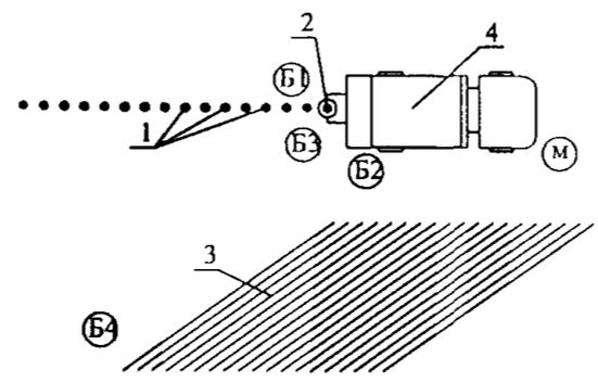
Схема организации рабочего места при установке стальных труб 1-установленные стальные трубы, 2-пробуренная скважина, 3-склад труб, 4-бурильно-крановая машина ЛБУ-50, М-машинист бурильно крановой машины, Б1, Б2, Б3, Б4 бурильщики
