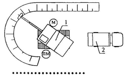
Схема организации рабочего места при разработке котлована экскаватором, оборудованным обратной лопатой 1-экскаватор ЭО-4121, 2-автосамосвал КрАЗ-257, М-машинист экскаватора, ПМ-помощник машиниста экскаватора
