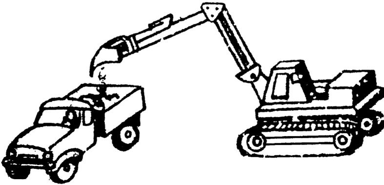
Экскаватор ЭО-4121, оборудованный обратной лопатой, послыно разрабатывает грунт с погрузкой его в транспортное средство.
