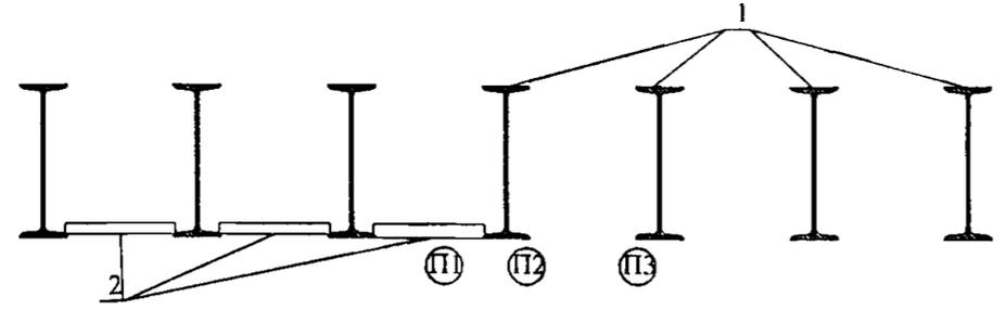
Схема организации рабочего места при устройстве забирки по стальным двутавровым балкам 1-забитые двутавровые балки; 2-установленные доски забирки, 3-склад досок, П1, П2, П3-плотники
