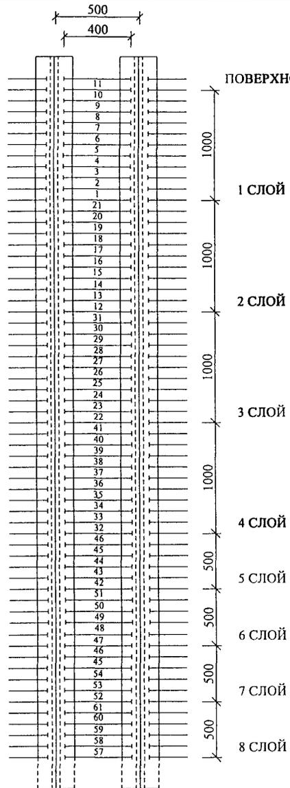
Рисунок 5 - Последовательность установки досок забирки
