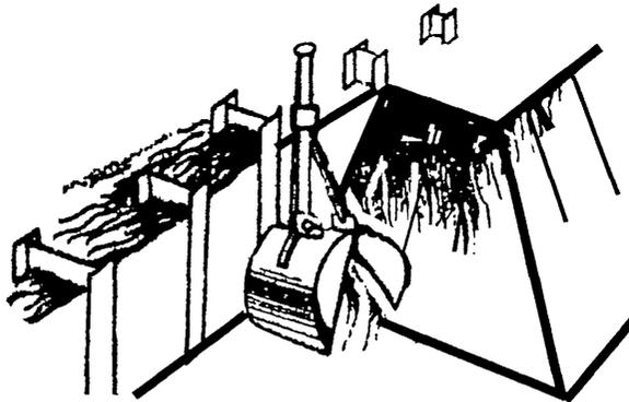
Экскаватор ЭО-4121, оборудованный грейфером, разрабатывает грунт в непосредственной близости от забитых стальных двутавровых балок.
