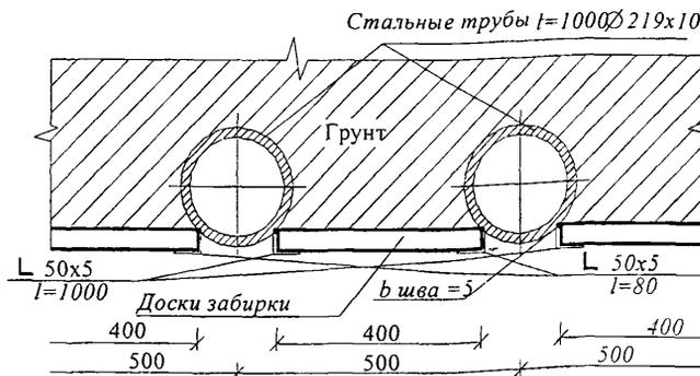
Рисунок 2 - Крепление стенок котлована с применением труб
