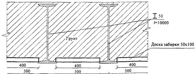
Рисунок 1 - Крепление стенок котлована с применением двутавровых балок
