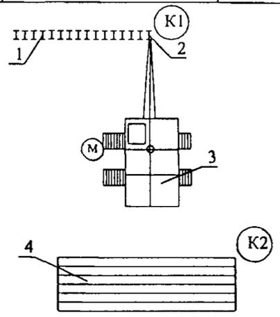
Схема организации рабочего места при забивке двутавровых балок 1-забитые двутавровые балки, 2-забиваемая двутавровая балка, 3-копровая установка на базе экскаватора Э-10011, 4-склад двутавровых балок, М-машинист копровой установки, К1, К2- копровщики
