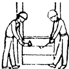
Плотники (П2) и (П3) молотком и монтажным ломом устанавливают доску в проектное положение.
