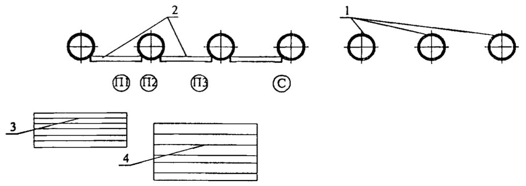
Схема организации рабочего места при устройстве забирки по стальным трубам 1-установленные трубы, 2-установленные доски забирки, 3-склад досок, 4-склад уголков, С-электросварщик, П1, П2, П3-плотники
