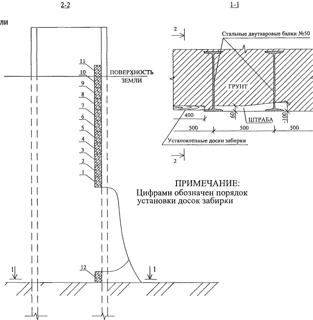
Рисунок 6 - Схема установки досок забирки
