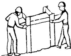
2.7.4 Устройство забирки между двутавровыми балками.
