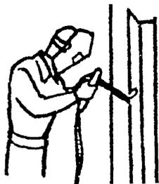
Сварщик (С) приваривает уголок к стальной трубе.
