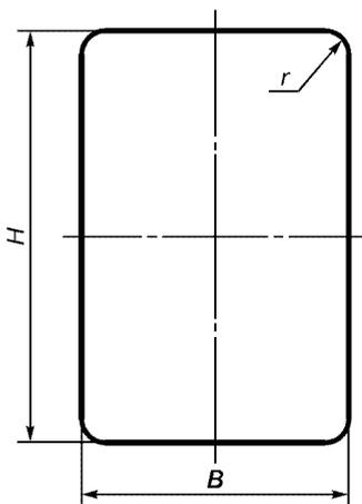
Рисунок Д.7 — Размеры прямоугольных знаков вертикального формата
