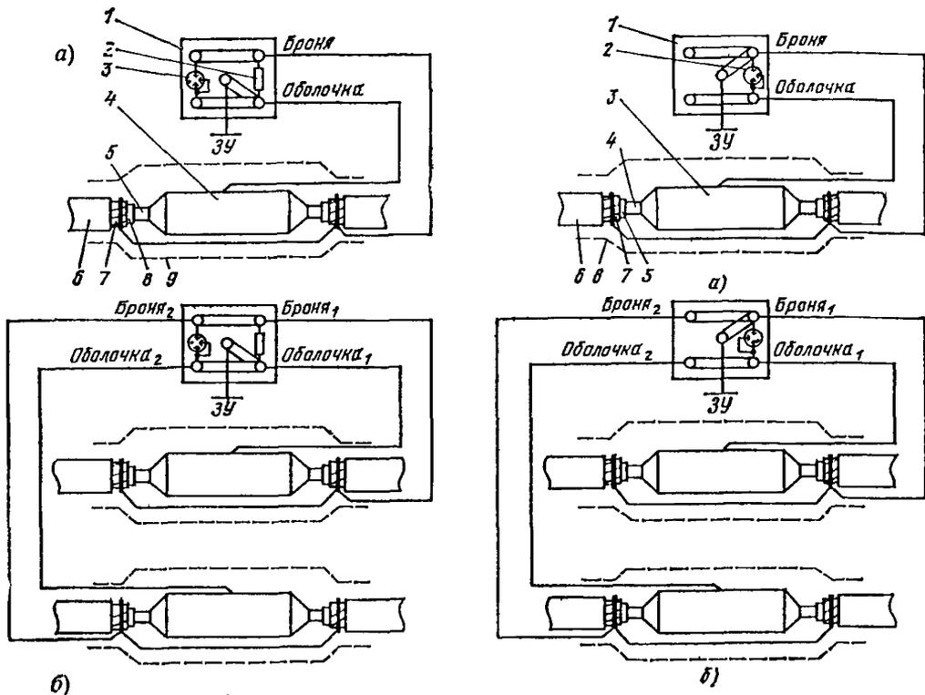
Рис. 3 Схема соединений кабеля, имеющего изолирующие покровы типов Б, Бл, Б<sub>л</sub>, с устройством электрохимической защиты:
