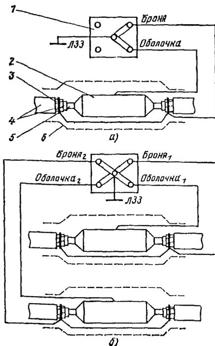
Рис. 1. Схема соединений кабеля, имеющего изолирующие покровы типов Б<sub>л</sub>Ш<sub>л</sub>, с ЛЗЗ:
