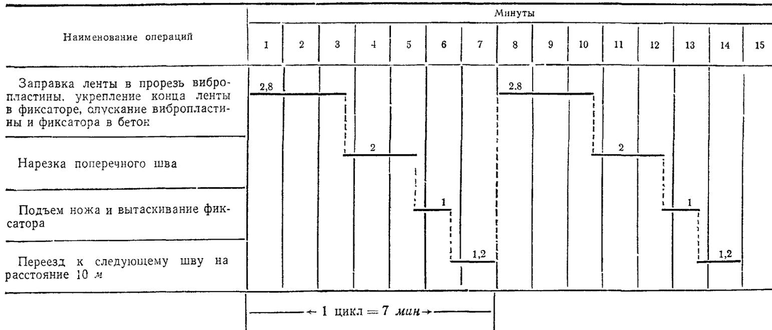
Производительность нарезчика в час:  $\Pi_{\text{час}} = \frac{60 \cdot 7,5}{7} = 64,3 \text{ м швов}$
