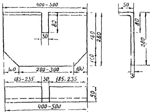
Рис 2. Металлический щиток с прорезью (переносная опалубка)
