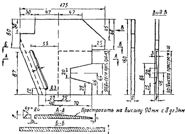
Рис. 3. Чертеж вибропластины
