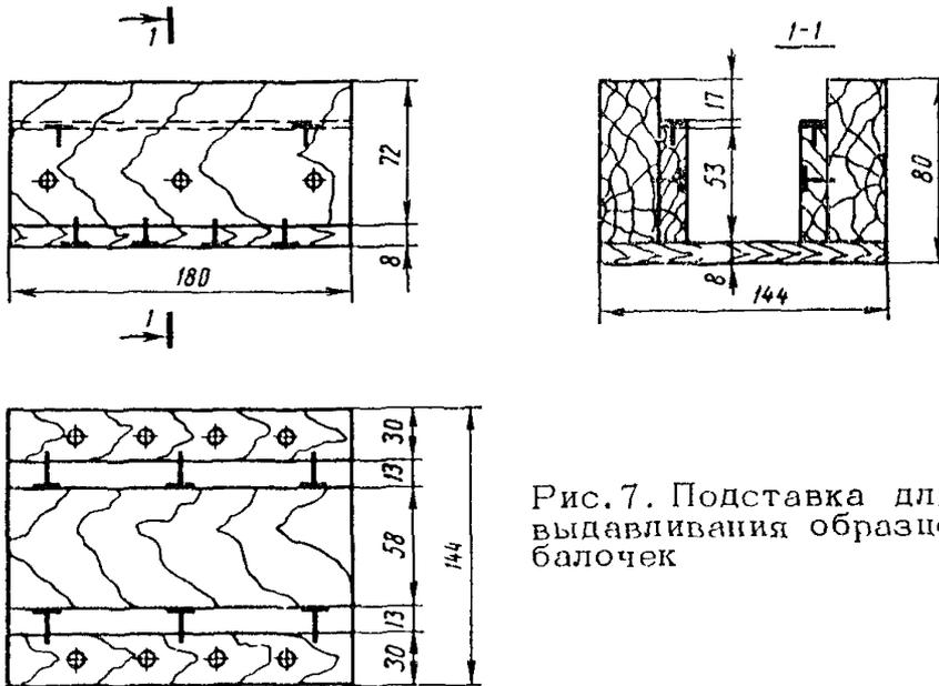
Рис. 7. Подставка для выдавливания образцов-балочек
