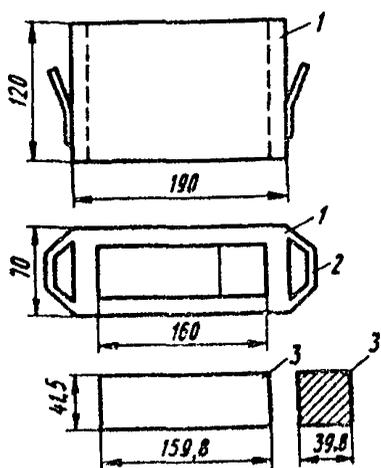
Рис. 5. Форма для изготовления образцов-балочек: 1 - корпус; 2 - ручка; 3 - вкладыш
