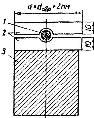
Рис.9. Схема шарнирного устройства: 1 - шарик стальной диаметром 6-8 мм; 2 - металлические пластинки диаметром  $d$ ; 3 - образец укрепленного грунта диаметром  $d_{обг}$
