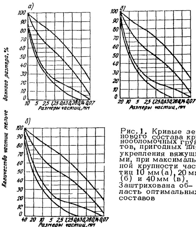
Рис.1. Кривые зернового состава крупнообломочных грунтов, пригодных для укрепления вяжущими, при максимальной крупности частиц 10 мм (а), 20 мм (б) и 40 мм (в). Заштрихована область оптимальных составов
