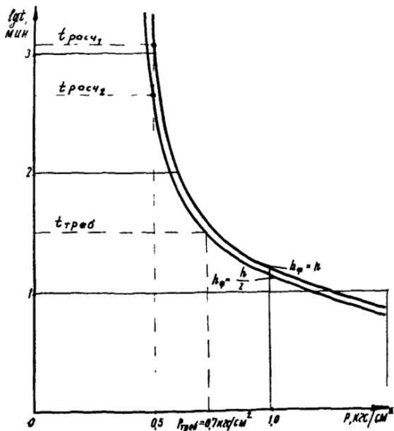
Рис.2. Зависимость времени достижения  $\lambda_{расч} = 0,3$  от нагрузки
