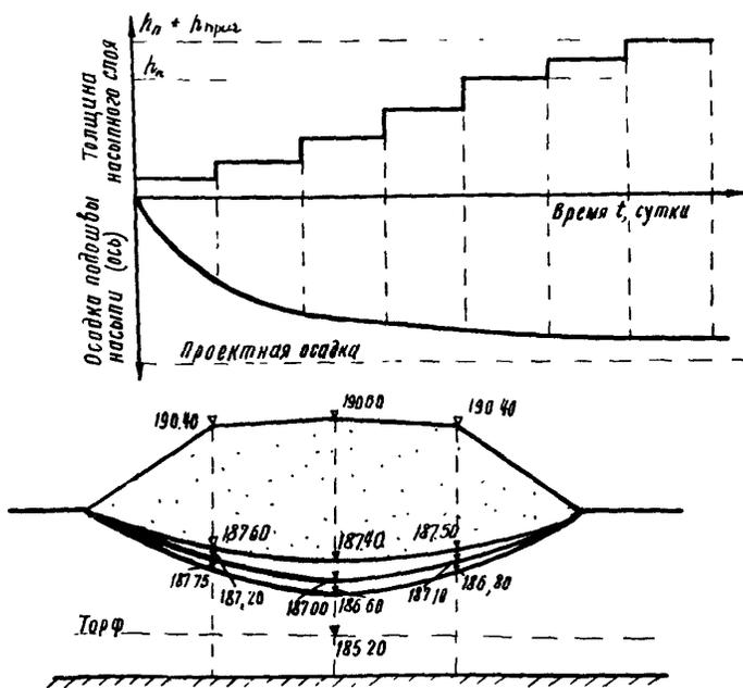
Рис.4. Регистрация положения подошвы насыпи по результатам нивелировки
