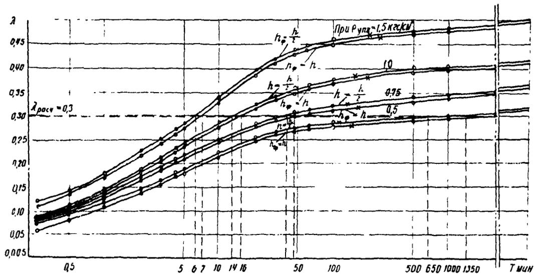
Рис.1. Кривые консолидации  $\lambda = f(\epsilon_q T)$  (торф с участка автомобильной дороги Москва-Игга при  $h = 2 \text{ см}$ )
