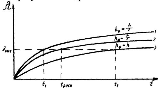
Рис.3. Расчетные кривые консолидации для определения консолидационных характеристик: 1-двустороннее отжатие воды; 2-то же; 3-одностороннее отжатие воды
