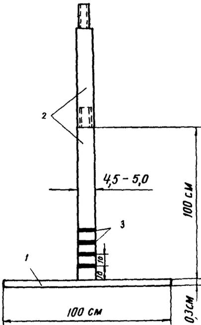
По мере роста осадки и толщины насыпного слоя трубу наращивают последовательно навинчивая метровые отрезки, одновременно маркируя их масляной краской 3.
