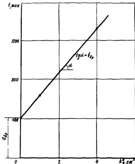
Рис.3. Зависимость времени достижения расчетной относительной деформации от квадрата высоты образца
