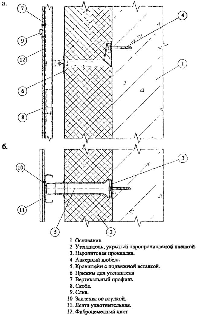
Рис. 3 14 Фасадная система "Диат" СД-04
