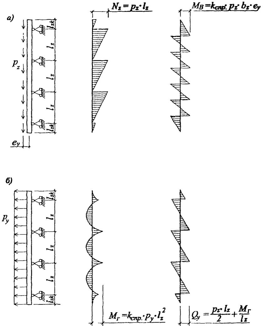
Рис. 6.2. Расчетные схемы вертикальной направляющей:
