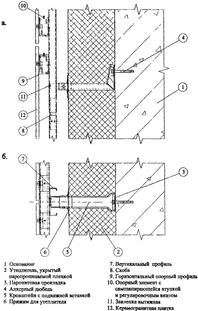
Рис. 3 11 Фасадная система "Диат" СД-02
