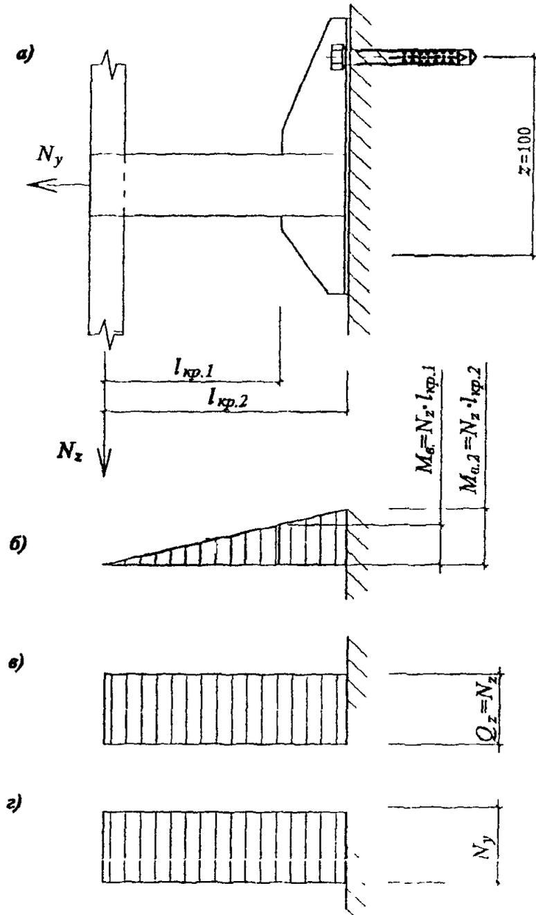
Рис. 6.3. Расчетная схема кронштейна:
