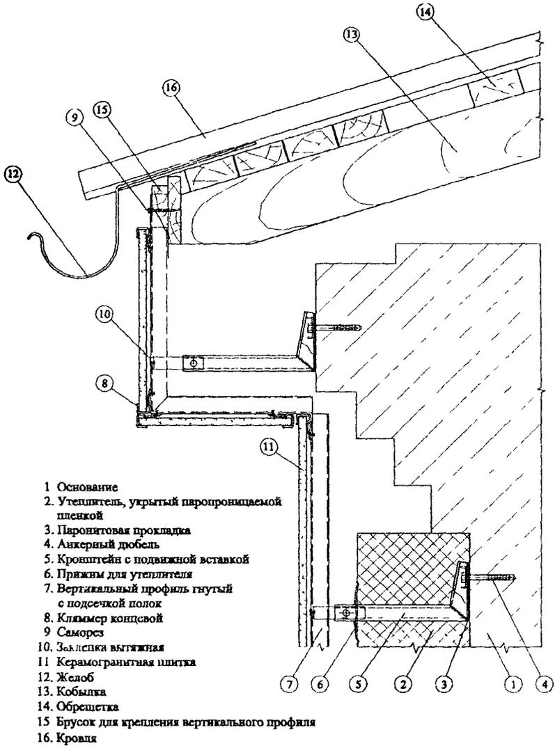
Рис. 3.28. Фасадная система "Диаг" СД-01 у карниза
