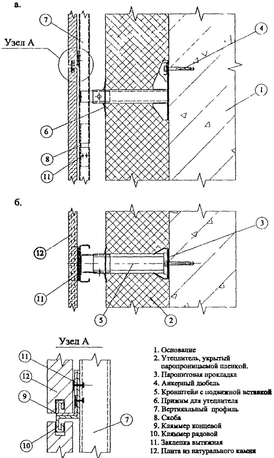
Рис. 3.16. Фасадная система "Диаг" СД-05
