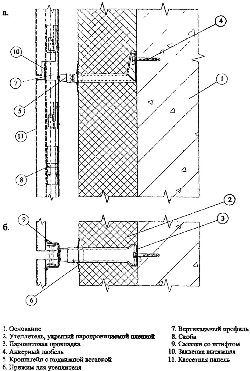
Рис. 3.13. Фасадная система "Дият" СД-03
