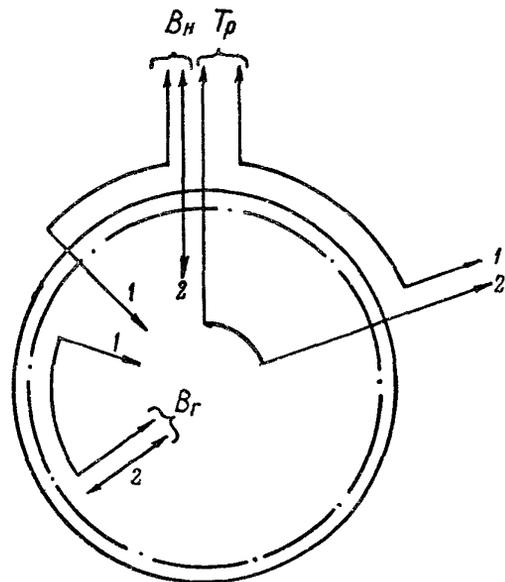
Рис.4. Принципиальная схема распределения в крупном городе автомобильных потоков: внегородских ( $B_H$ ), внутригородских ( $B_r$ ), транзитных ( $T_p$ ) с выходом на кольцевую дорогу (1) и без выхода на нее (2):
