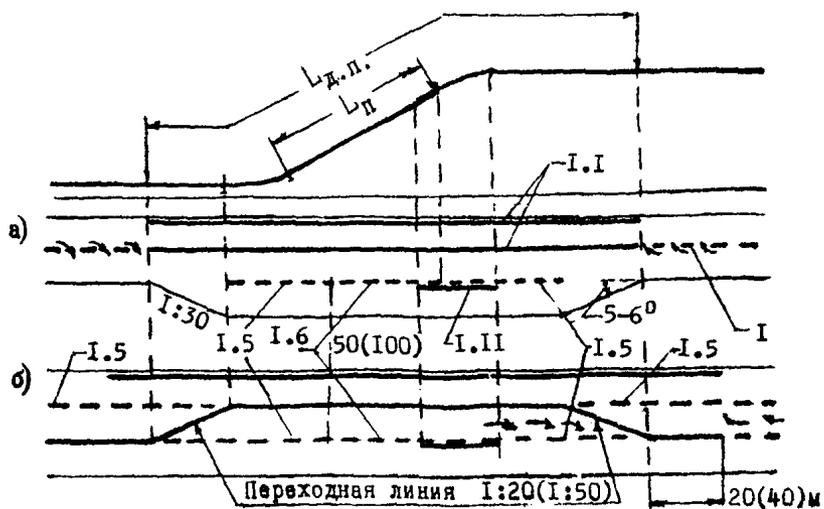
Рис. 5.5. Разметка проезжей части на подъёмах автомобильных дорог при наличии дополнительных полос:
