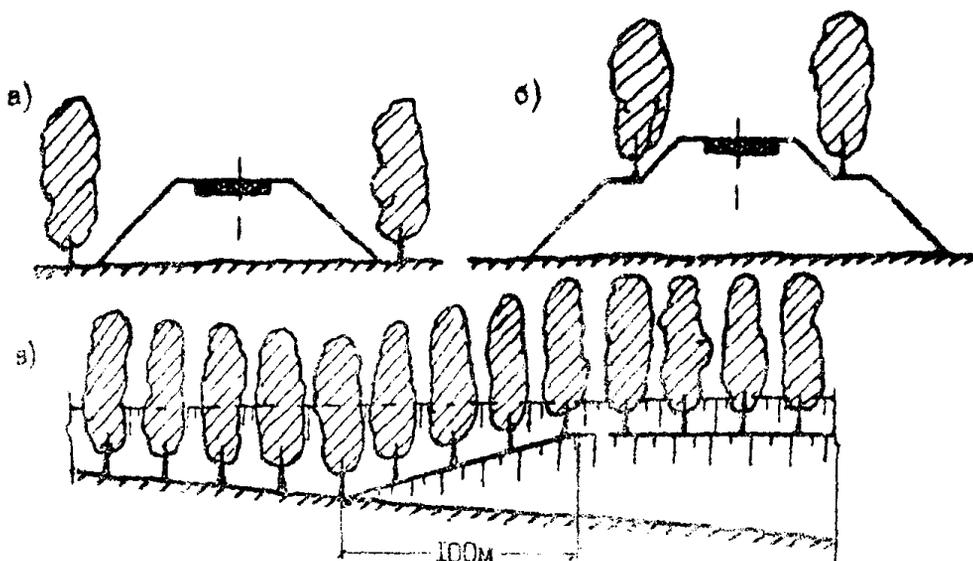
Рис. 3.8. Озеленение высоких насыпей: а - при высоте 6-8м; б - при высоте более 10м; в - устройство бермы при переходе от насыпи высотой до 8м к новым высотам более 10м.
