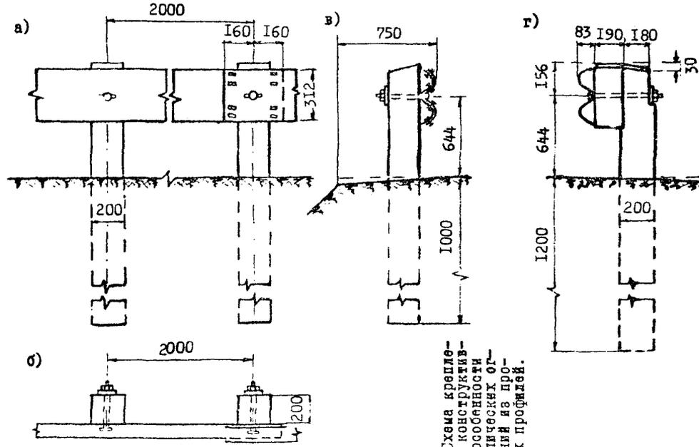
ю. 6.1. Схема крепления и конструктивные особенности металлических соединений из прокатных профилей.
