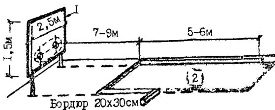
Рис. 3.22. Площадка для регулирования фар автомобилей определенных типов:
