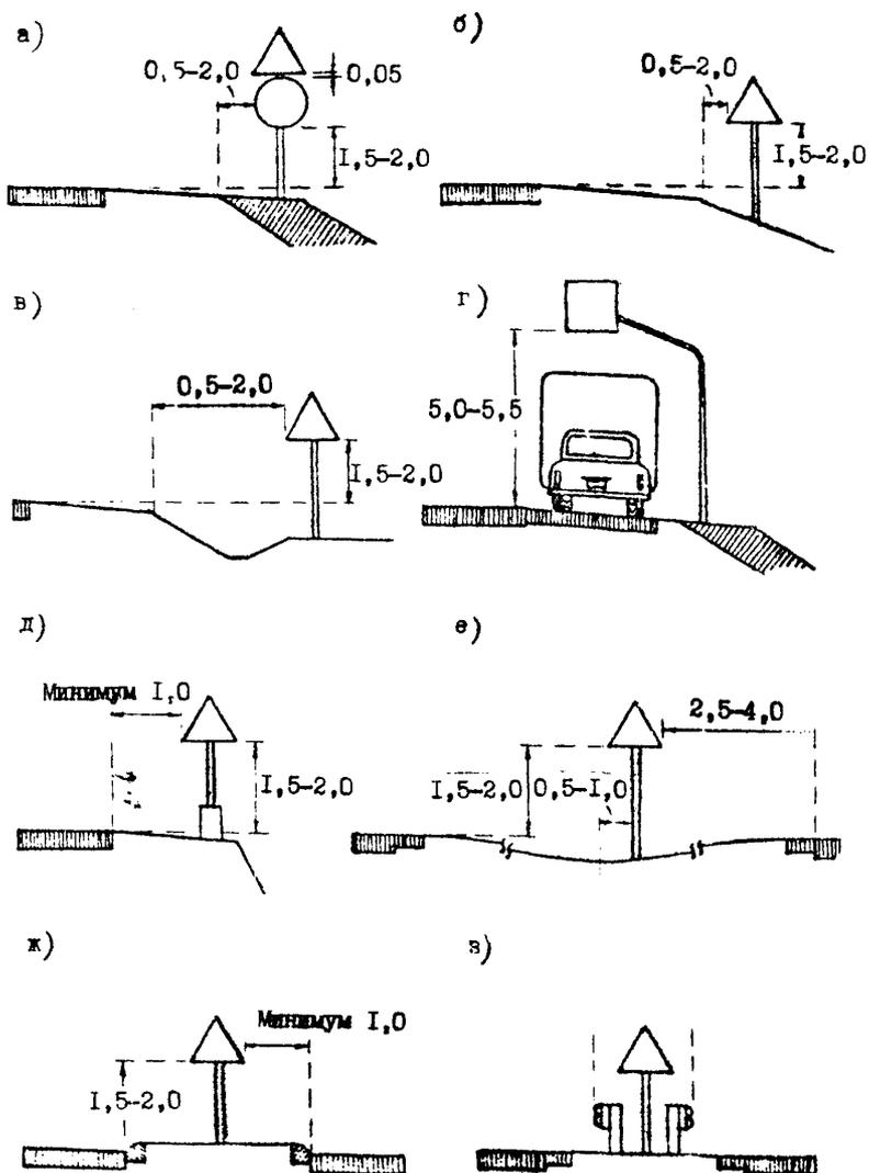
Рис. 4.2. Способы установки знаков на автомобильных дорогах.
