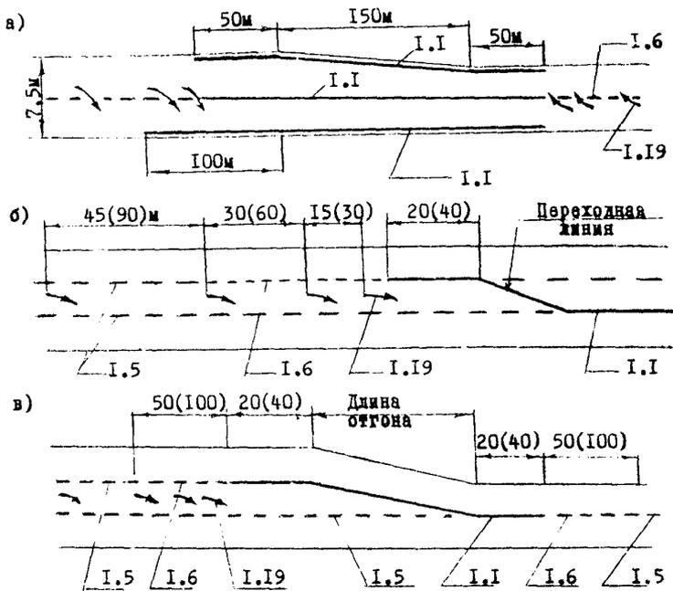
Рис. 5.19. Схемы разметки проезжей части на участках сужений:
