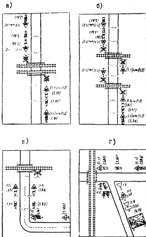
Рис. 5.23. Схемы расстановки знаков на железнодорожных переездах:
