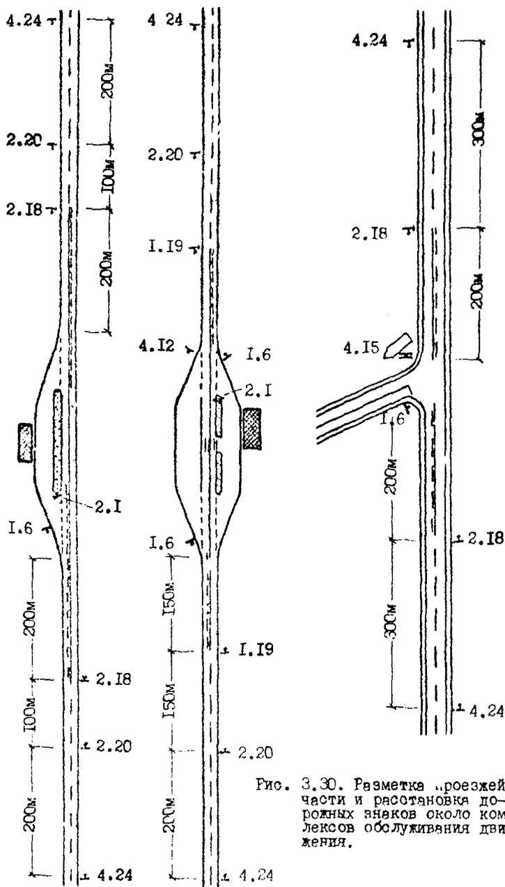
Рис. 3.30. Разметка проезжей части и расстановка дорожных знаков около комплексов обслуживания движения.
