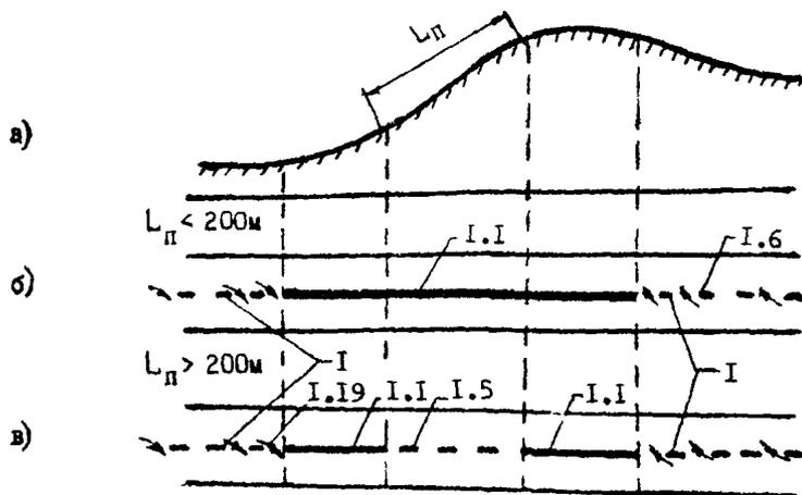
Рис. 5.4. Разметка проезжей части на подъёмах автомобильных дорог с обеспеченной видимостью при отсутствии дополнительной полосы для движения на подъёмах:
