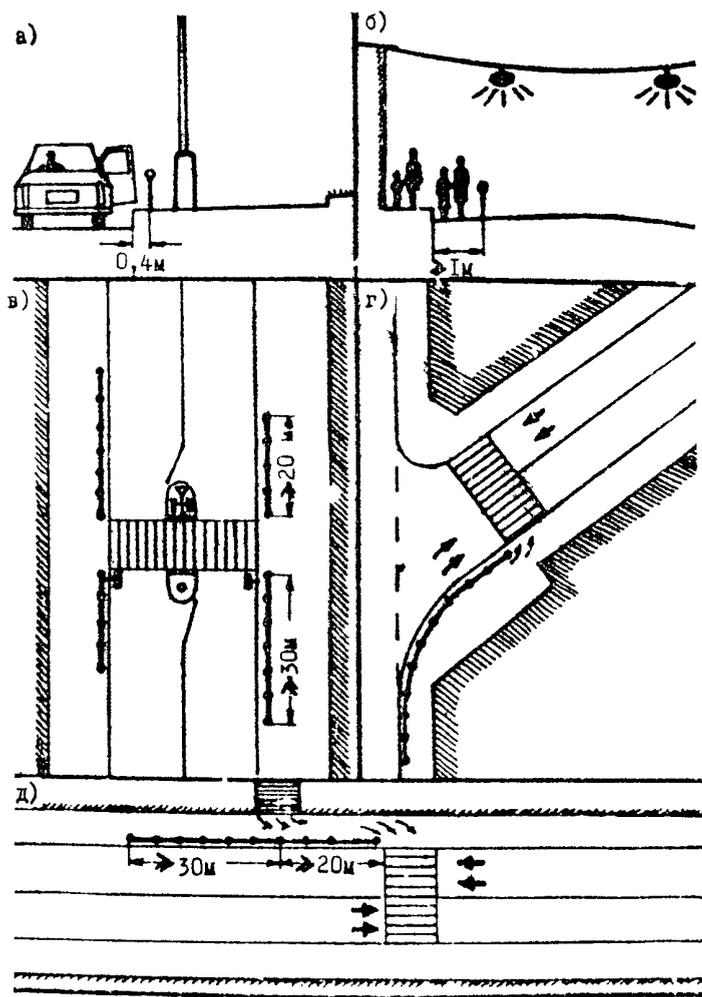
Рис. 6.4. Установка пешеходных ограждений в населённых пунктах.
