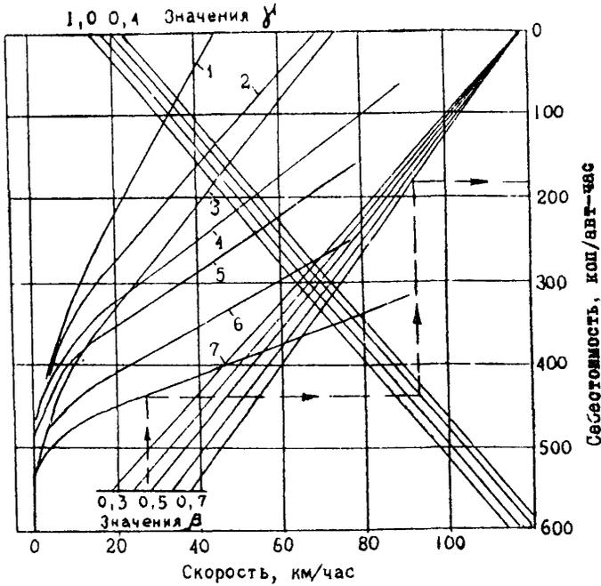
Рис. 8.5. Номограмма для определения себестоимости I авт-часов транспортной работы. Автомобили:
