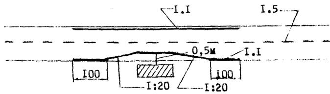
Рис. 5.20. Разметка проезжей части на участке с близко расположенным соковы и препятствием.
