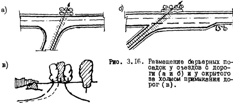
Рис. 3.16. Размещение барьерных посадок у съездов с дороги (а и б) и у скрытого за холмом примыкания дорог (в).
