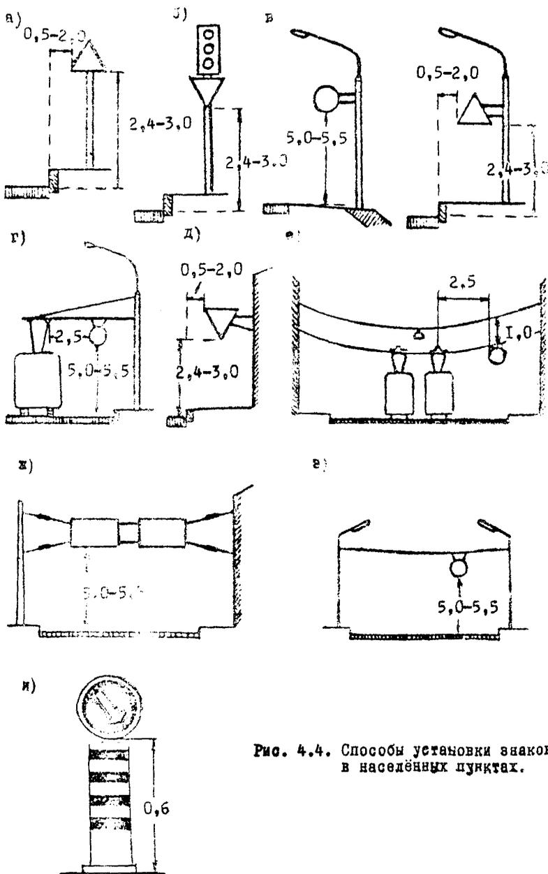
Рис. 4.4. Способы установки знаков в населённых пунктах.
