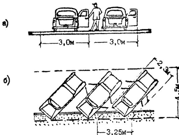
Рис. 3.20. Размеры места стоянки при косо́й установке автомобиля.
