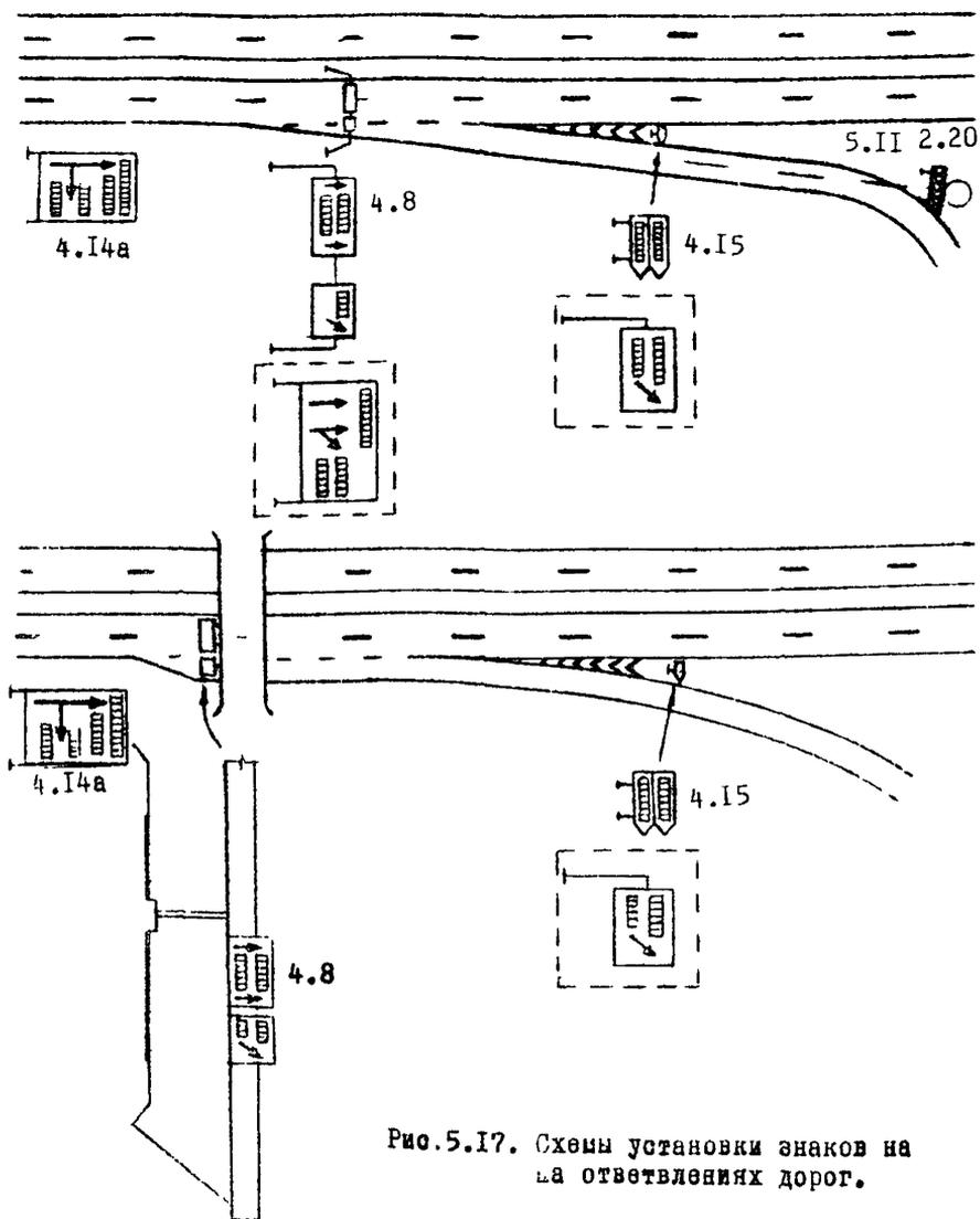
Рис.5.17. Схемы установки знаков на ответвлениях дорог.
