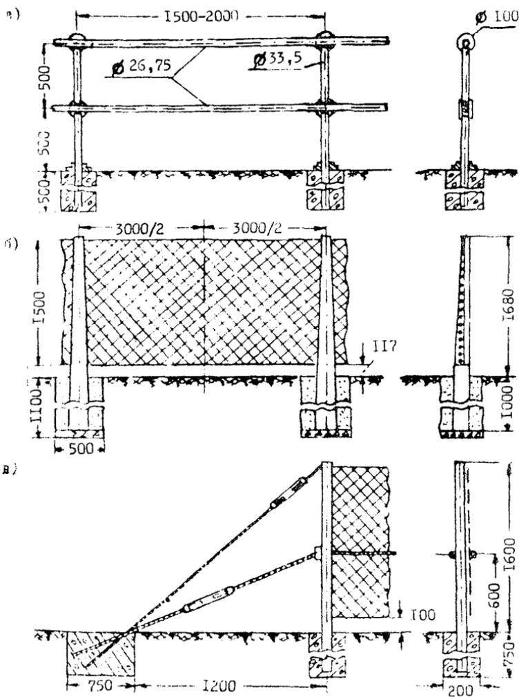
Рис. 6.3. Конструктивные особенности пешеходных ограждений на автомобильных дорогах.
