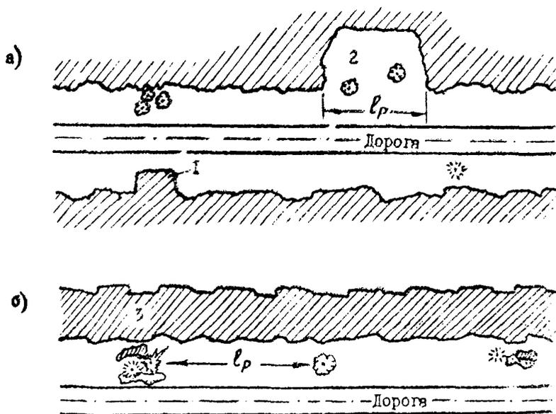
Рис. 3.11. Приемы устранения монотонности вида дороги: а - в лесной просеке; б - при расположении вдоль дороги аллеяных снегозадерживающих посадок; 1 - искусственно устроенный выступ леса; 2 - расчистка растительности; 3 - полоса посадок.
