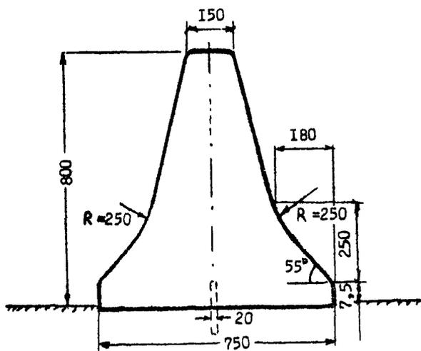
Рис. 6.6. Конструкция железобетонного ограждения парапетного типа.
