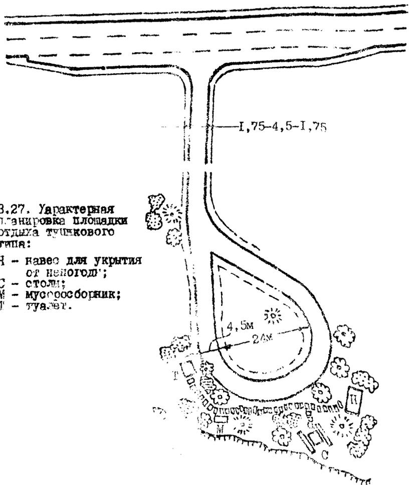
Рис. 3.27. Ураактерная планировка площадки отдыха тупикового типа:
