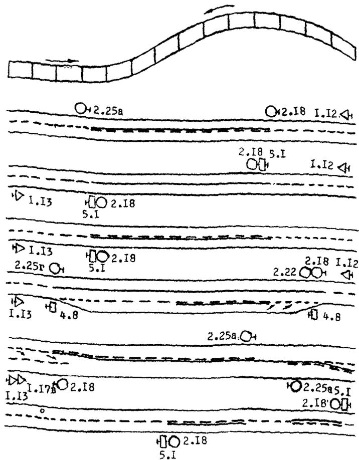
Рис. 5.7. Схемы установки знаков на подъёмах и опусках.
