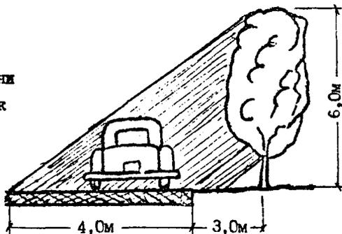
установки автомобилей. Посадка деревьев (желательно мелколистных, высокоштабных) или использование имеющихся насаждений, возможны как по контуру площади стоянки, так и на небольших островках, которые предпочтительнее, особенно на больших стоянках (рис. 3.24).
