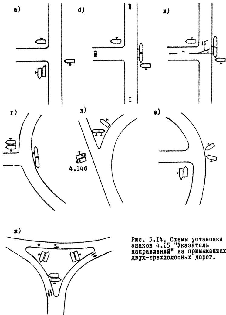
Рис. 5.14. Схемы установки знаков 4.15 "Указатель направлений" на примыканиях двух-трехполосных дорог.
