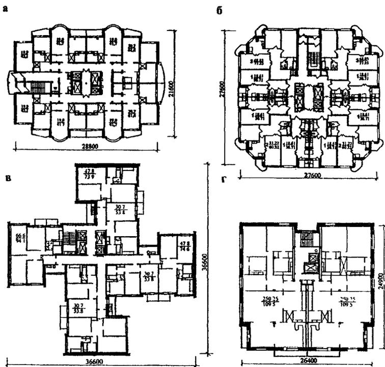
Рис 5. Примеры планировочных решений односекционных жилых домов
