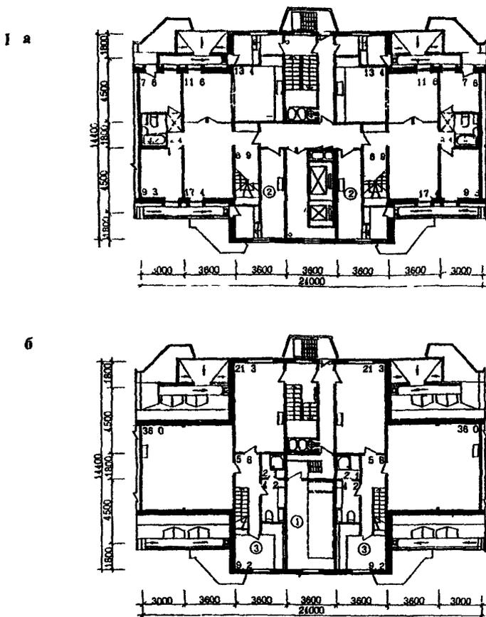
Рис 35 (стр 94 95) Примеры примыкания квартир к машинному помещению лифтов в жилых домах нового строительства и реконструируемых
