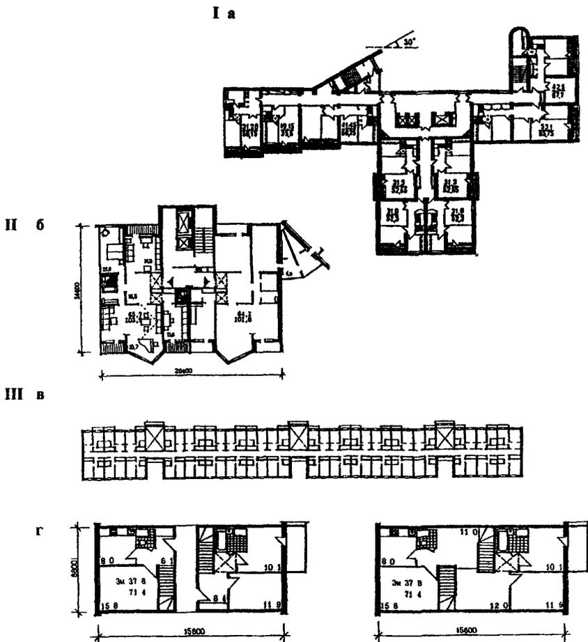
Рис.9. Примеры планировочно шумозащищенных решений в жилых зданиях.
