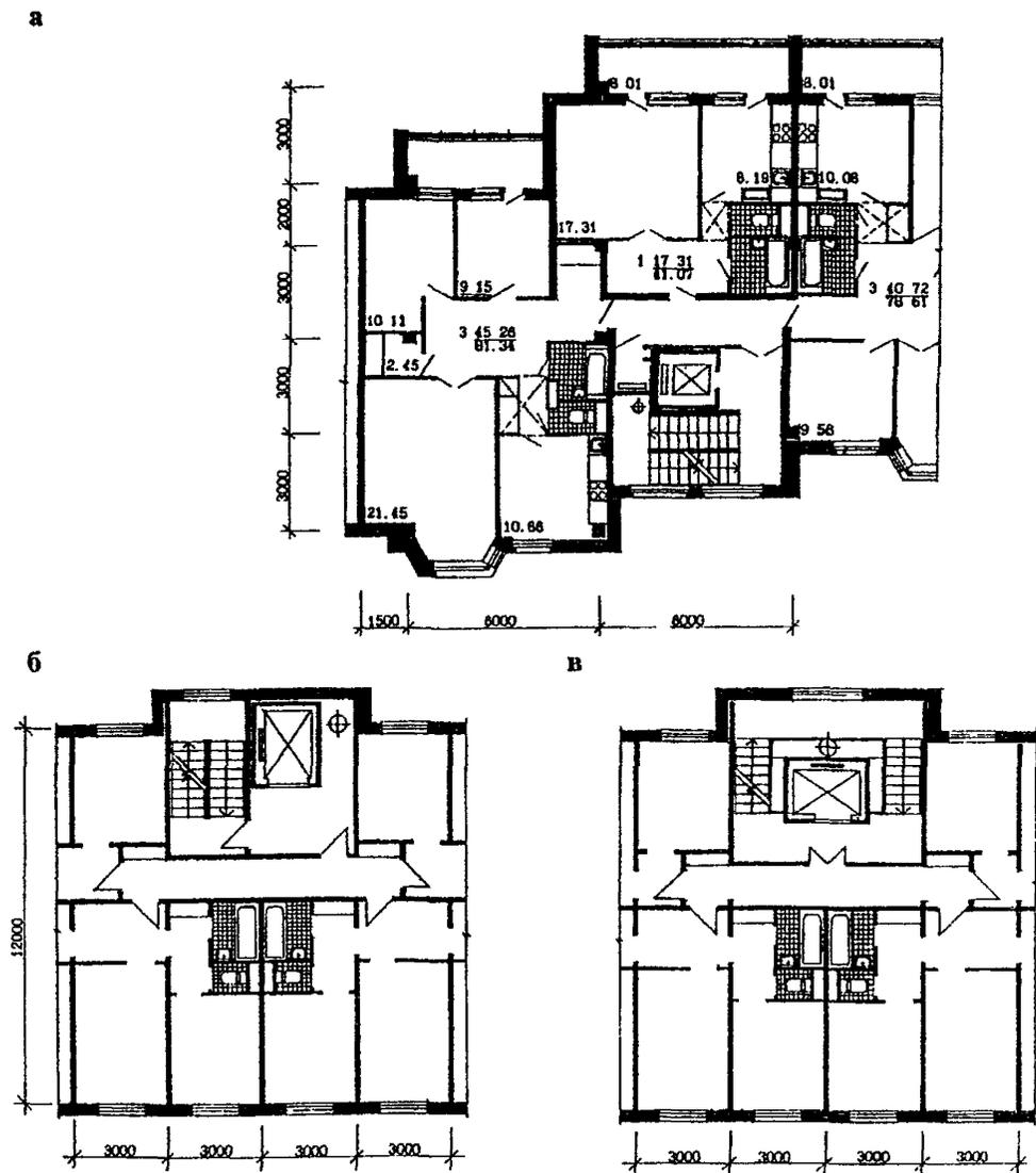
Рис.21. Примеры секций с обычной лестничной клеткой типа Л1.
