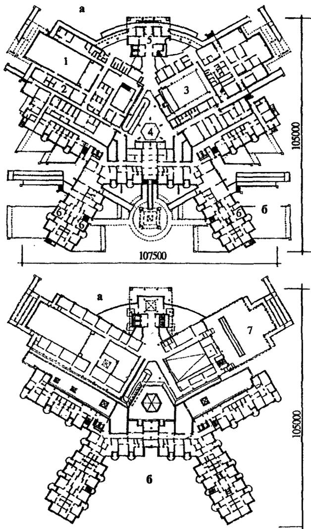
Рис.56. Помещения обслуживания в составе жилого комплекса с обслуживанием и центром реабилитации для молодых инвалидов (МНИИТЭП, М2, стадия «проект». Архитекторы: В.Дадья и А.Поletaев). План 1 и 2 этажей. Условные обозначения: а - жилая часть; б - общественная часть; 1 - спортивный зал; 2 - раздевалка; 3 - актовый зал; 4 - рекреации; 5 - коммуникационный узел блока обслуживания; б - квартиры для семьи с инвалидом-колясочником; 7 - терраса.
