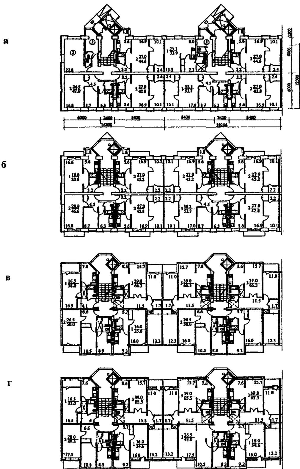
Рис.12. Проект реконструкции 5-этажных жилых домов серии 1-511 (ОАО ЦНИИЭП жилища):
