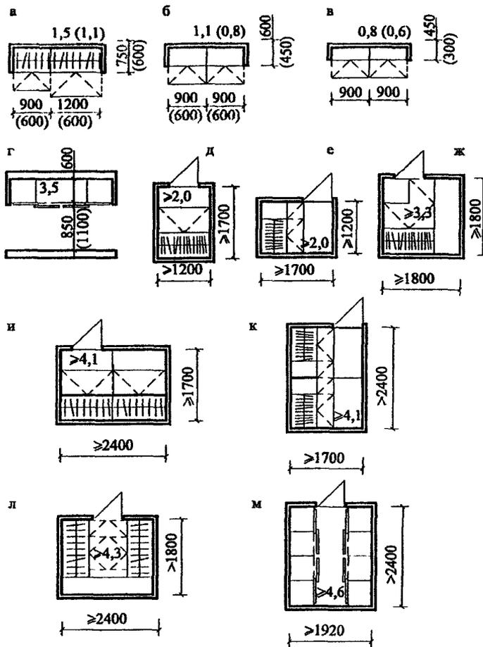
Рис.44. Примеры решения встроенных шкафов, кладовых и гардеробных.
