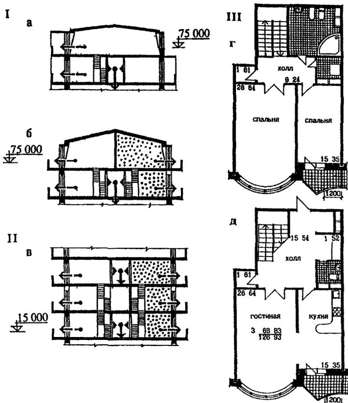
Рис 24 Пути эвакуации в многоуровневых квартирах
