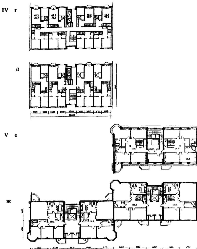
IV – шестиквартирная секция универсальной ориентации с двухуровневыми квартирами (ГУП МНИИТЭП, ЛТЖС, проектное предложение. Архитекторы: С.Яхкинд и И.Генкина): г, д - планы этажей, V – двухквартирные секции универсальной ориентации в жилом доме по 1-му Колобовскому пер., вл.18-24 (ГУП Моспроект-2, М18. Руководитель авторского коллектива М.Посохин, архитекторы М.Плеханов и А.Левитина): е, ж – планы этажей.
