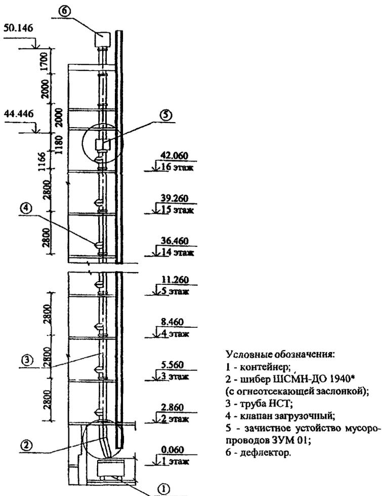
Рис.37. Пример устройства прочистки, промывки и дезинфекции с системой пожаротушения в стволе мусоропровода на примере 16-этажного жилого здания (ГУП МНИИТЭП):
