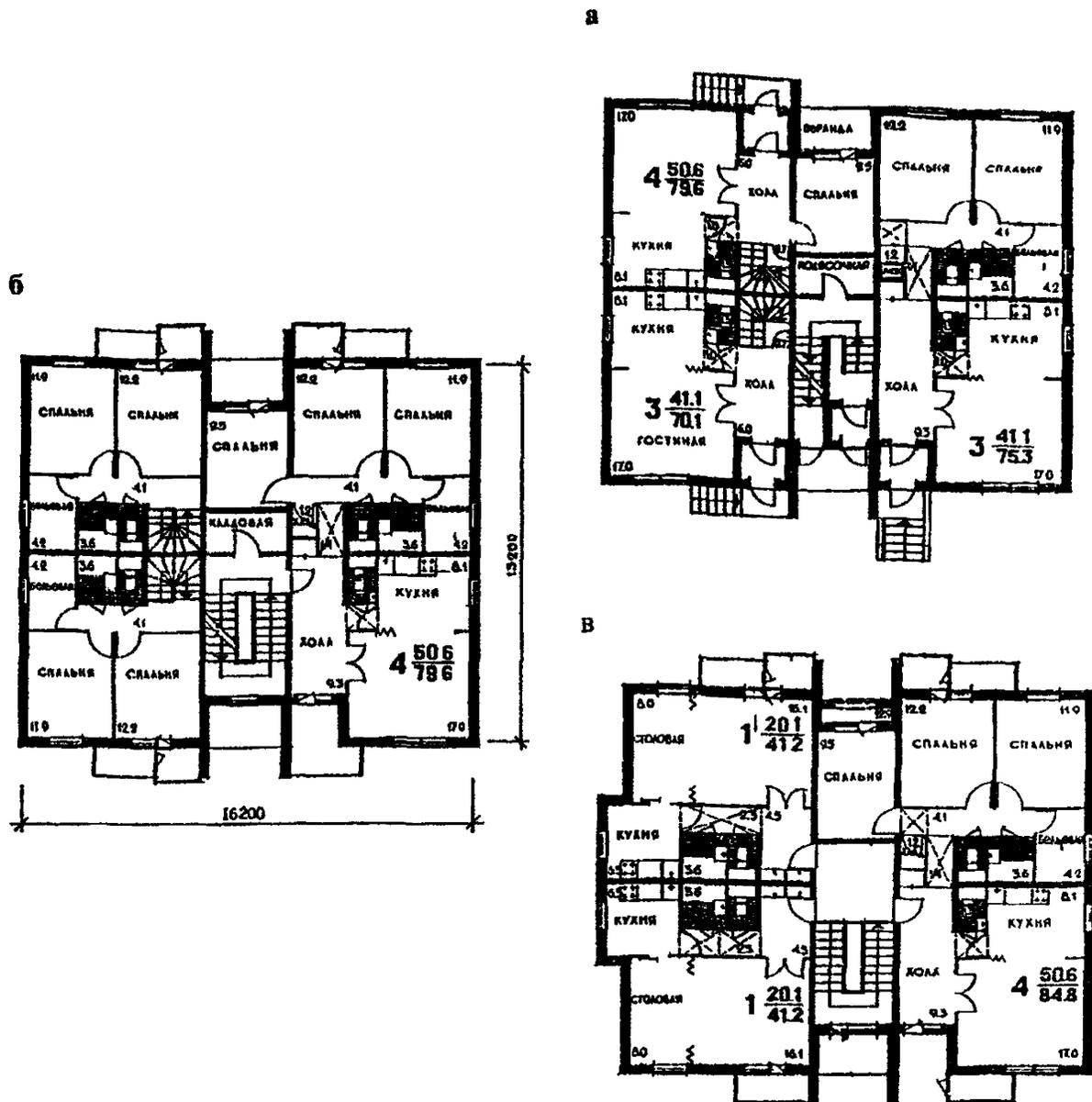
Рис.8. Секционно-блокированный жилой дом (Научно-архитектурный центр жилищного строительства Госкомархитектуры, проектное предложение Архитекторы: Н.Кордо, Н.Сидлерова, Т.Берсенева и другие):
