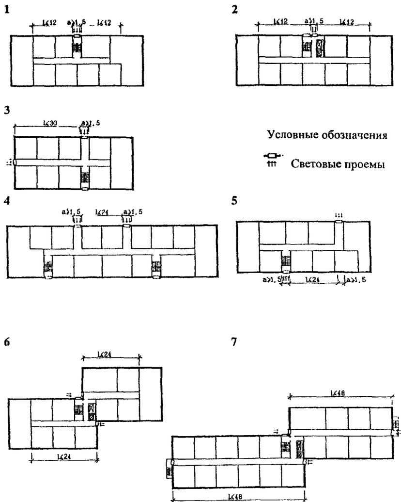
Рис.15. Предельная длина внеквартирных ( $L$ ) коридоров и ширина световых карманов ( $a$ ) по условиям естественного освещения: 1 - через лестничную клетку; 2 - через лифтовой холл; 3 - с торца коридора и через световой карман (в том числе холл, лифтовой холл, лестничную клетку); 4, 5 - через световые карманы (в том числе холлы, лифтовые холлы, лестничные клетки); 6 - с одного торца коридора; 7 - с двух торцов коридора.
