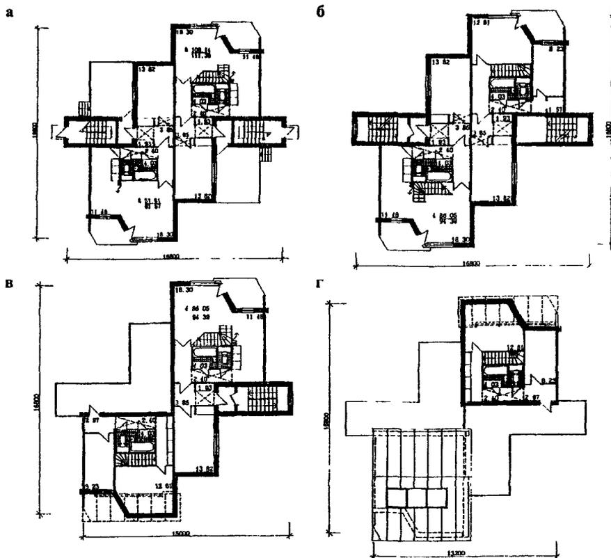
Рис.3. Четырехэтажный блокированный жилой дом из сборного железобетона со сложной системой блокировки квартир (МНИИТЭП, М4, проектное предложение. Архитекторы В.Датюк, Е.Староносова и другие):
