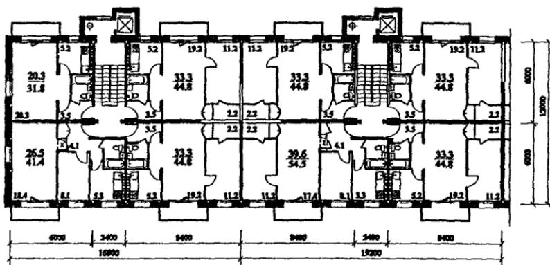
Рис.11. Проектное предложение по модернизации 5-этажных жилых домов серии 1-515 (ГУП МНИИТЭП, ЛФР. Архитекторы: Б.Дмитриев, Н.Бурмистрова): а - план 1 этажа; б - план типовых этажей.
