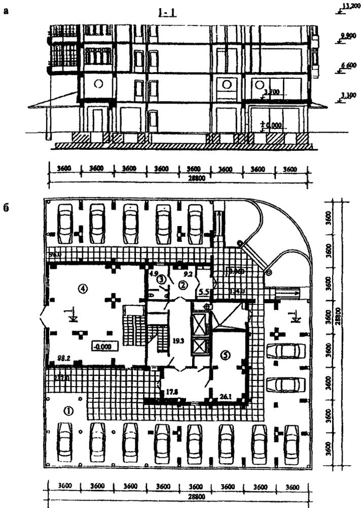
Рис.31. Пример размещения открытой автостоянки под многоквартирным жилым домом серии «Юбилейный» (ГУП МНИИТЭП, М1. Архитекторы: Ю.Григорьев, А.Надысев и др.).
