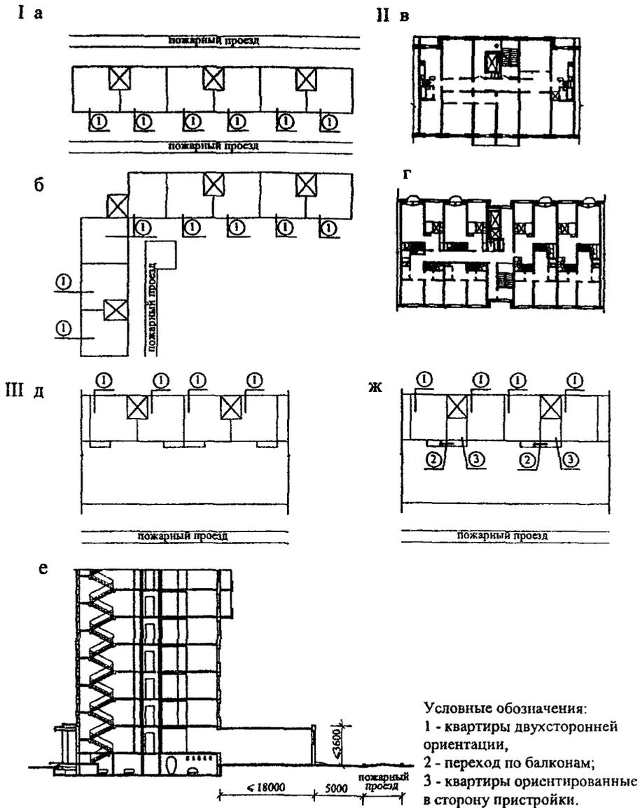
Рис.18. Проезды пожарных автомашин к фасадам жилых домов.
