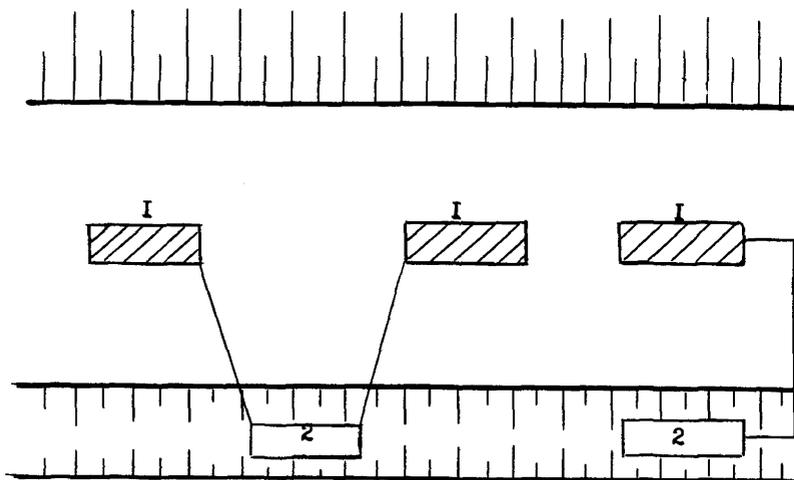
Зигзагообразная схема перемещения грунта из бокового резерва в насыпь: 1 – разгрузка грунта; 2 – набор грунта.
