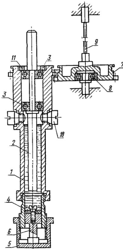
б) Термостат, обеспечивающий поддержание температуры в пределах от минус 60° до 100° С с точностью  $\pm 0,1^\circ$  С.
