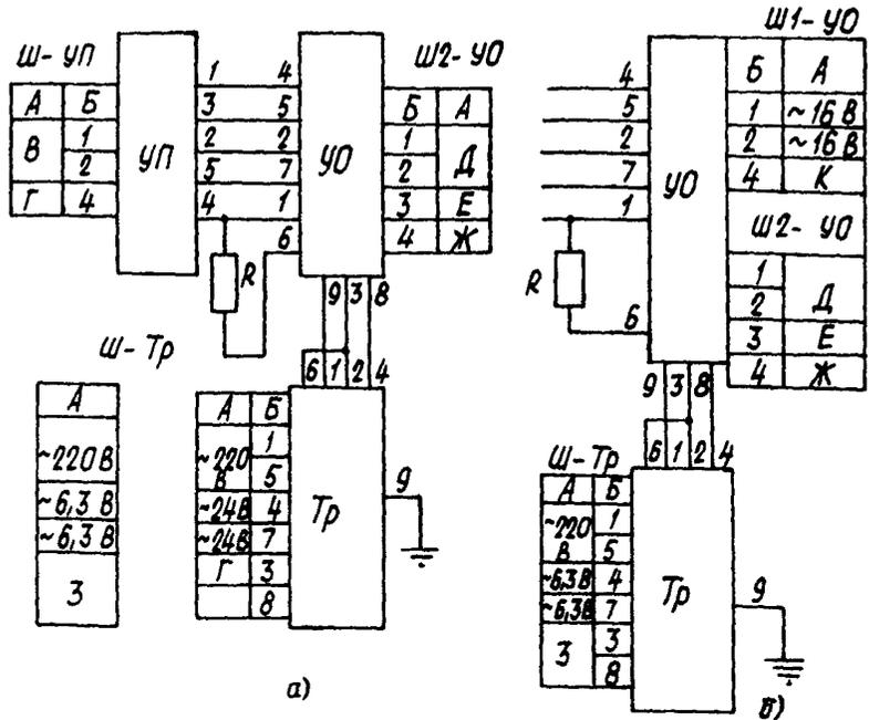
Рис. 7. Схема соединений блоков в усилителе:
