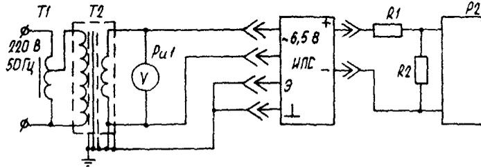
Рис. 8. Схема проверки выходного напряжения ИИСЗ:
