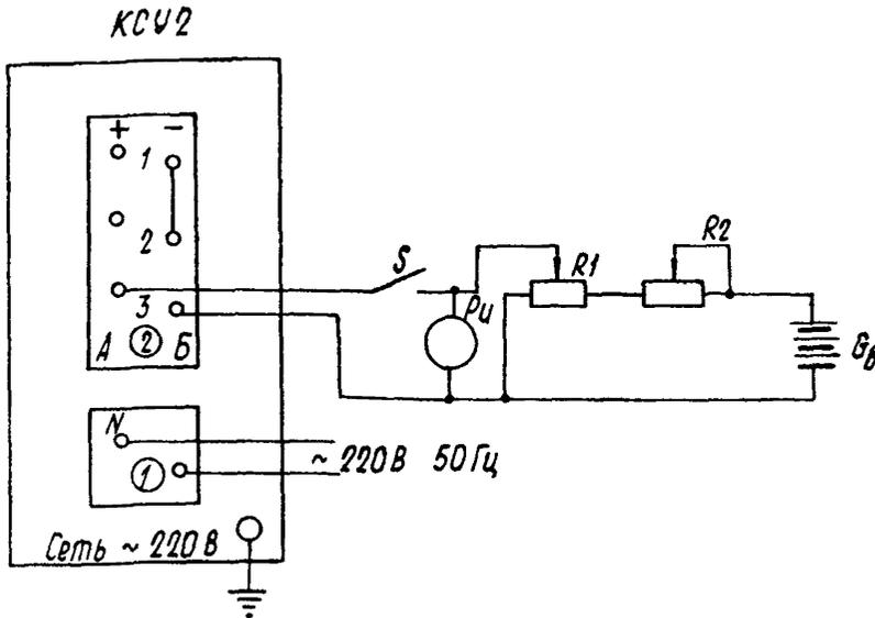
Рис. 5. Схема проверки прибора КCV2 (вольтметра):
