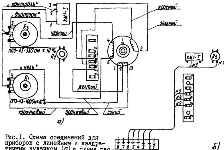
Рис.1. Схема соединений для приборов с линейным и квадратным кулачком (а) и схема распайки жгута с вилкой к дифференциально-трансформаторному блоку (б)
