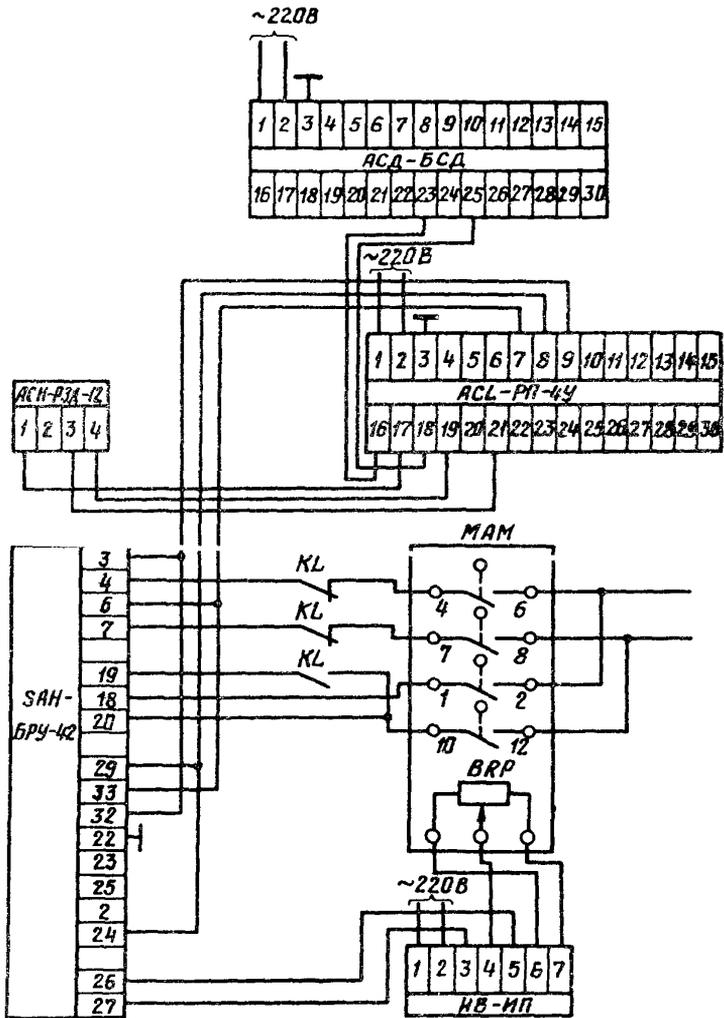
Рис. III.3. Реализация АСР питания на аппаратуре АКЭСР-2
