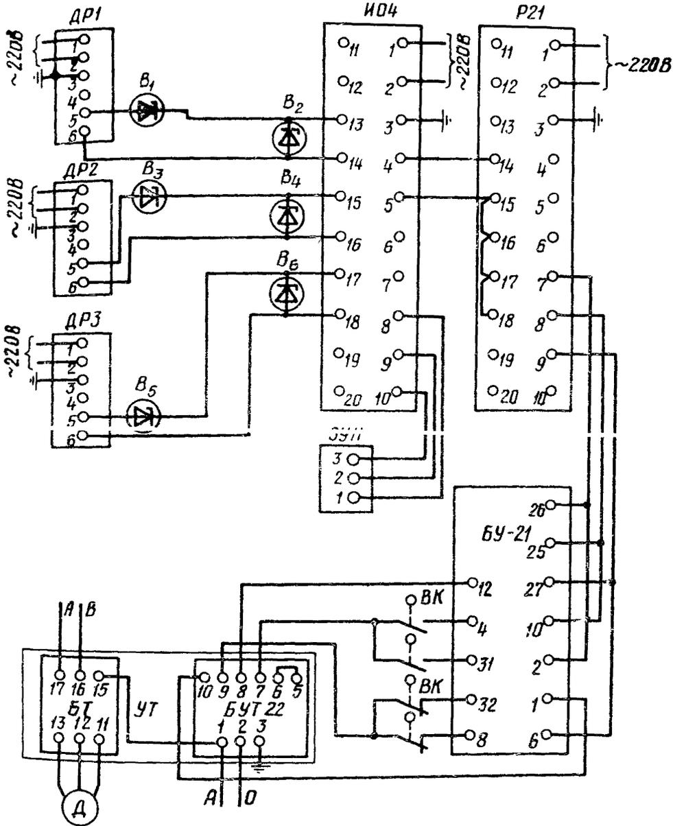
Рис. III.2. Реализация АСР питания на аппаратуре "Каскад"
