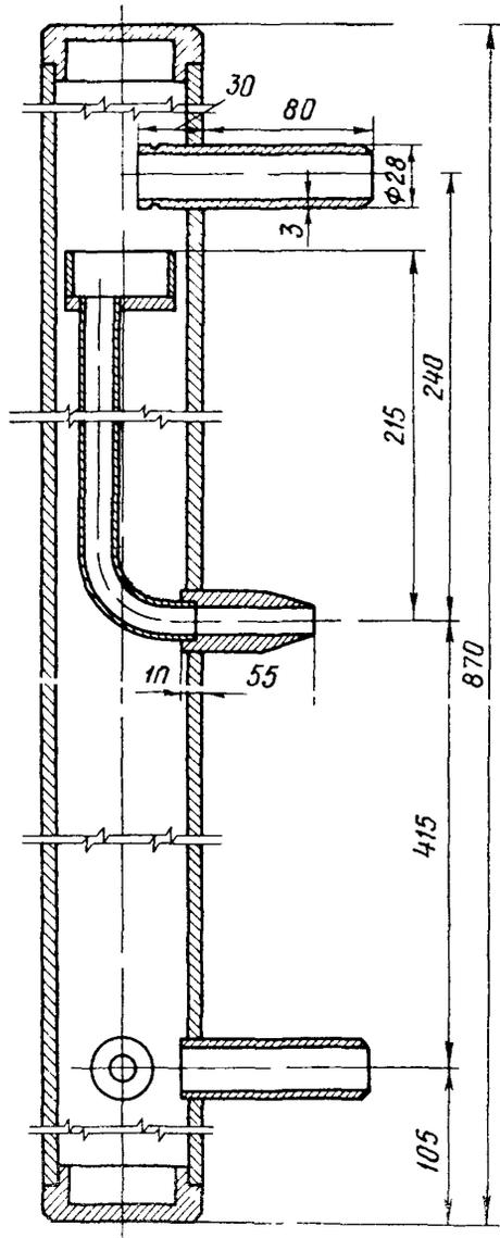
Рис. I.4. Уравнительный сосуд конструкции Варнаульского котельного завода
