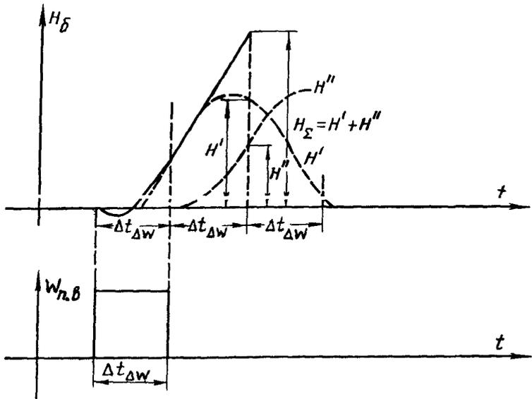
Рис. 1.2. Обработка кривой разгона при импульсном возмущении
