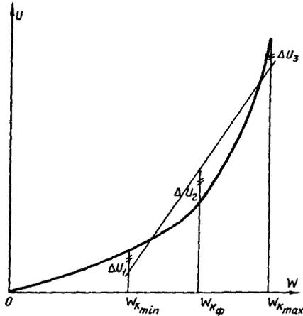
Рис. 2.2. Линейзация характеристики измерительного преобразователя по методу секущей
