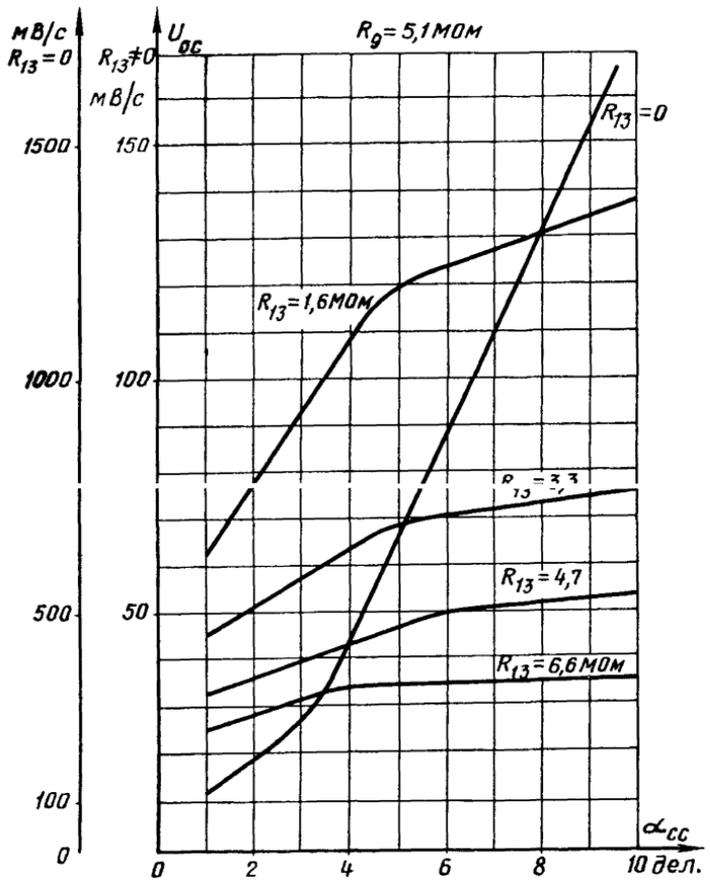
Рис. 3.3. Графики реализации расчетного коэффициента передачи регуляторов аппаратуры РПИБ
