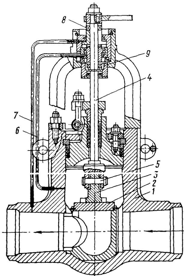
Рис. 1.6. Регулирующий питательный клапан конструкции ПП
