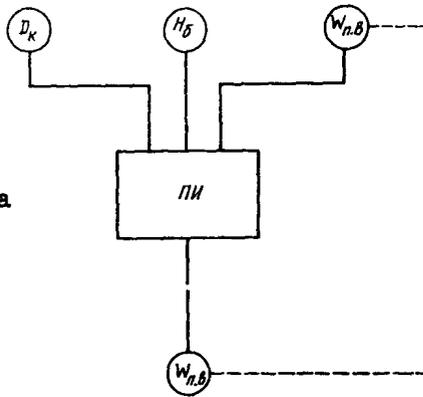
Рис. 1.3. Структурная схема тепловой трехимпульсной АСР питания
