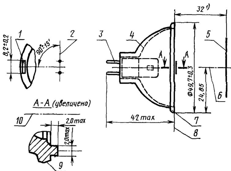
1—относительный выступ; 2—плоскость штырьков; 3—штырек; 4—зеркальный слой; 5—кадровое окно; 6—оптическая ось проектора; 7—точка крепления в проекторе; 8—относительная плоскость; 9—косое сечение; 10—ось зеркала.
