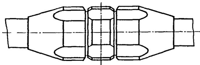
Рис. 6.9. Конструкция соединителя СКП 2,7/28,6 и его основные размеры
