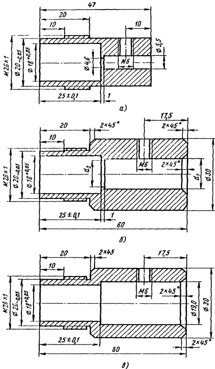
Рис. 2.1. Корпус разъема. Материал – латунь:
