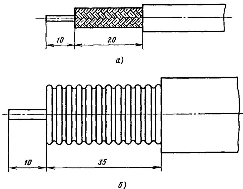
Рис. 2.5. Разделка концов кабелей для армирования разъемами:
