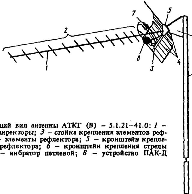
Рис. 4.4. Общий вид антенны АТКГ (В) – 5.1.21–41.0: 1 – стрела; 2 – директоры; 3 – стойка крепления элементов рефлектора; 4 – элементы рефлектора; 5 – кронштейн крепления стойки рефлектора; 6 – кронштейн крепления стрелы к мачте; 7 – вибратор петлевой; 8 – устройство ПАК-Д
