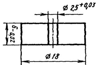
Рис. 2.3. Шайба. Материал – фторопласт-4 или полиэтилен
