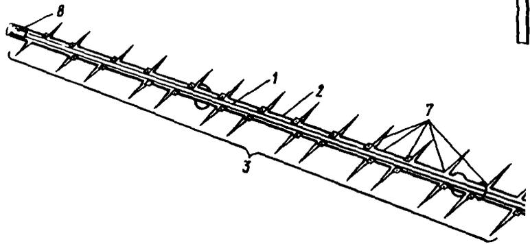
Рис. 4.5. Общий вид логопериодической антенны IV, V ТВ диапазонов: 1 – стрела верхняя; 2 – стрела нижняя; 3 – вибраторы; 4 – кронштейн крепления антенны к мачте; 5 – кабель снижения; 6 – мачта; 7 – обойма (винтовой зажим); 8 – пластмассовая коробка
