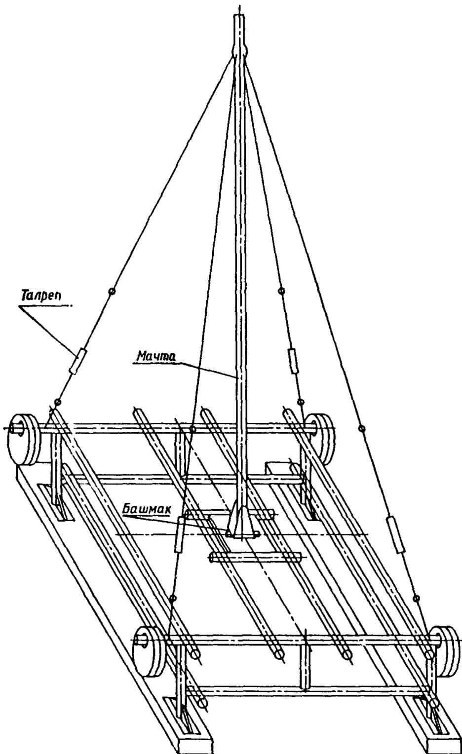
**Рис. 4.3. Передвижная конструкция крепления мачты**
