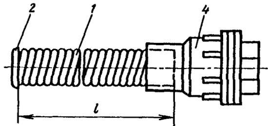
Рис. 6.5. Примеры заготовки металлорукавов для защиты кабеля: 1 – металлорукавов типа РЗ-Ц-Х; 2 – втулка типа ВО; 3 – соединитель „металлорукав-труба” типа СМТ; 4 – соединитель „металлорукав-короб” типа СМК.  $l$  – длина металлорукава, определяемая по длине участка, на котором он должен устанавливаться
