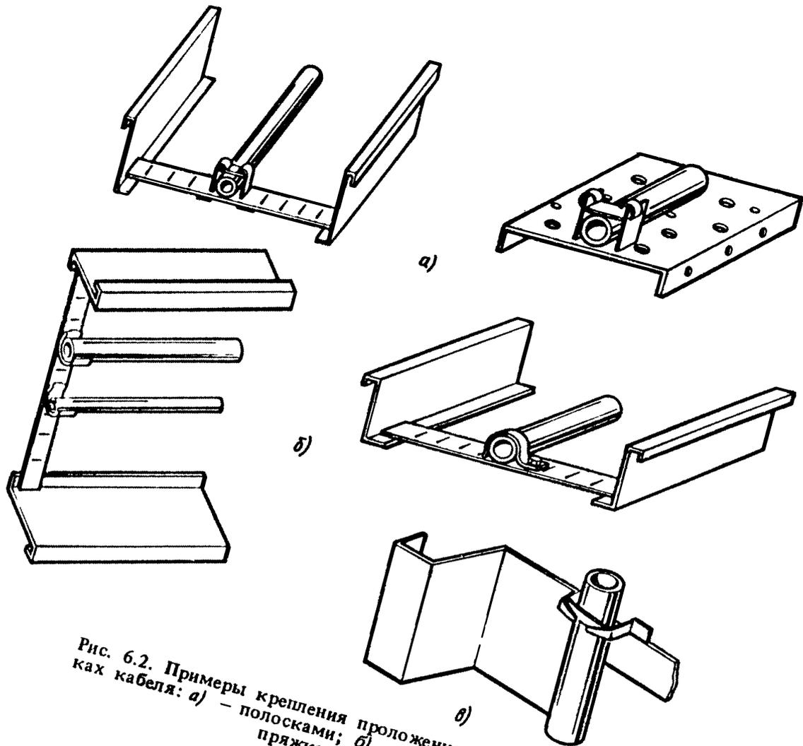
Рис. 6.2. Примеры крепления проложенного в лотках кабеля: а) — полосками; б) — скобами; в) — пряжками
