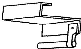
Рис. 6.3. Пример крепления кабеля на стальных подвесках
