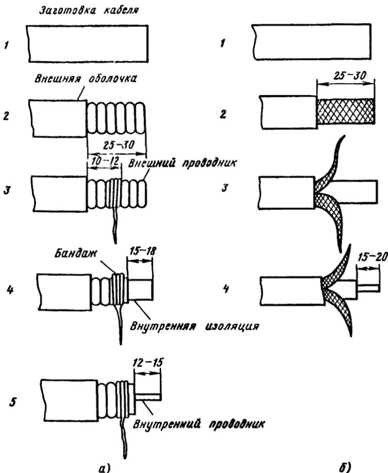
Рис. 8.3. Последовательность операций по разделке кабелей:
