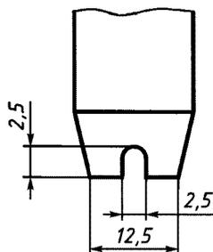
Рисунок 14 — Конец вырубного ножа с выемкой
