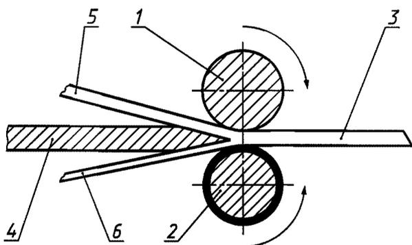
Ролик 1 — стальной, с проточками, ролик 2 — стальной обрешиненный. Ролики подают полосу 3 на острый стационарно закрепленный или способный перемещаться нож 4 (типа хирургического скальпеля). Полосу режут вдоль на две части: часть 5, из которой вырезают образцы, и часть 6, которая идет в отходы
