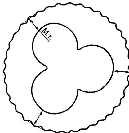
Рисунок 9 — Измерение толщины оболочки (наружная поверхность неправильной формы)
