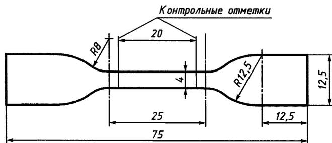
Рисунок 12 — Образец в виде двусторонней лопатки
