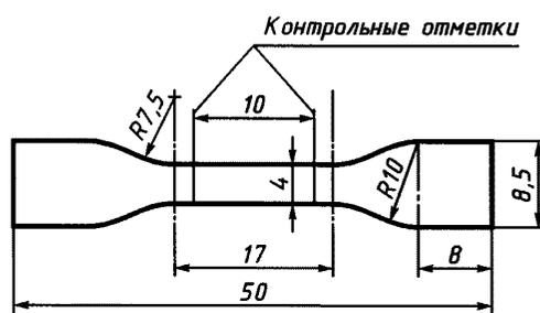
Рисунок 13 — Образец в виде двусторонней лопатки уменьшенного размера
