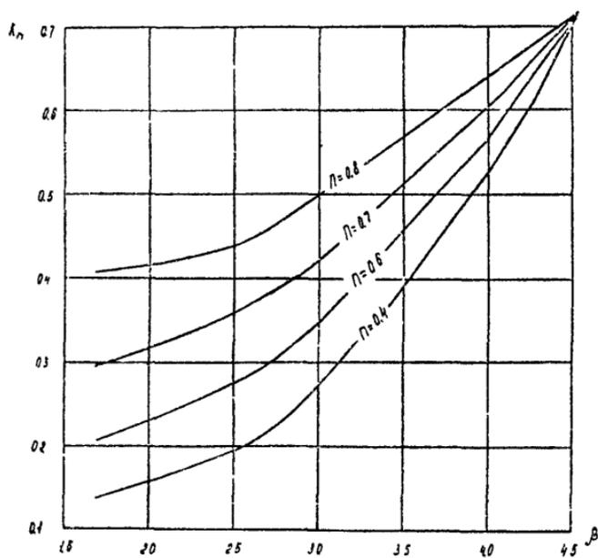
Рис 33. График для определения коэффициента  $k_n$
