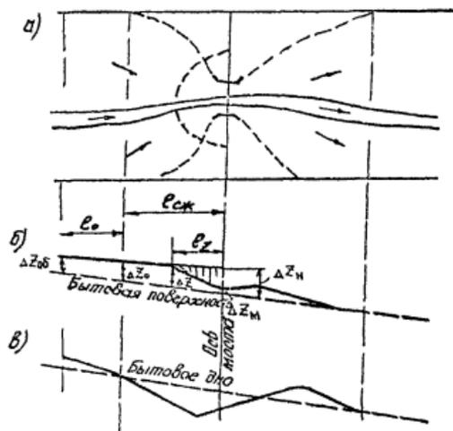
Рис.6.1. Схема к определению характерных подтопов на мостовом переходе:
