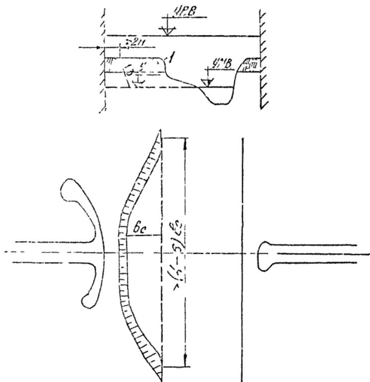
Рис.3.1 Очертание среза в поперечном сечении в плане.
