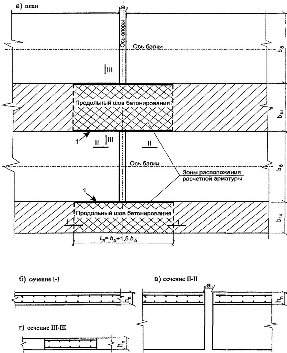
**Рис. 4. Схема объединения пролетных строений по продольным швам бетонирования:**
