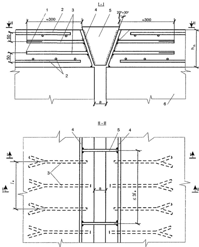
**Рис. 6. Схема объединения пролетных строений с помощью шпонок:**
