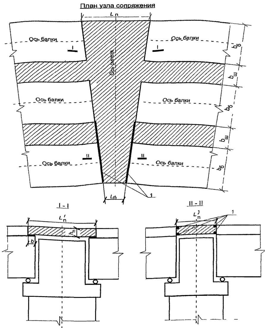
**Рис. 9. Схема сопряжения пролетных строений, расположенных на кривой в плане при опорах с ригелем таврового сечения:**
