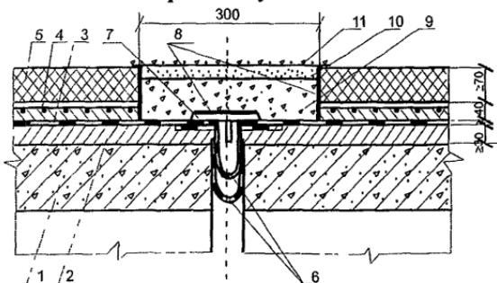
**Рис. 24. Конструкция деформационного шва над узлами шарнирного сопряжения типа «Торма® Джойнт»:**
