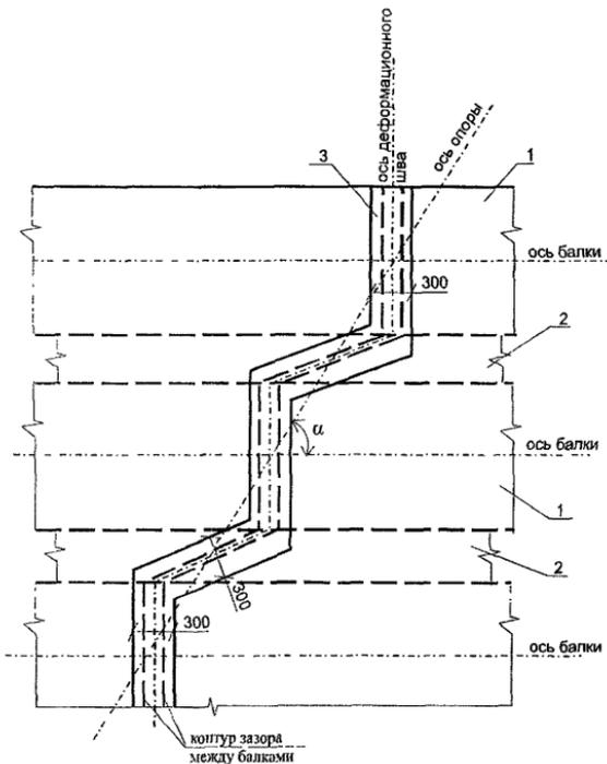
**Рис. 25. Устройство конструкции деформационного шва типа «Торма® Джойнт» в косом пролетном строении:**
