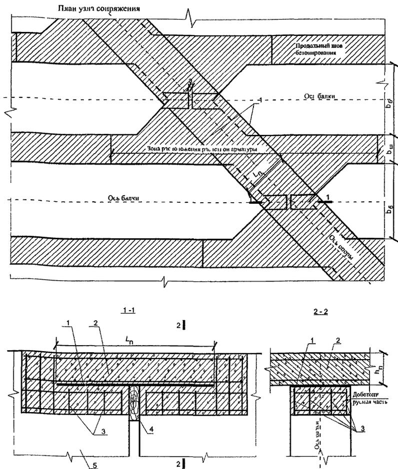
**Рис. 10. Объединение пролетных строений по плите проезжей части при использовании типовых косых балок:**
