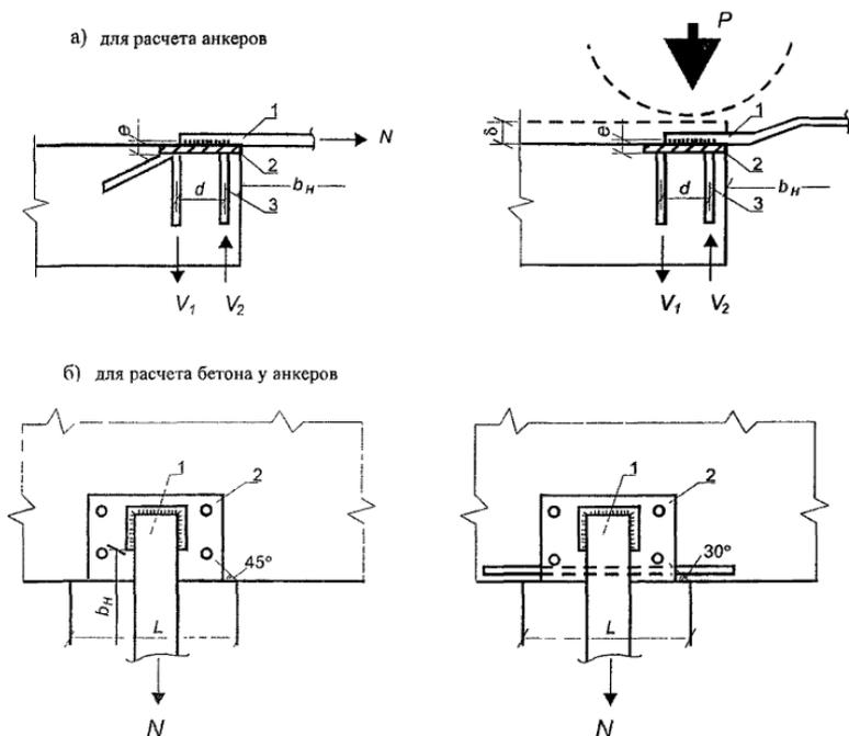
**Рис. 21. Схемы к расчету закладных деталей:**
