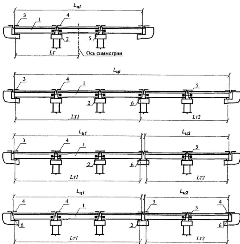
**Рис. 1, а.** Принципиальная схема образования температурно-неразрезных цепей с помощью металлических тяг:
