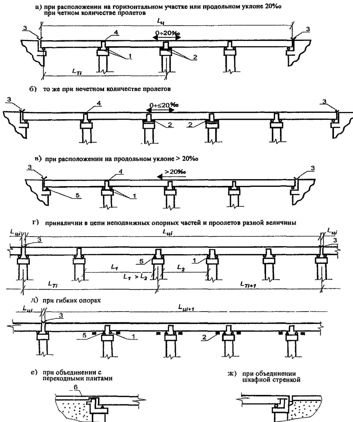
**Рис. 1. Схемы компоновки пролетных строений:**
