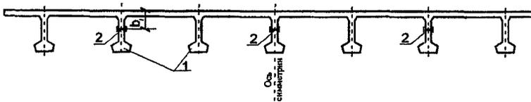
**Рис. 12. Расположение тяг в поперечном сечении пролетного строения:**
