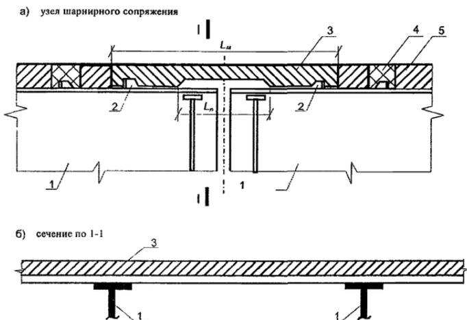
**Рис. 17. Объединение сталежелезобетонных пролетных строений по монолитному участку плиты при удалении продольных втул:**
