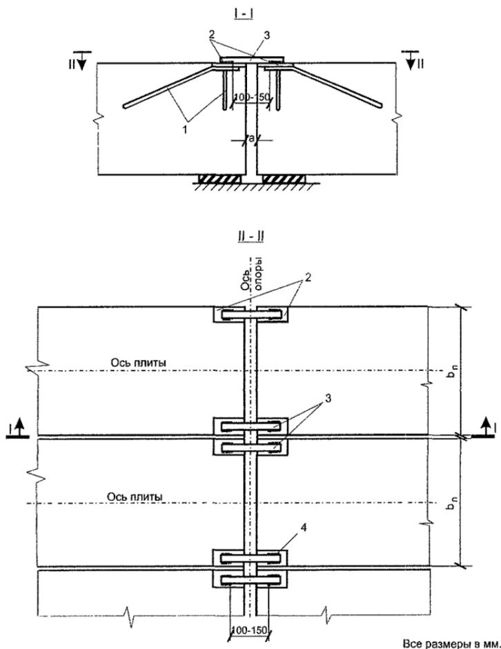
**Рис. 5. Схема объединения пролетных строений по стыковым накладкам:**
