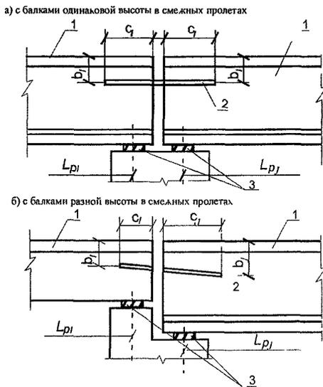
**Рис. 13. Объединение пролетных строений тягами в надопорных зонах:**
