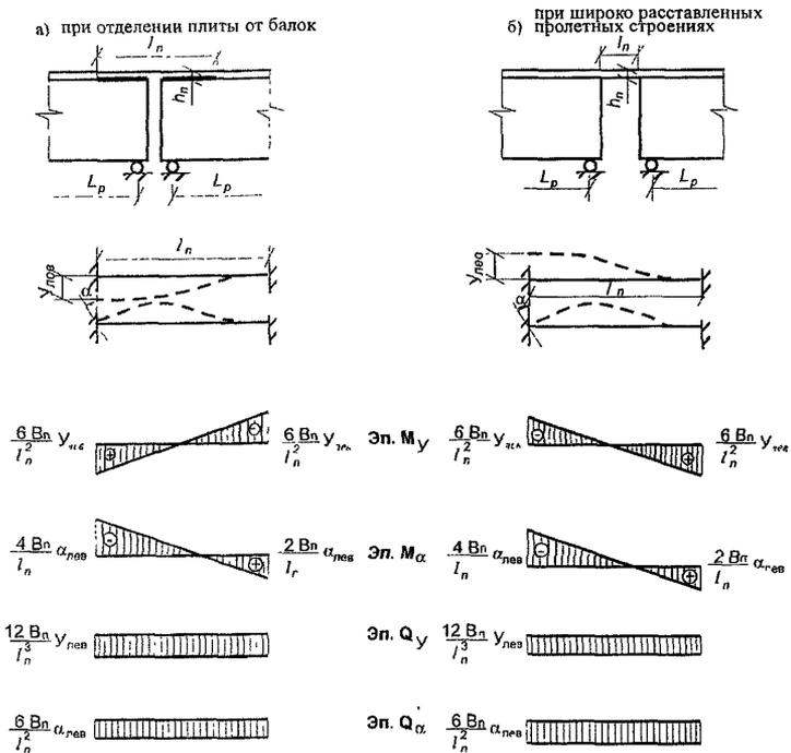
**Рис. 20. Схема для расчета соединительной плиты на воздействия перемещений ее опорных частей:**
