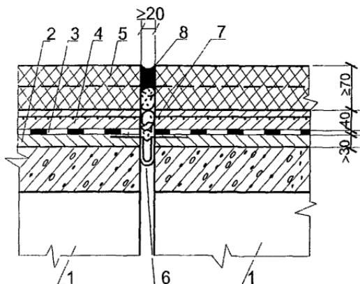
**Рис. 23. Конструкция деформационного шва над узлом шарнирного сопряжения с заполнением мастикой:**
