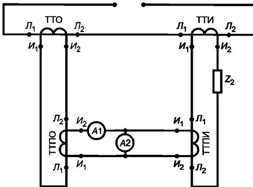
ТТО — образцовый трансформатор тока; ТТИ — испытуемый трансформатор тока; ТТПИ — промежуточный трансформатор тока, находящийся в цепи испытуемого трансформатора тока; ТТПО — промежуточный трансформатор тока, находящийся в цепи образцового трансформатора тока;  $A1, A2$  — амперметры;  $Z_2$  — вторичная нагрузка в цепи испытуемого трансформатора тока
