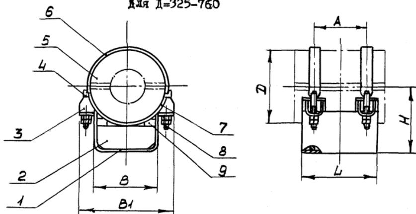
I-корпус; 2-ребро; 3-проушина; 4-шпилька; 5-скорлупа (ОСТ.....);
