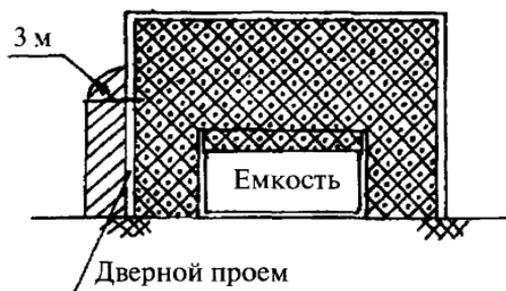
**Рис. 1.** Открытые емкости, аппараты, устройства в закрытом помещении
