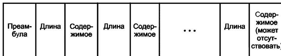
Рисунок 2 — Кодирование значения длинных данных
